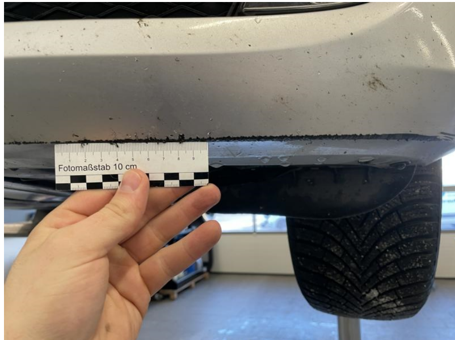
Stoßfänger vorne verschrammt mit Materialabtrag
