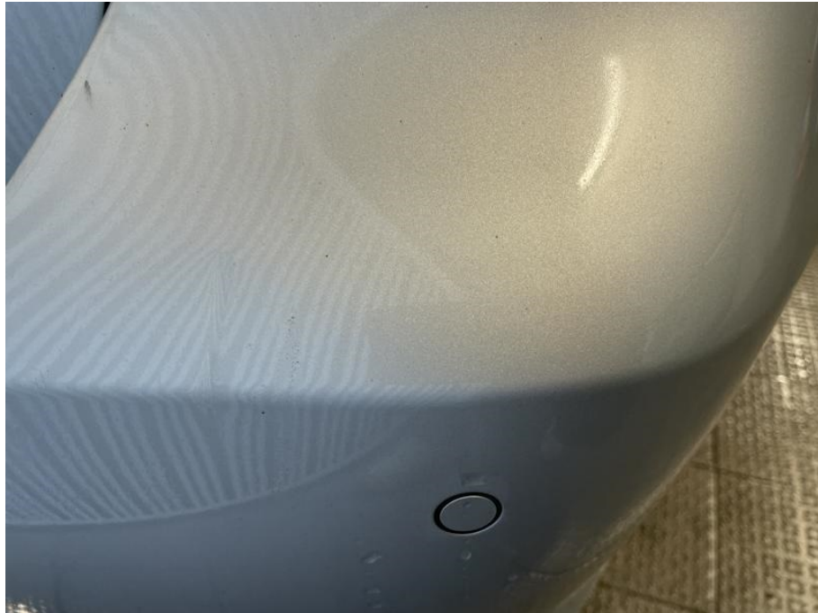
Stoßfänger hinten plastisch verformt
