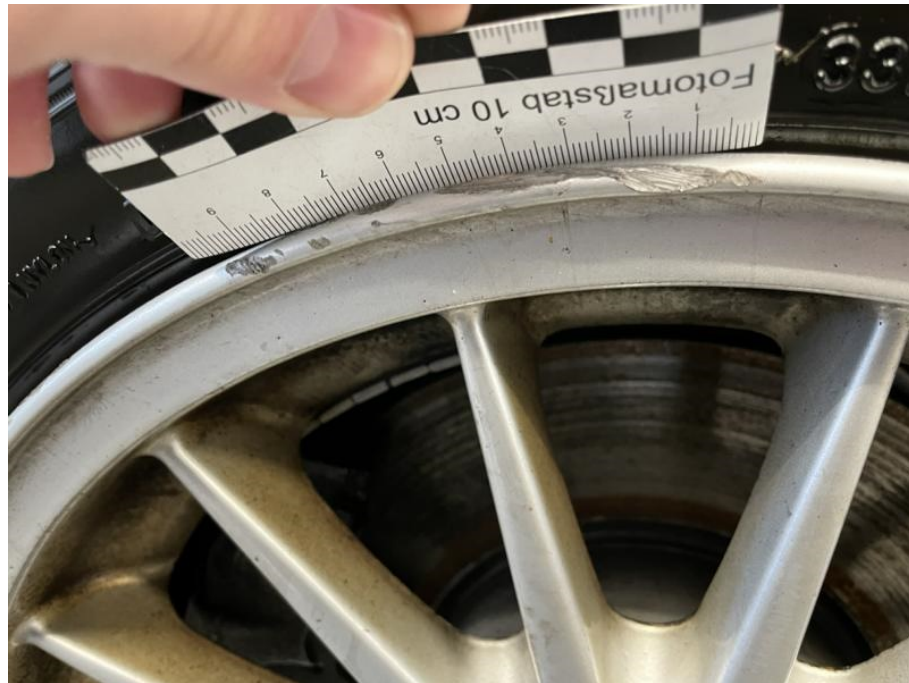
Rad vorne rechts verschrammt mit Materialabtrag
