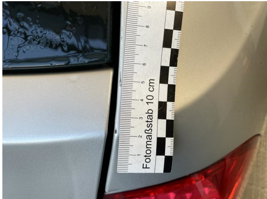
Seitenteil rechts verschrammt
