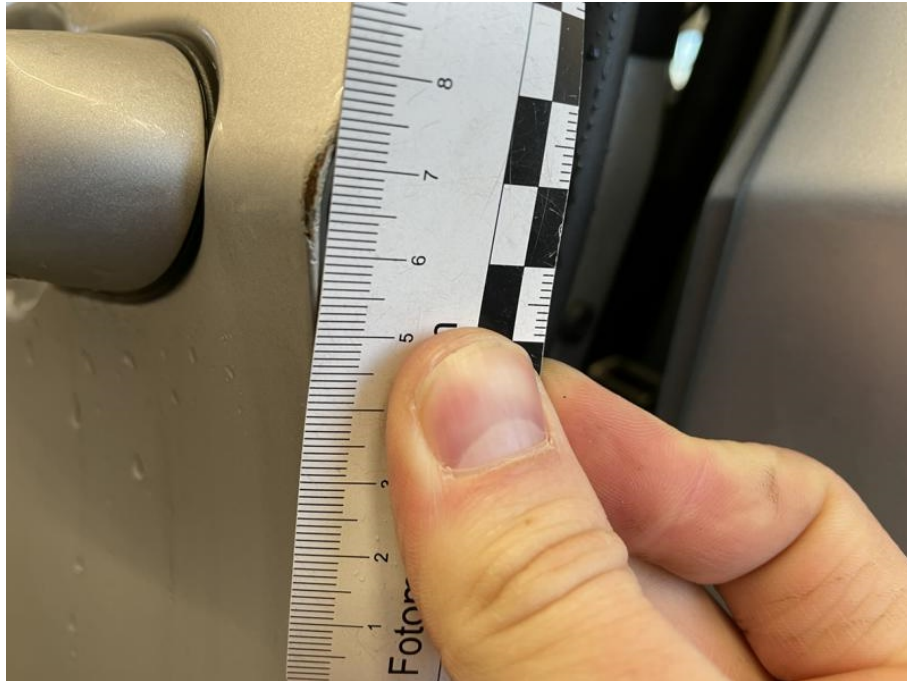
Türe vorne links Lackabplatzung mit Unterrostung
