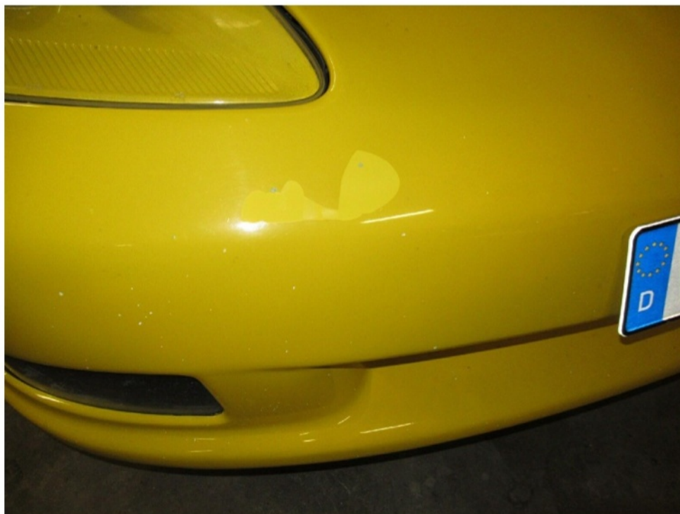
Bild 6 : Stoßfänger vorn Lackabplatzungen
