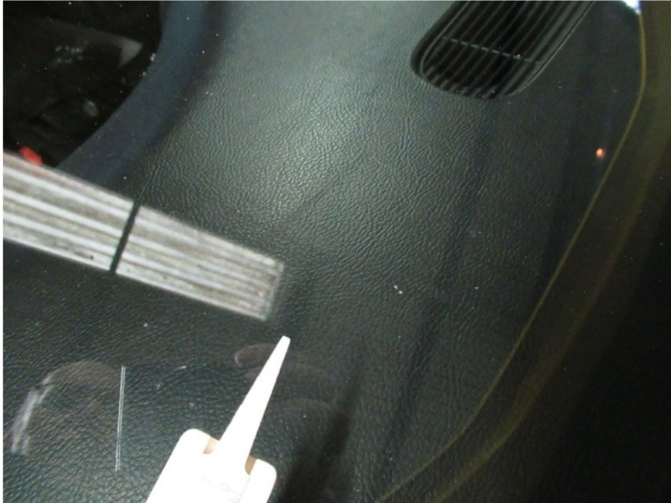
Bild 11 : Frontscheibe diverse Oberflächenabplatzungen
