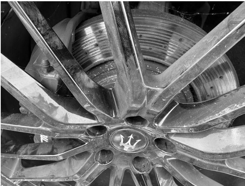
Foto 14: Bremsscheiben an der Verschleißgrenze
