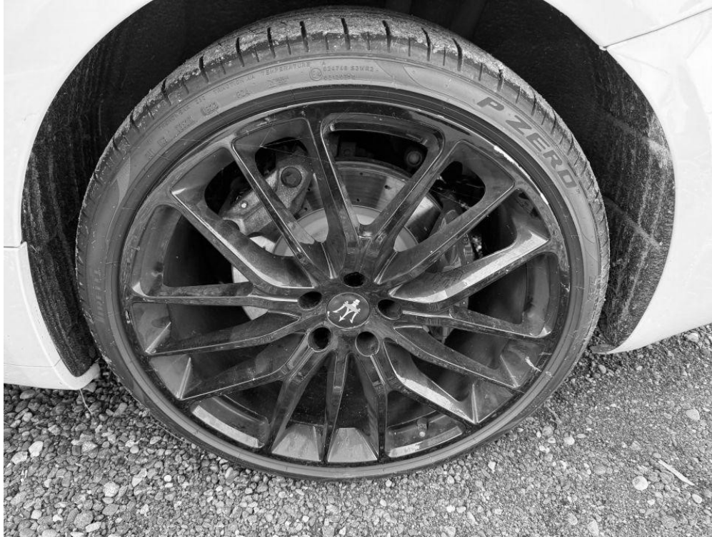
Foto 17: Felge hinten links verschrammt
