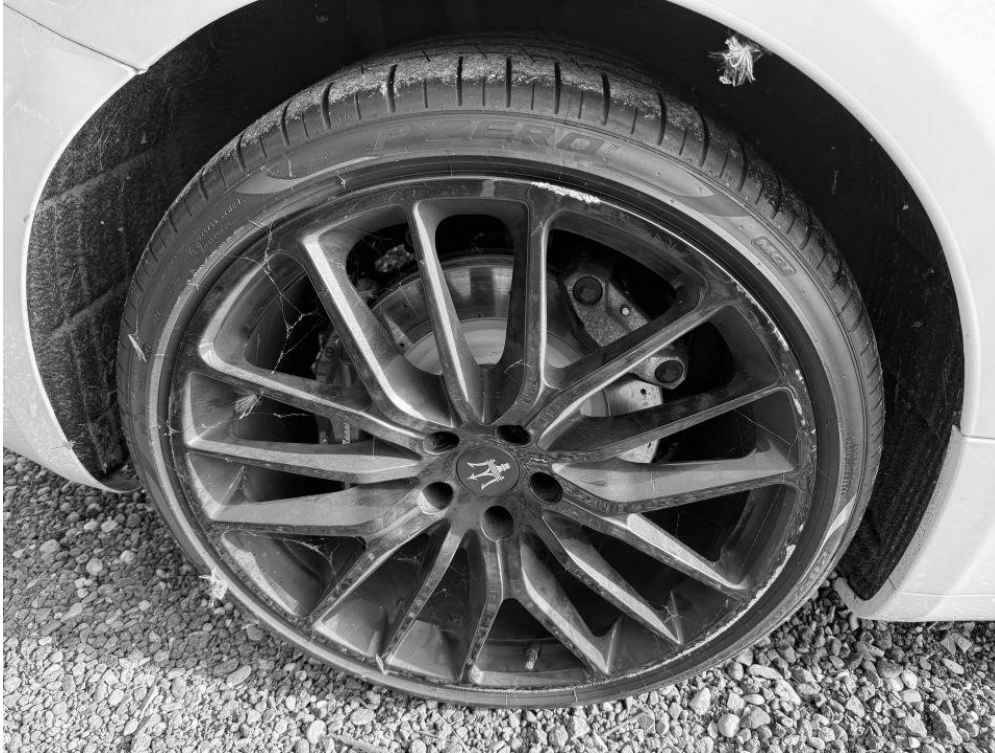
Foto 15: Felge hinten rechts verschrammt
