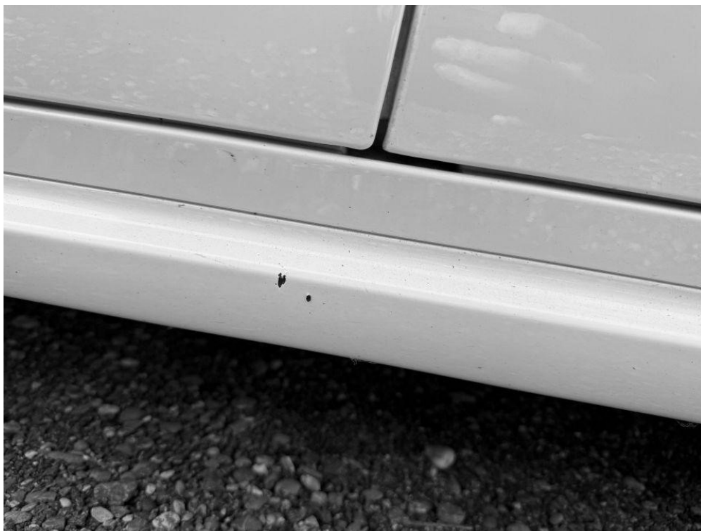
Foto 18: Schwellerverkleidung links Lackbeschädigung
