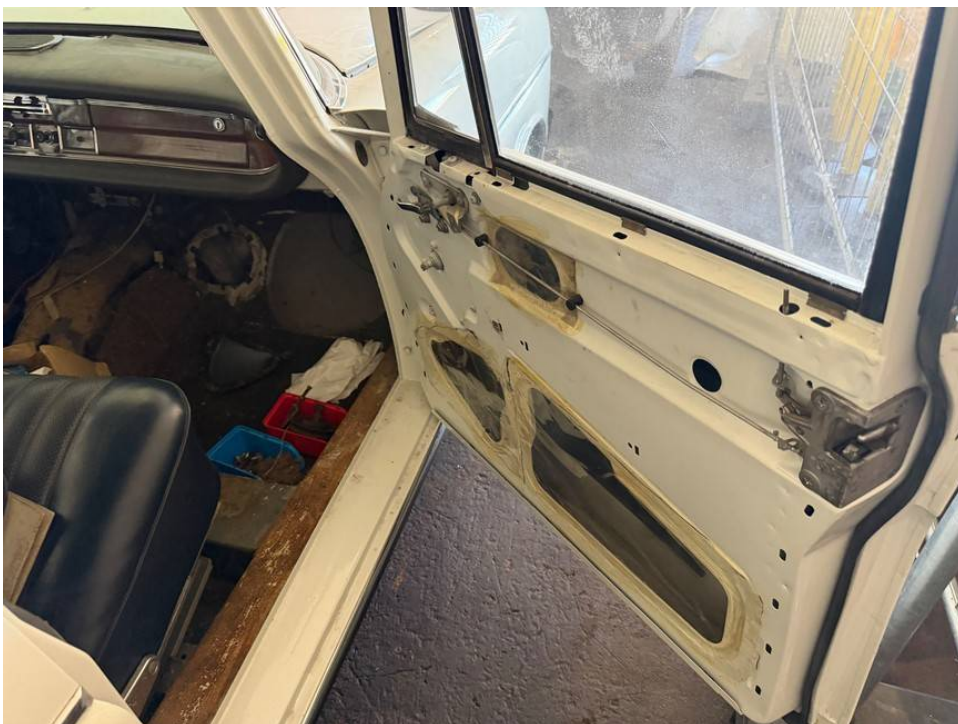
Türverkleidung vorne rechts nicht montiert, unvollständig und teilweise beschädigt
