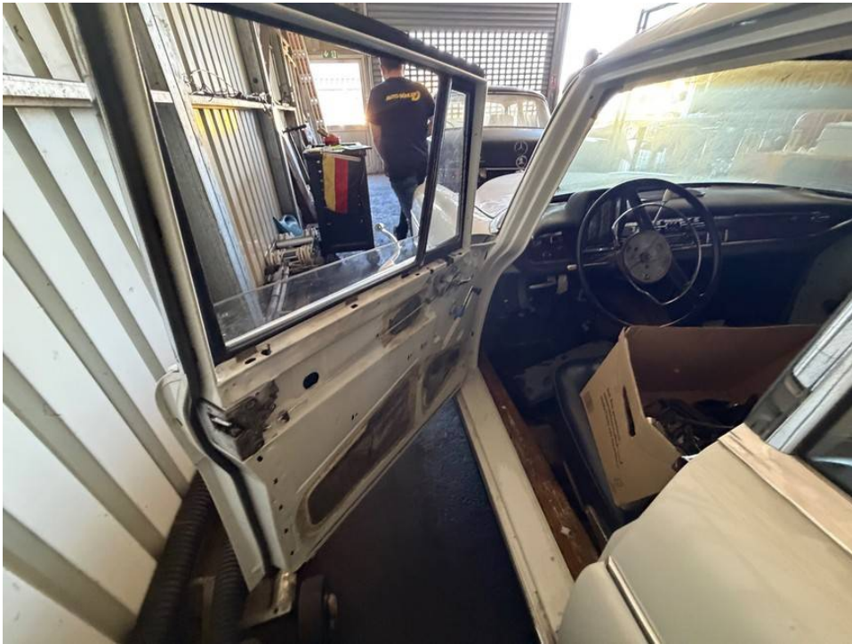
Türverkleidung vorne links nicht montiert, unvollständig und teilweise beschädigt
