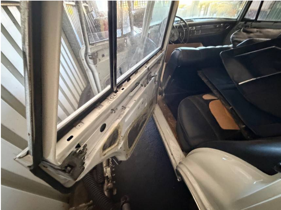
Türverkleidung hinten links nicht montiert, unvollständig und teilweise beschädigt
