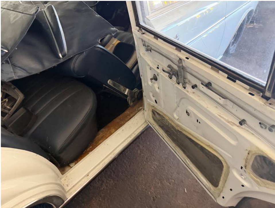
Türverkleidung hinten rechts nicht montiert, unvollständig und teilweise beschädigt
