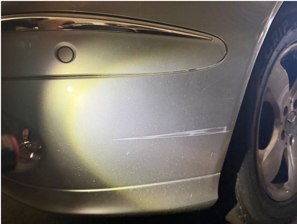
Lackkratzer Stoßfänger vorne links
