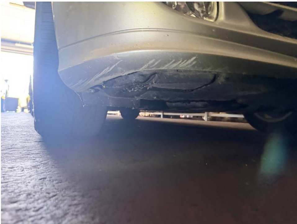
Lackkratzer Stoßfänger vorne links und rechts unterhalb
