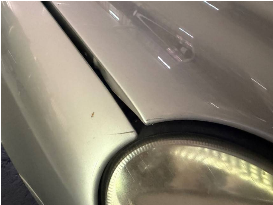
Kratzer Kotflügel und Motorhaube
