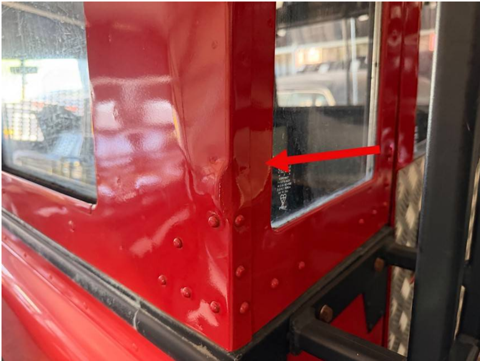
Hardtop beschädigt links hinten
