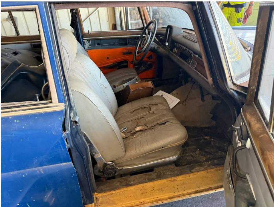
Beifahrersitz stark beschädigt
