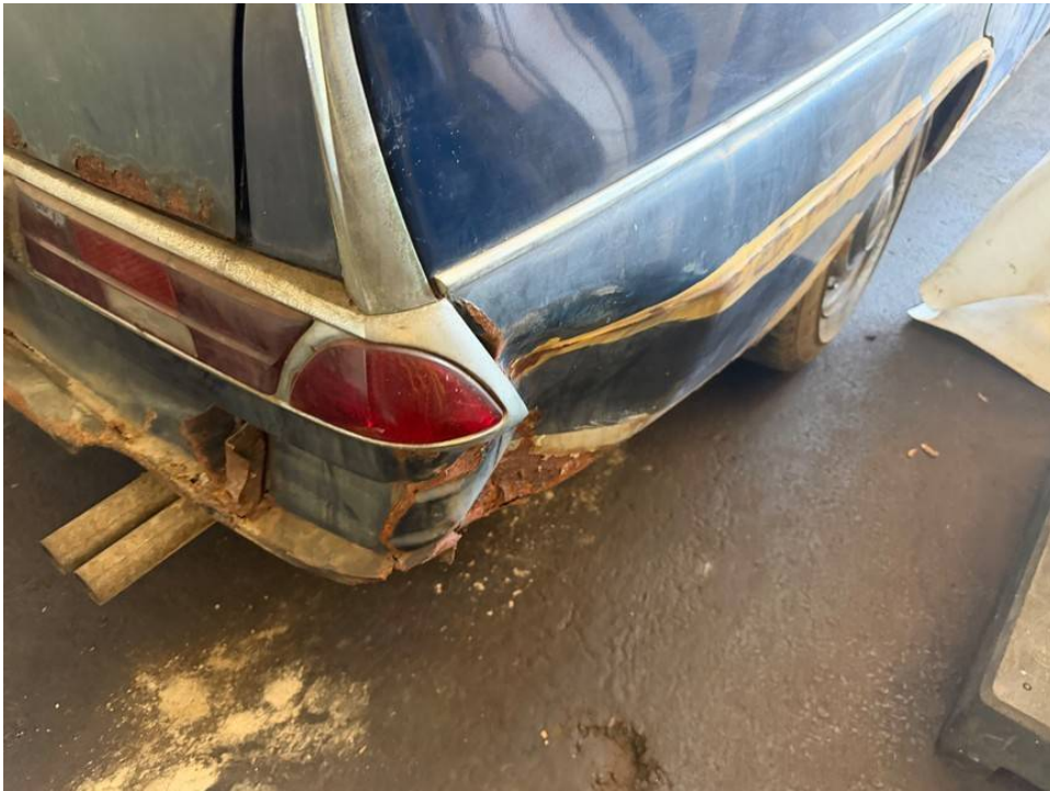
Seitenwand rechts unterhalb eingedrückt
