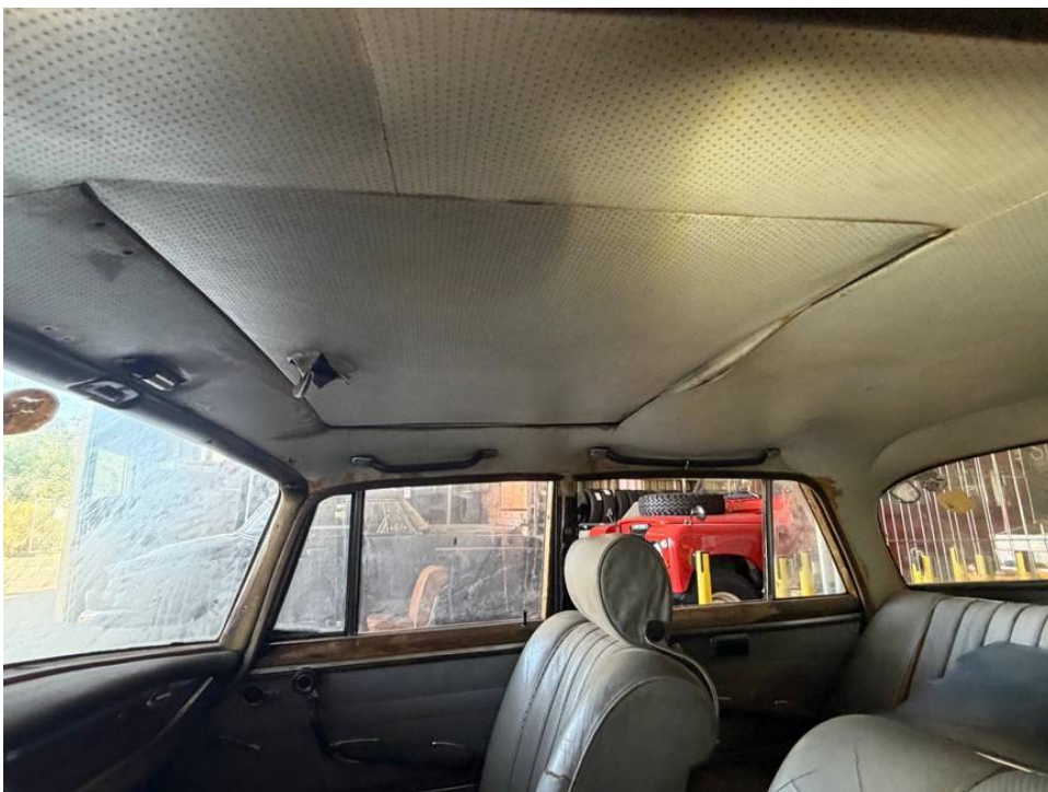
Schiebedach defekt, Dachhimmel beschädigt
