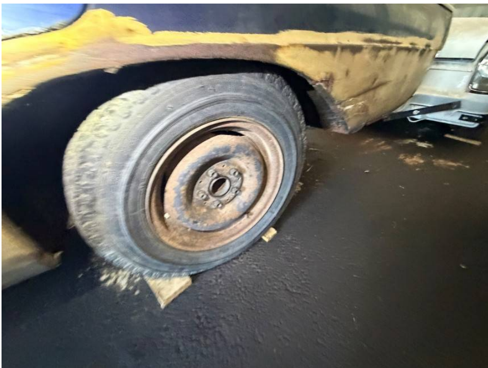
Seitenwand links unterhalb korrodiert
