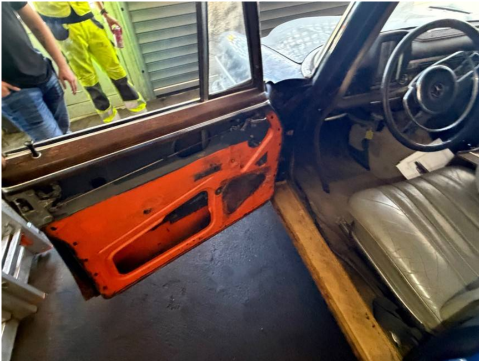
Fahrertür Türverkleidung fehlt
