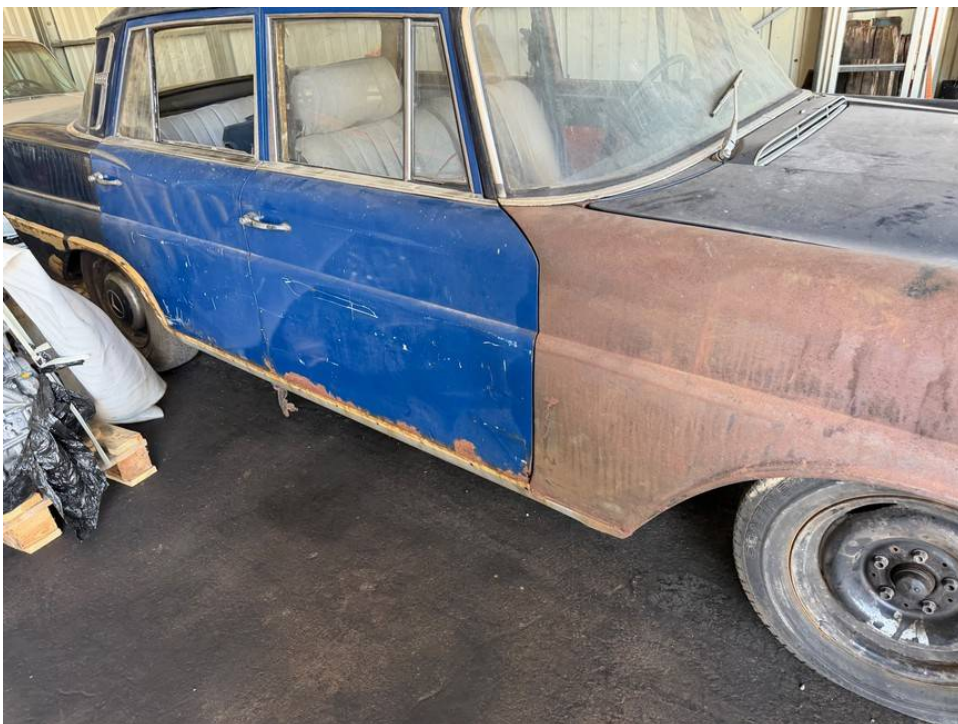
rechte Türkanten und Kante rechter Radlauf korrodiert
