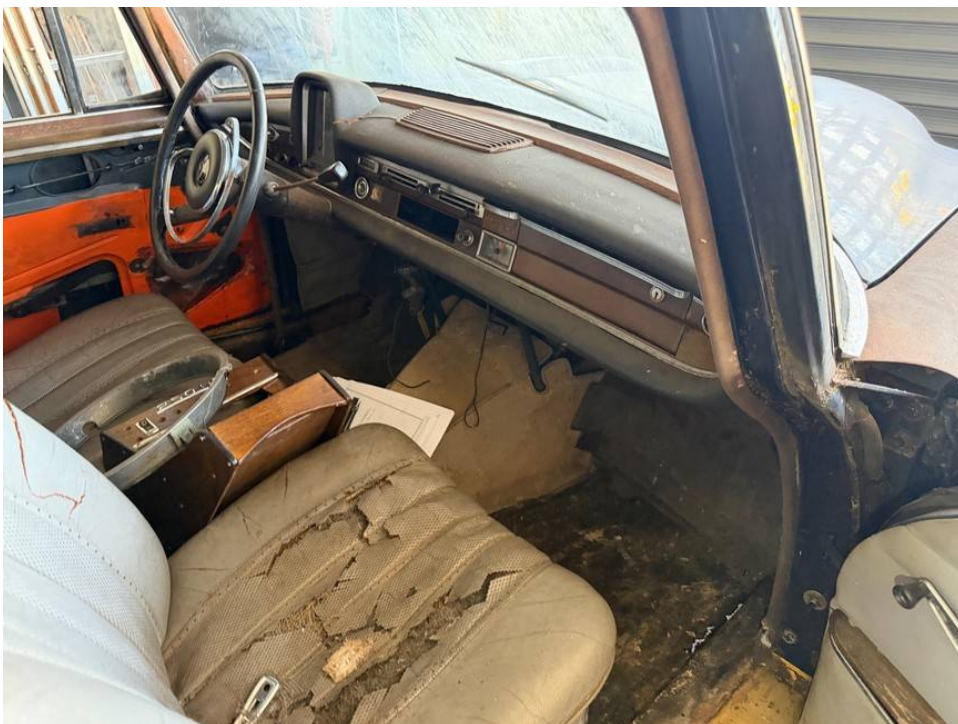
Innenraum vorne Teppich fehlt und Radio nicht vorhanden, Armaturentafel beschädigt
