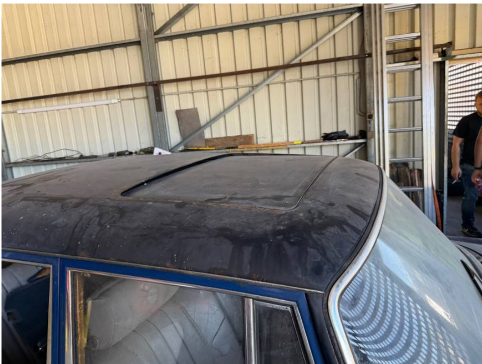
Schiebedach defekt Fahrzeugdach korrodiert
