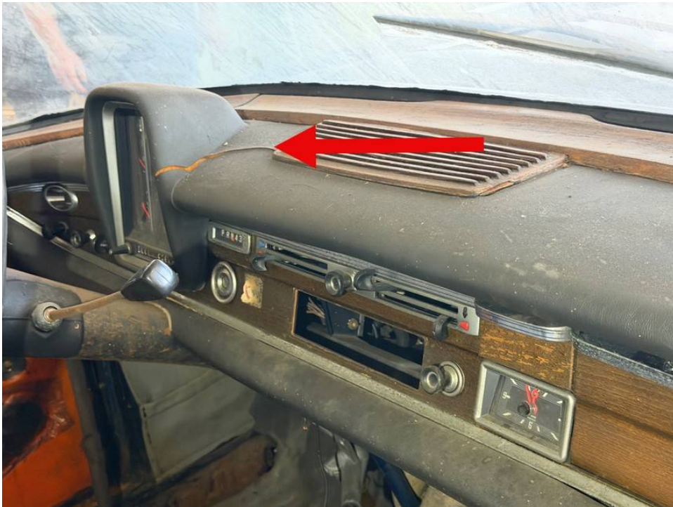
Armaturentafel eingerissen, Zierteile verschlissen
