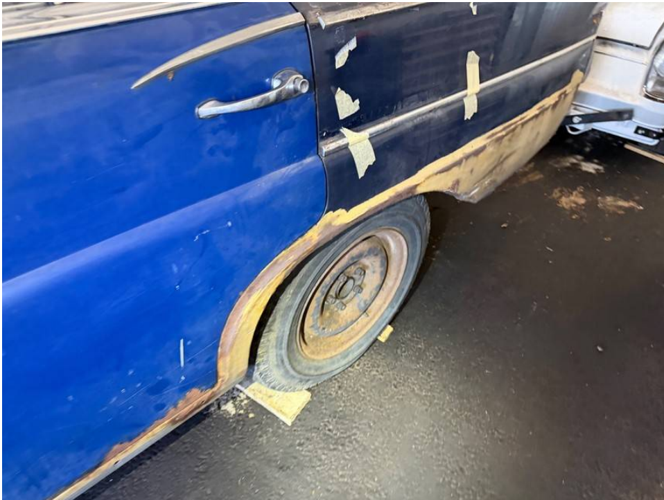
linke Türkante und Kante linker Radlauf korrodiert
