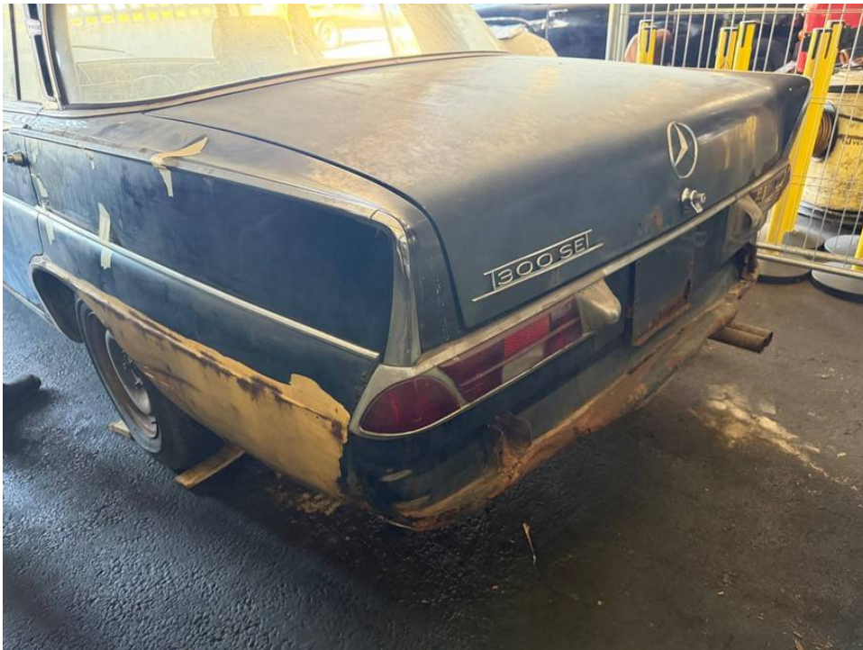
Abschlußblech und Seitenwand links unterhalb beschädigt
