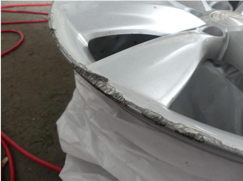
Bild: 66 Sämtliche LM-Felgen weisen massive Beschädigungen auf
