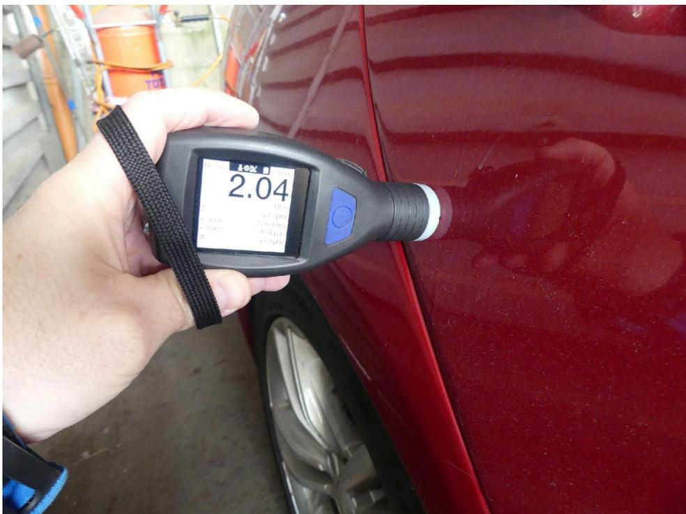
Bild: 75 ... bis  $2.040\mu\text{m} = 2,040\text{ mm}$  feststellbar
