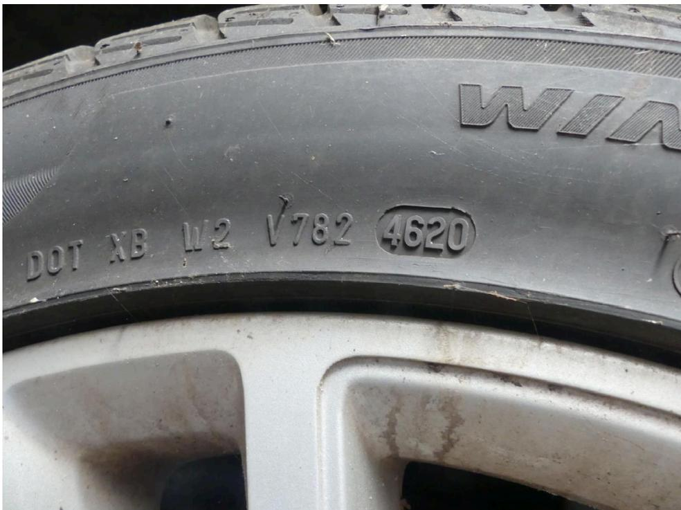
Bild: 49 Ausweisung der DOT Nummer der Radialreifen
