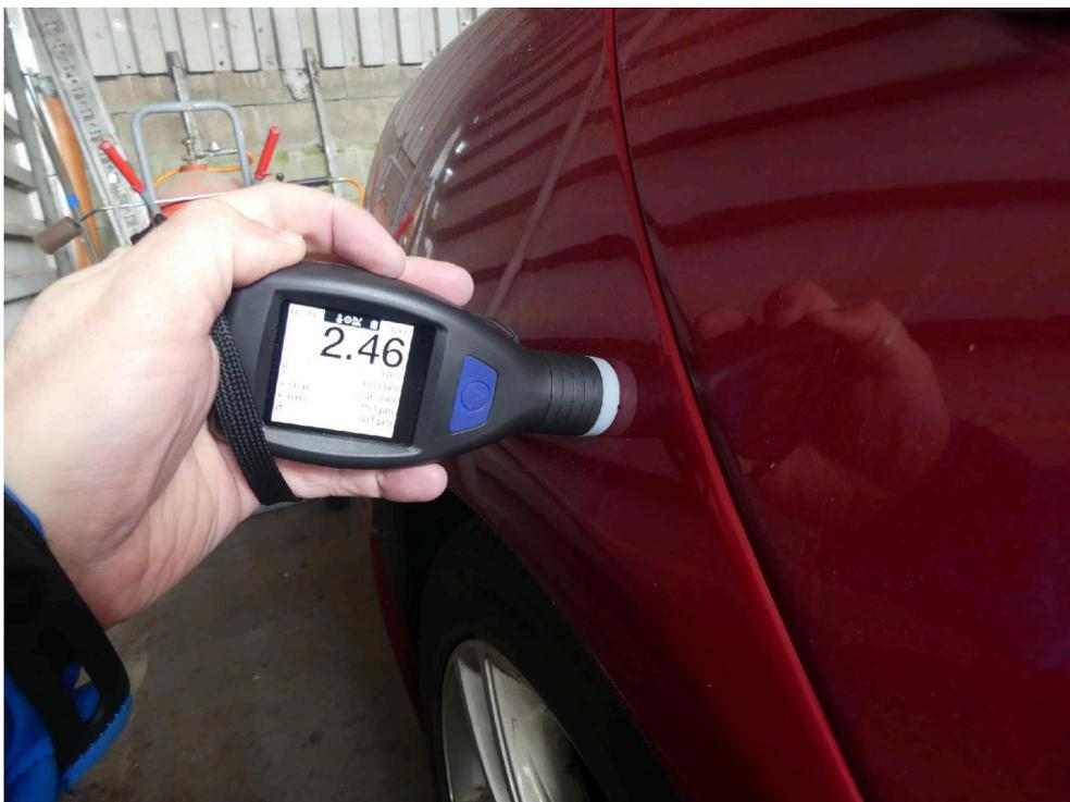
Bild: 77 Ausweisung Lackschichtdickenmessung der Baugruppe Seitenwand, eine Messwert von  $2.460\mu\text{m} = 2,460\text{mm}$  wurde sachverständigenseits festgestellt.
