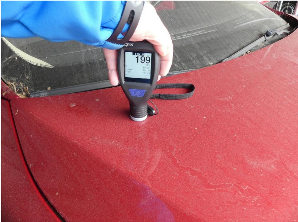
Bild: 56 Ausweisung Lackschichtdickenmessung vorgenommen, Messwerte dem beiliegenden Protokoll entnehmen.
