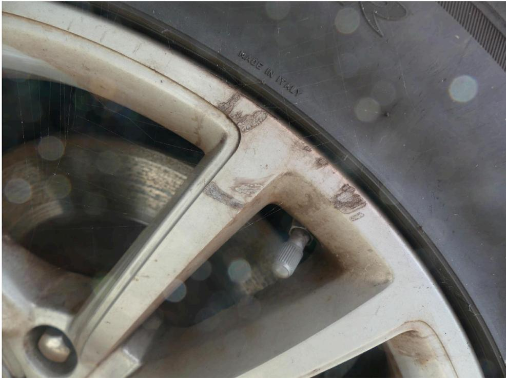
Bild: 54 Detailansicht, LM-Felge beschädigt.
