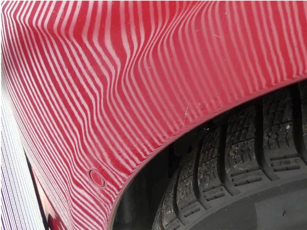
Bild: 82 Spotlackierung Frontverkleidung links vorhanden, nicht fachgerecht ausgeführt.
