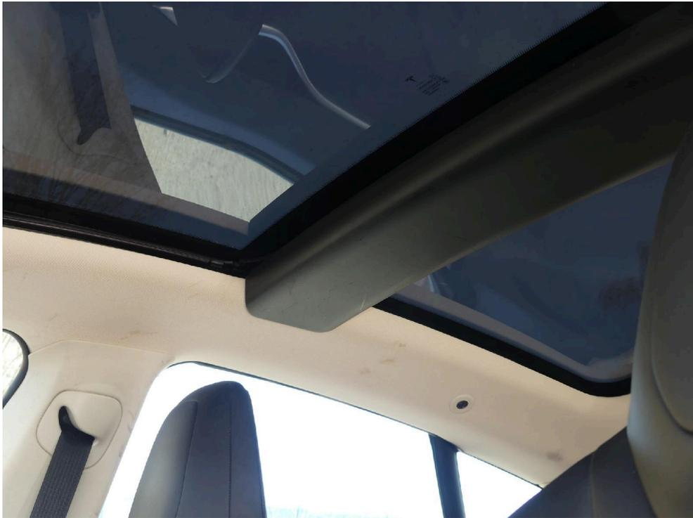
Bild: 25 Dachholmverkleidung verschmutzt
