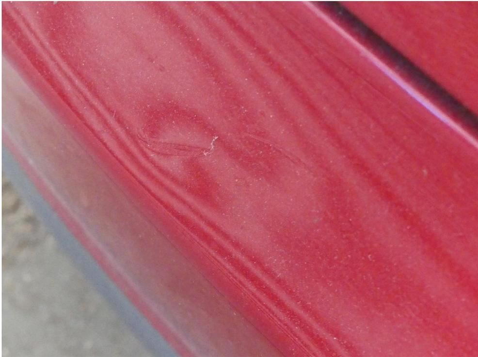
Bild: 92 Heckverkleidung sichtbar gestaucht.
