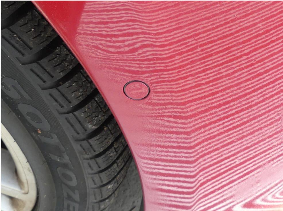
Bild: 88 Weitere Nachlackierung Frontverkleidung rechts vorhanden.
