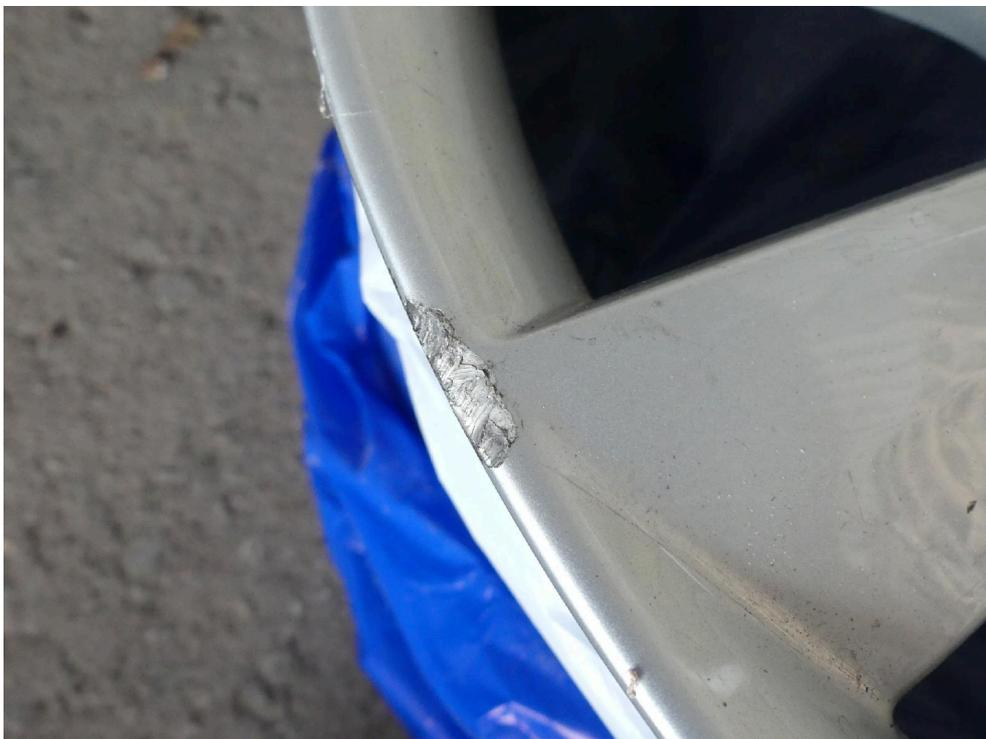
Bild: 71 ... Deformation am Felgenreand vorhanden.
