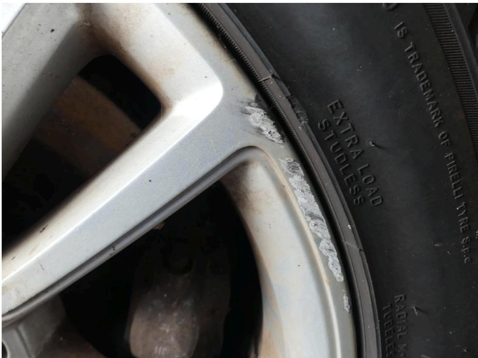
Bild: 51 Ansicht wie vor in geänderter Perspektive, LM-Felge beschädigt.
