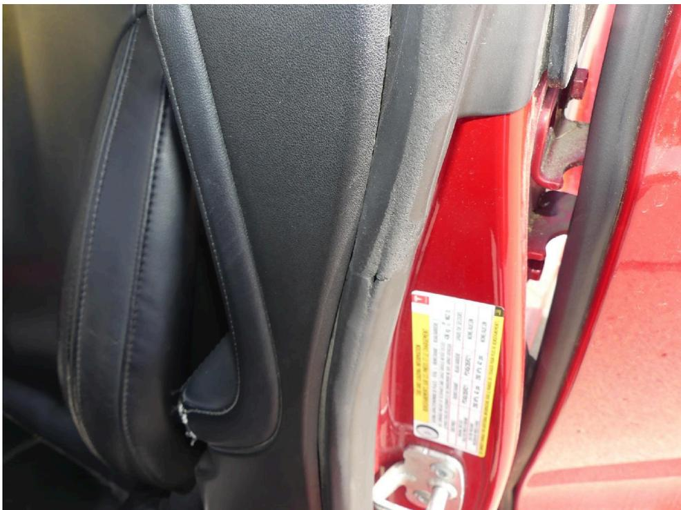
Bild: 28 Detailansicht Türdichtung vorn links, partieller Materialabtrag.
