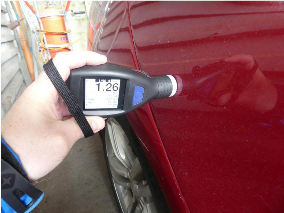
Bild: 74 Ansicht Fondtür rechts, hierbei ist eine Lackschichtdicke von  $1.260\mu\text{m} = 1,260\text{ mm}$  ....
