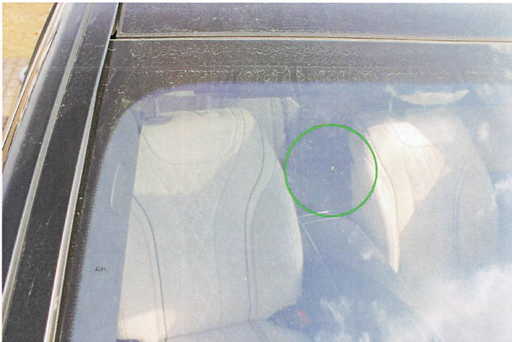
Steinschlag im Sichtfeld
