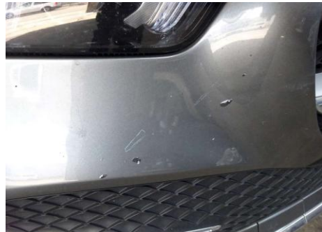
Stoßfänger vorne verschürft
