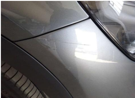
Stoßfänger vorne verschürft
