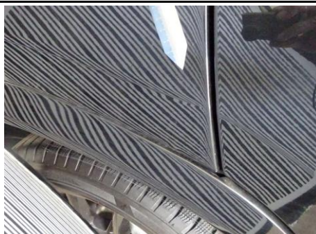
Seitenwand hi rechts n. fachger. Instandgesetzt
