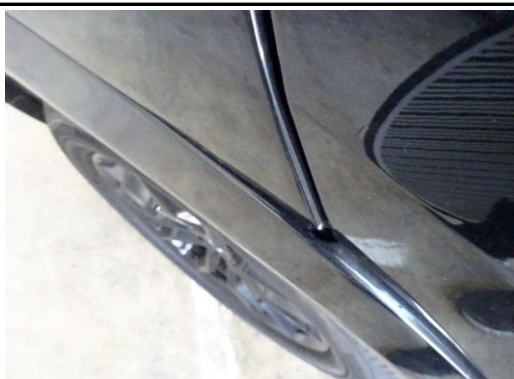
Seitenwand hi rechts n. fachger. Instandgesetzt
