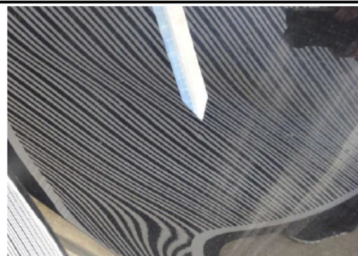
Tür hinten rechts Delle, Lackschaden
