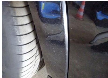
Radlaufblende rechts Steinschlag
