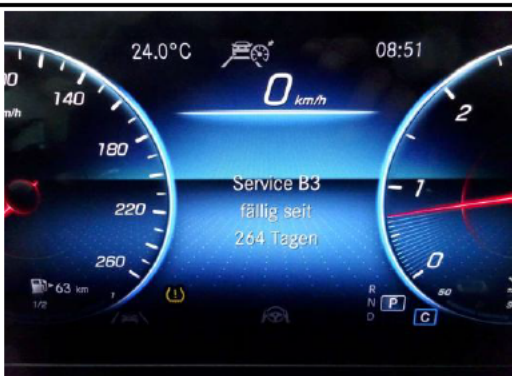
Wartung überfällig, RDKS Fehlermeldung
