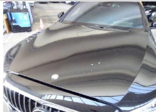
Motorhaube nicht fachgerecht instandgesetzt
