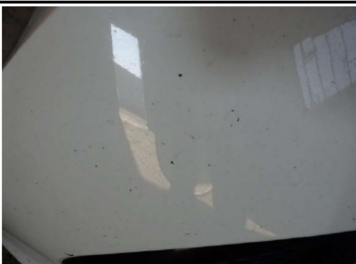
Stoßfänger vorne Steinschlag, Lackmangel
