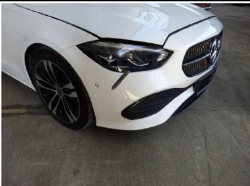
Stoßfänger vorne Steinschlag, Lackmangel
