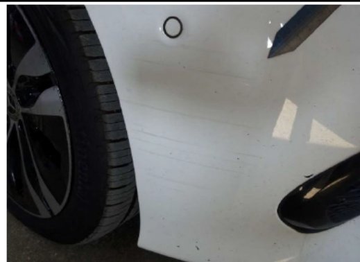
Stoßfänger vorne Steinschlag, Lackmangel
