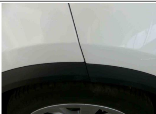
Tür hinten Spaltmaße
