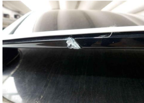
Zierleiste Spoiler Korrosion
