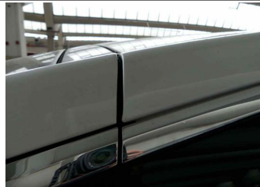
Tür hinten Spaltmaße
