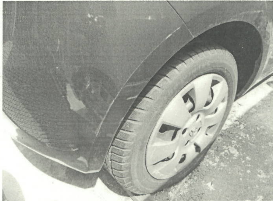
Schadenbereich Detail: Stoßfängerverkleidung hinten
