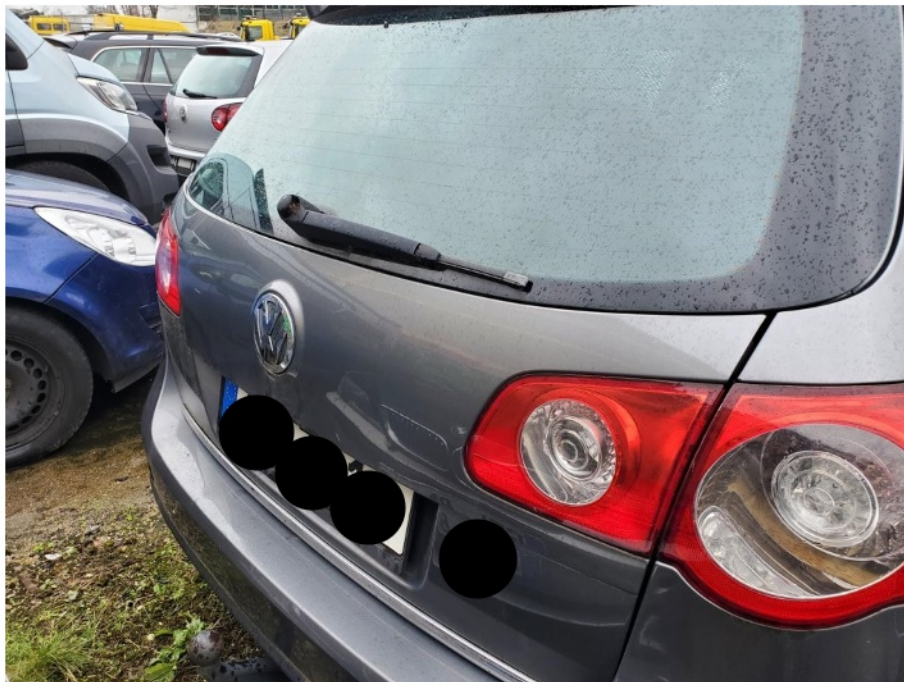
Schadenbereich: Die Heckklappe ist mehrfach eingedellt
