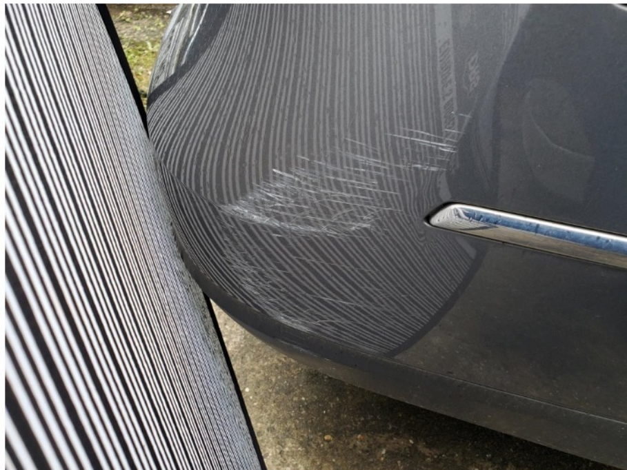
Schadenbereich: Die Stoßfängerverkleidung hinten ist deformiert
