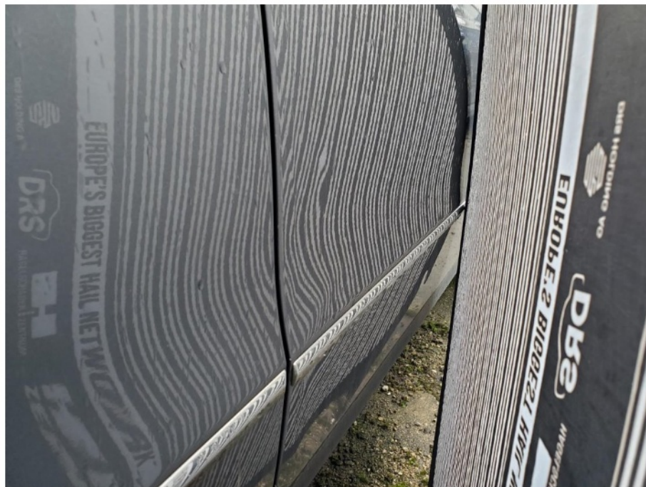
Schadenbereich: Die Tür vorne rechts ist deformiert
