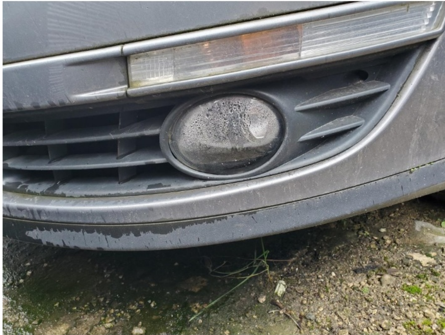
Schadenbereich: Nebelscheinwerfer links Wassereintritt
