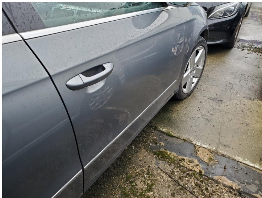
Schadenbereich: Die Tür vorne rechts ist deformiert
