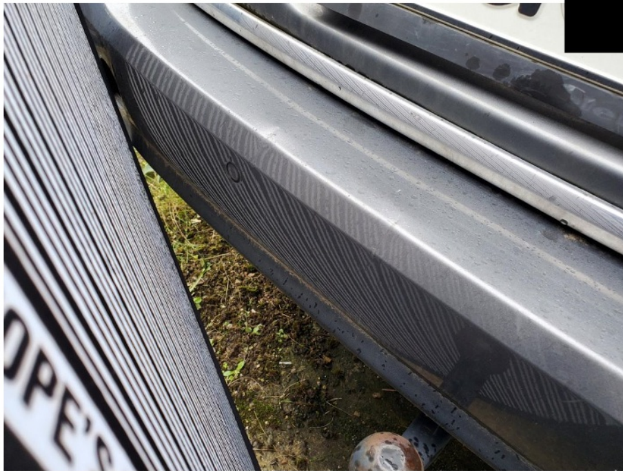
Schadenbereich: Die Stoßfängerverkleidung hinten ist deformiert
