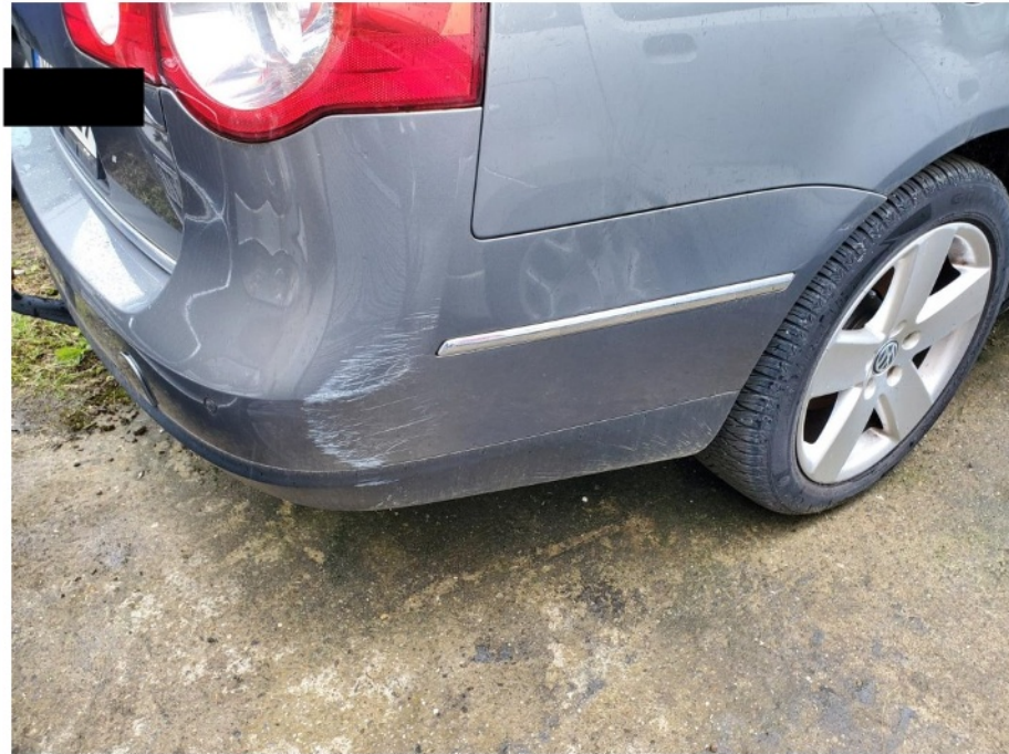
Schadenbereich: Die Stoßfängerverkleidung hinten ist deformiert
