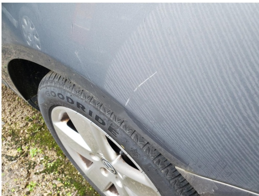
Schadenbereich: Die Seitenwand zeigt Kratzer
