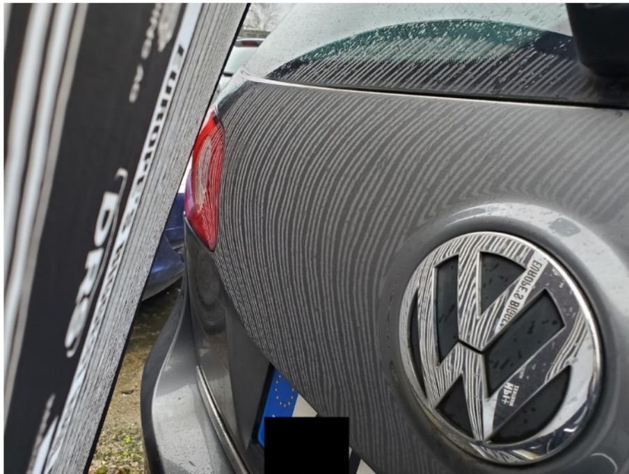
Schadenbereich: Die Heckklappe ist mehrfach eingedellt
