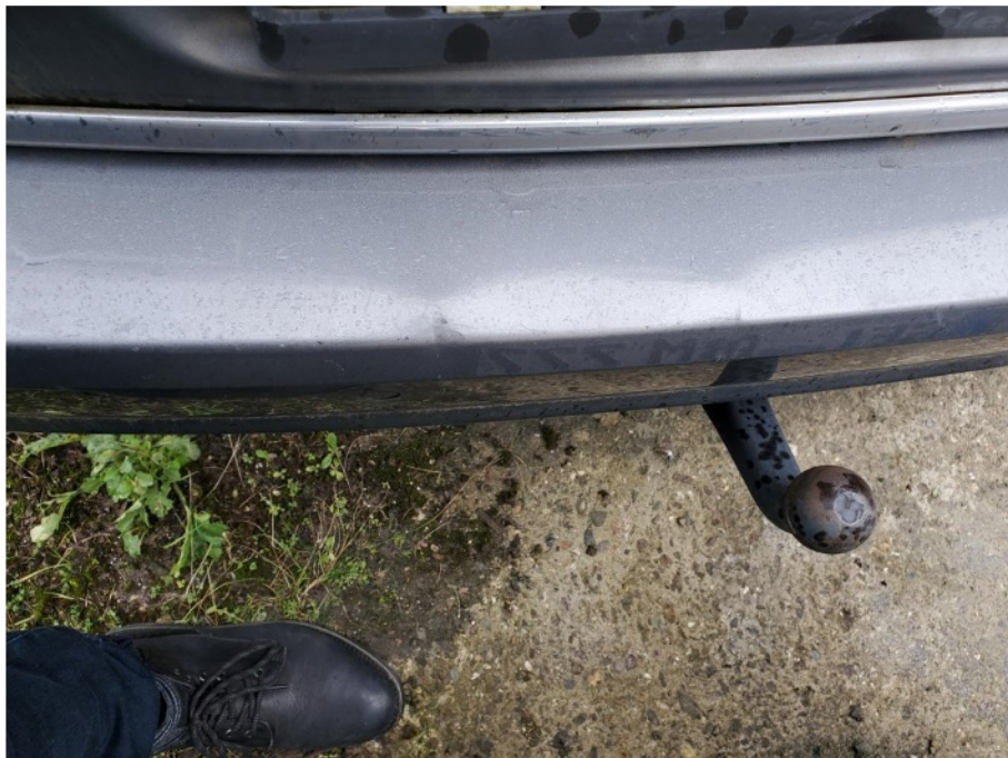
Schadenbereich: Die Stoßfängerverkleidung hinten ist deformiert
