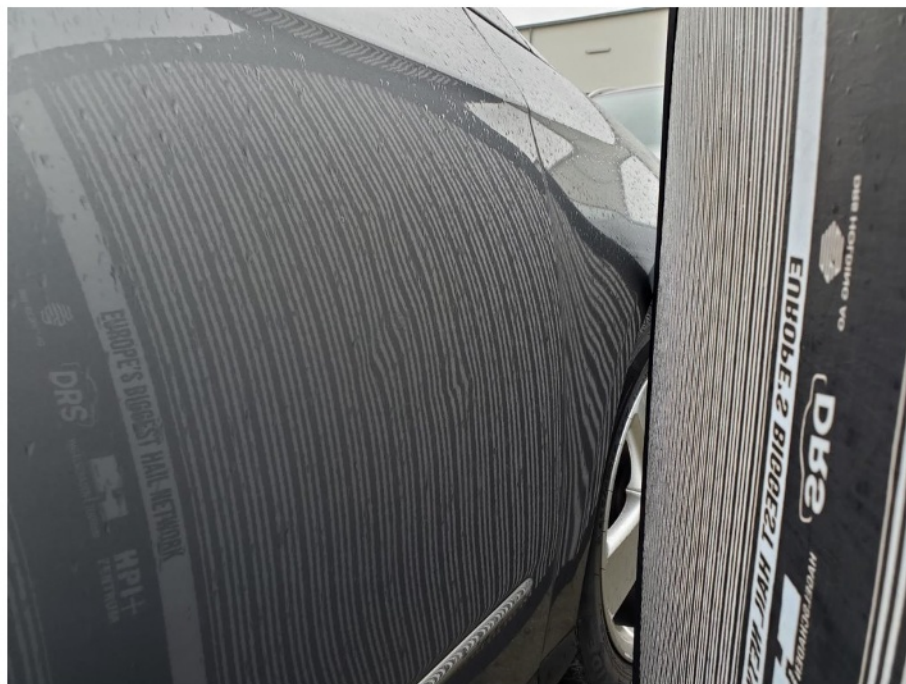
Schadenbereich: Die Tür vorne rechts ist deformiert
