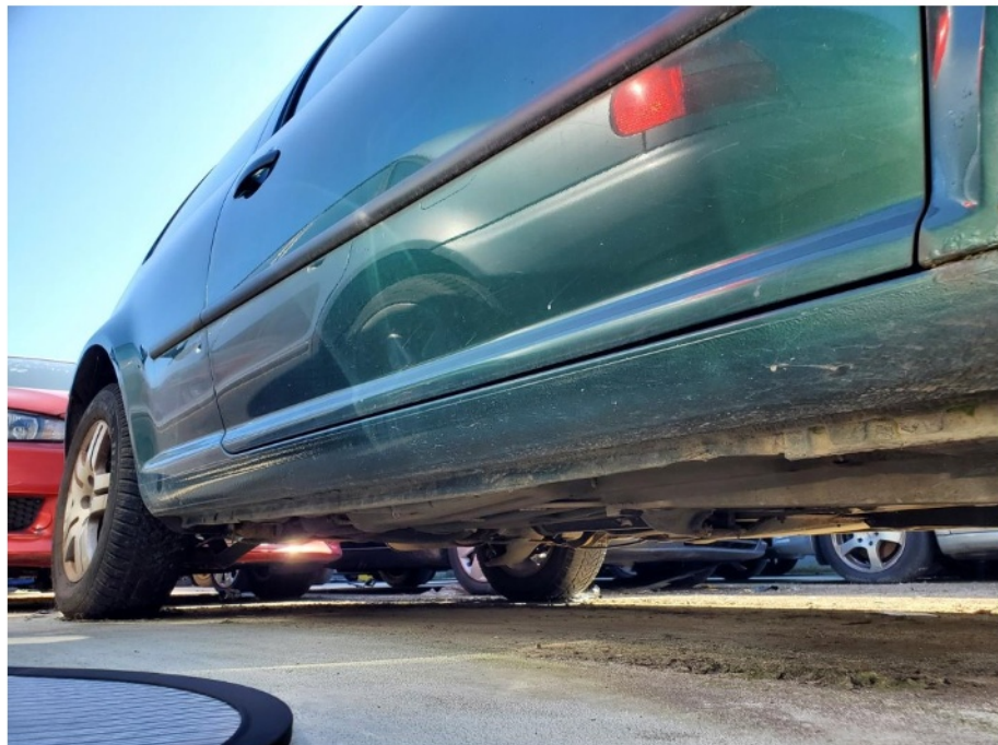
Schadenbereich: Der Schweller rechts ist deformiert
