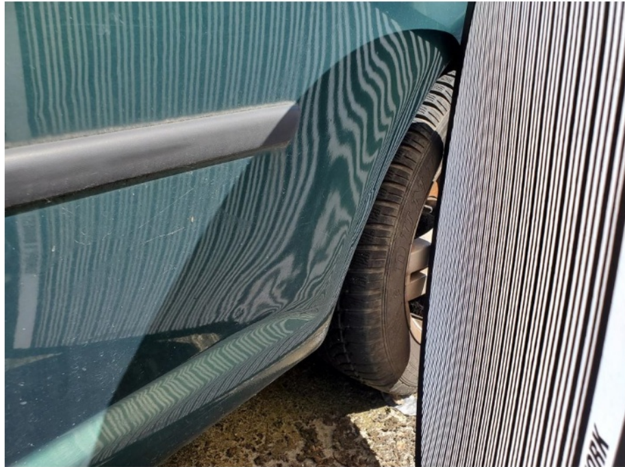
Schadenbereich: Die Seitenwand links ist deformiert / Lichtbildaufnahme mit Streifensegel
