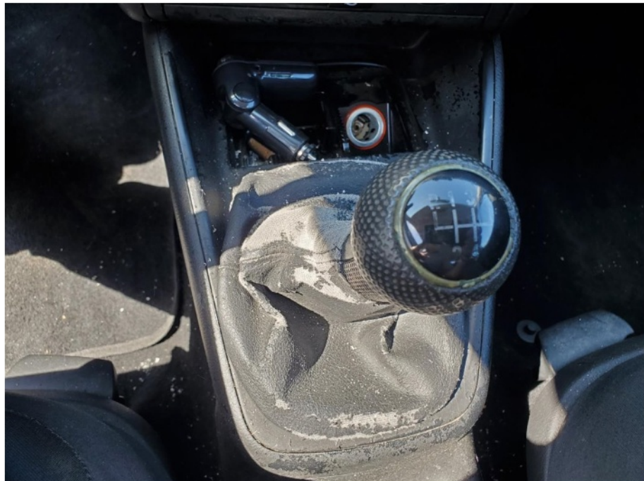
Schadenbereich: Die Schaltmanschette ist abgenutzt
