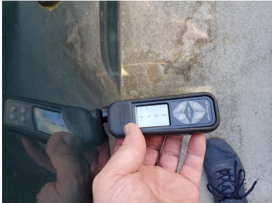
Schadenbereich: Seitenwand rechts Lackschichtenmessung / nicht messbar
