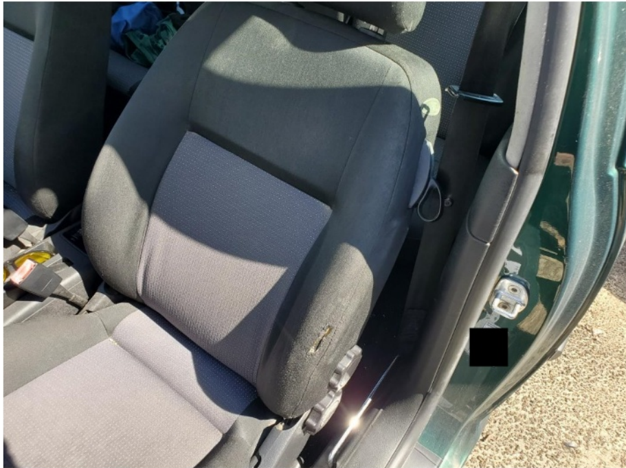
Schadenbereich: Der Sitzbezug Fahrersitz ist durchgescheuert
