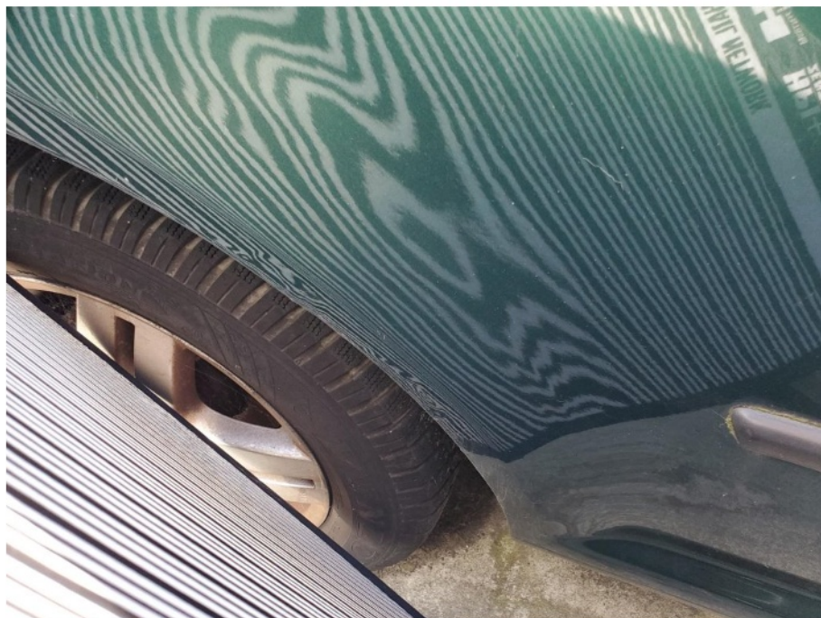
Schadenbereich: Die Seitenwand rechts ist deformiert/ Lichtbildaufnahme mit Streifensegel
