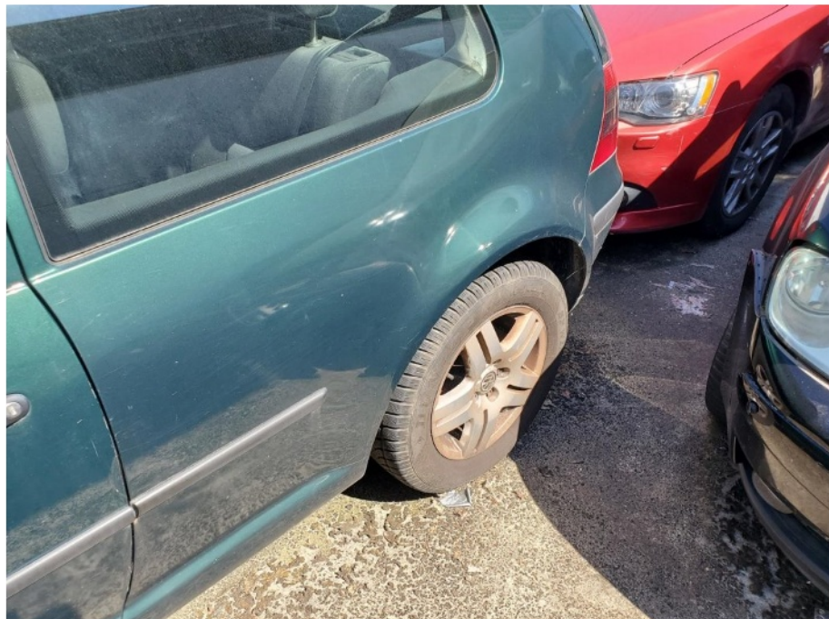
Schadenbereich: Seitenwand links Lackschichtenmessung / nicht messbar
