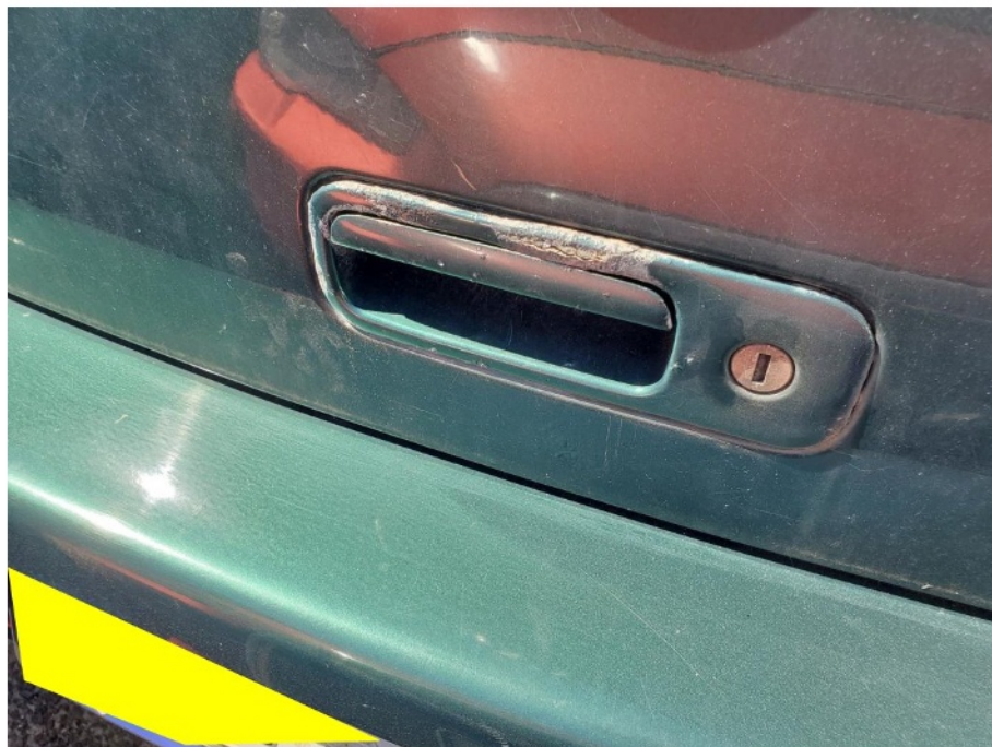
Schadenbereich: Rostansatz Heckklappengriff
