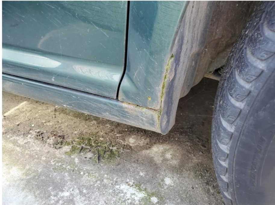
Schadenbereich: Rostansatz Schweller rechts und Kotflügel rechts
