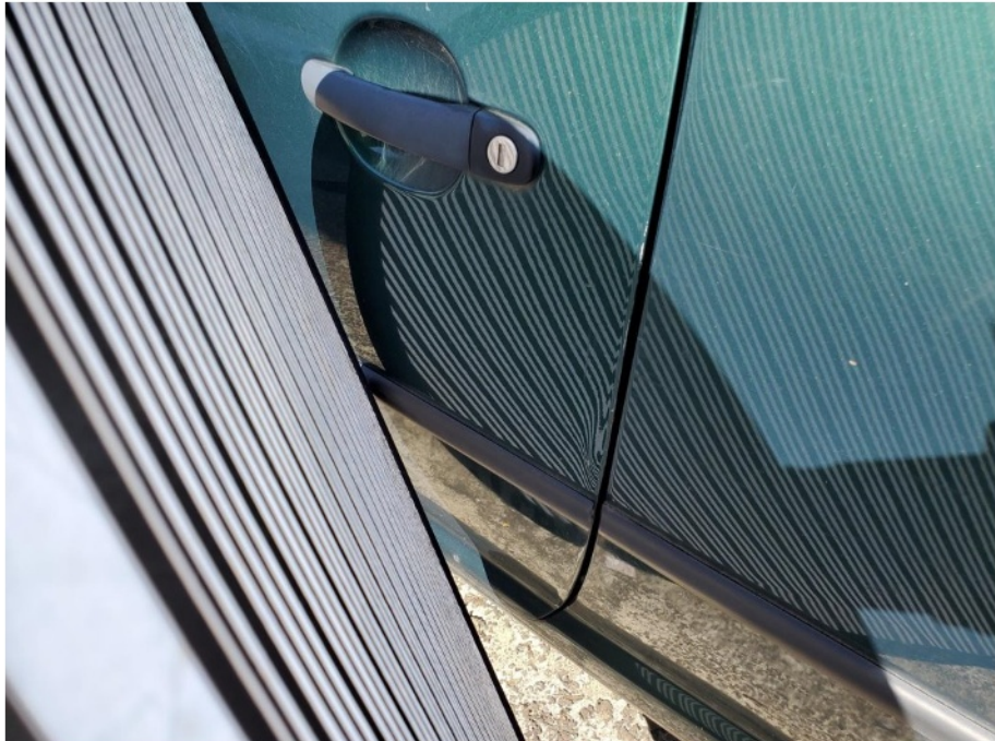
Schadenbereich: Die Tür links ist im Kantenbereich deformiert / Lichtbildaufnahme mit Streifensegel
