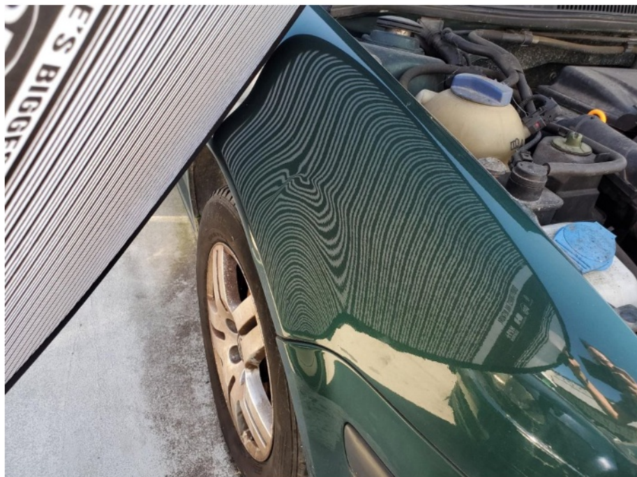
Schadenbereich: Der Kotflügel rechts ist deformiert/ Lichtbildaufnahme mit Streifensegel
