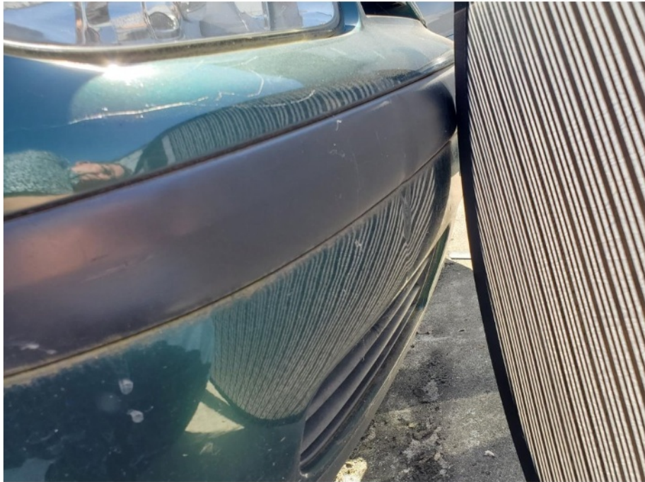
Schadenbereich: Die Stoßfängerverkleidung vorne ist deformiert/ Lichtbildaufnahme mit Streifensegel
