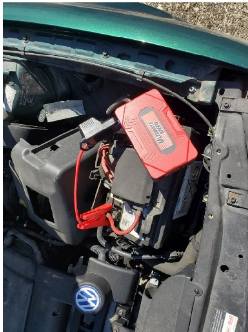
Schadenbereich. Batterie defekt
