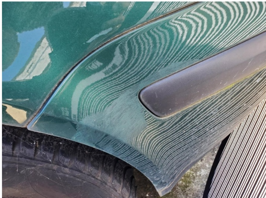
Schadenbereich: Die Stoßfängerverkleidung vorne ist verschrammt/ Lichtbildaufnahme mit Streifensegel
