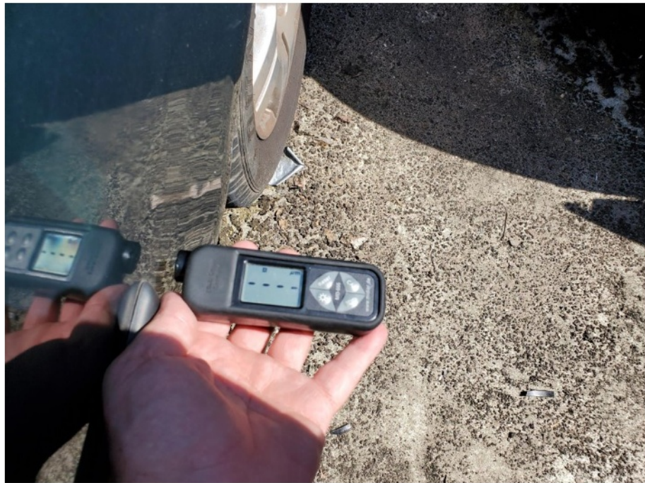
Schadenbereich: Seitenwand links Lackschichtenmessung / nicht messbar
