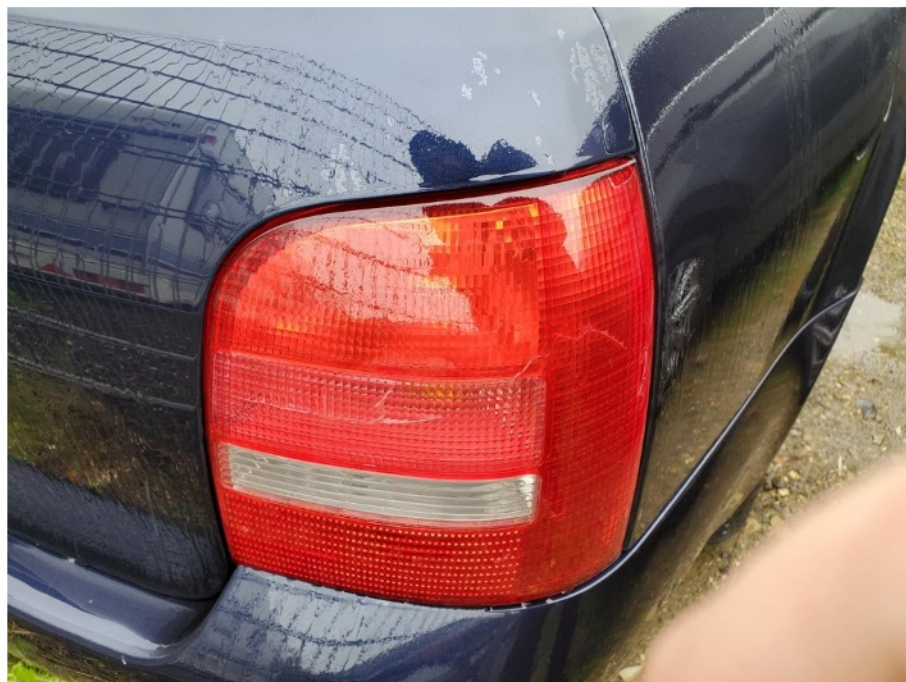
Schadenbereich: Die Rückleuchte rechts ist gebrochen
