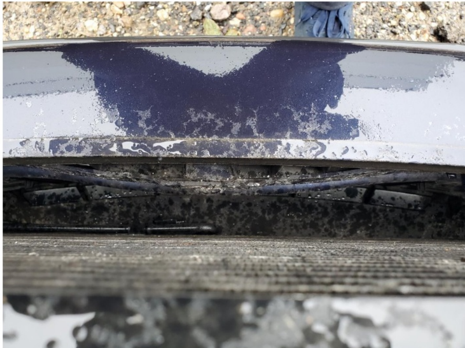
Schadenbereich: Der Querträger vorne ist deformiert
