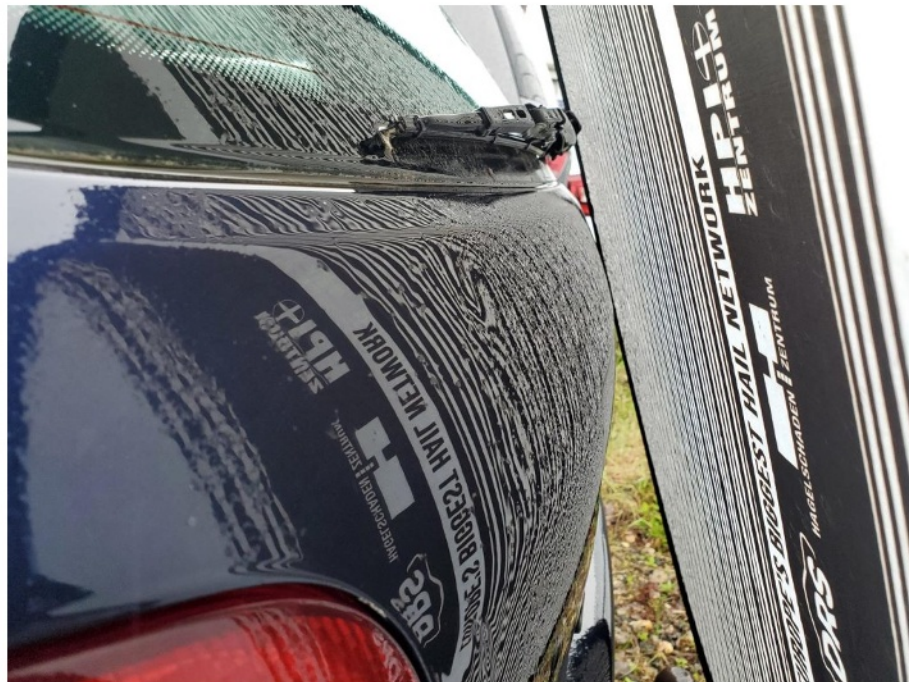
Schadenbereich : Die Heckklappe ist deformiert / Lichtbildaufnahme mit Streifenregel
