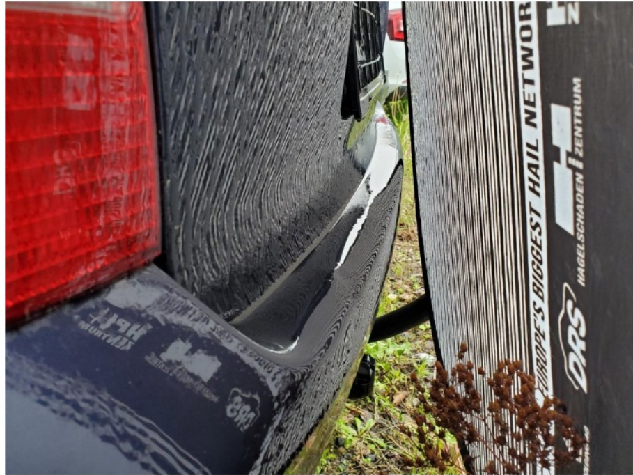
Schadenbereich : Lichtbildaufnahme mit Streifenregel
