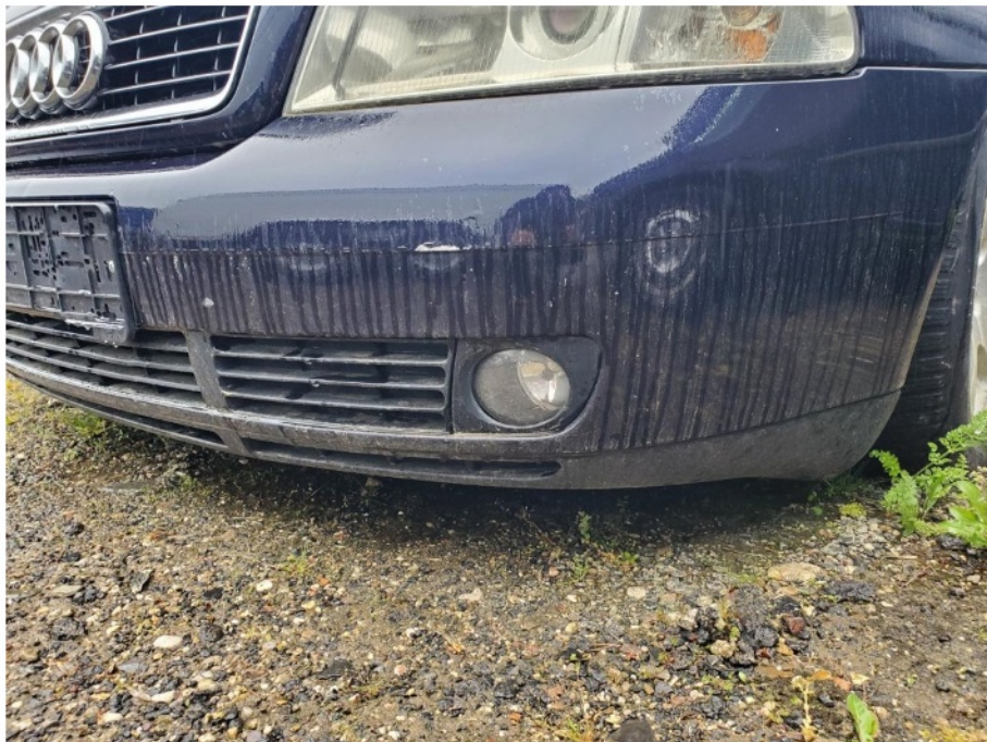
Schadenbereich: Die Stoßfängerverkleidung vorne ist gebrochen
