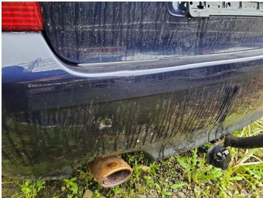
Schadenbereich : Die Stoßfängerverkleidung hinten ist deformiert
