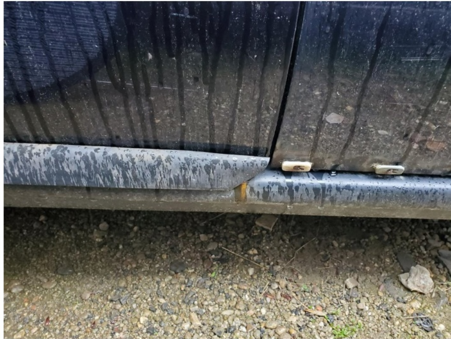
Schadenbereich: Die Schutzblenden der Türen rechts sind verformt
