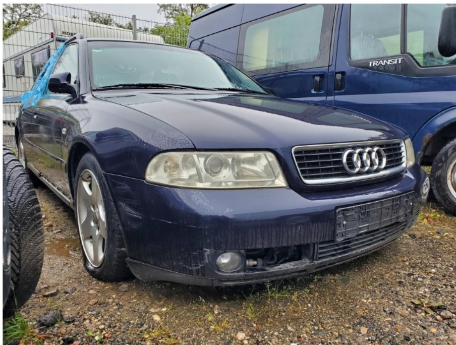
Schadenbereich: Die Stoßfängerverkleidung vorne ist gebrochen
