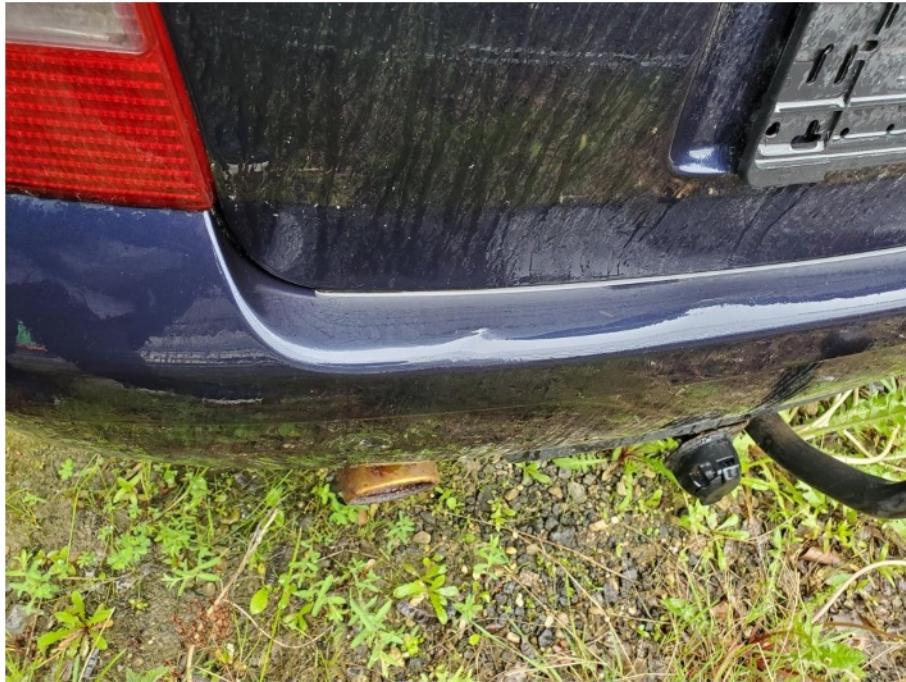
Schadenbereich : Die Stoßfängerverkleidung hinten ist deformiert
