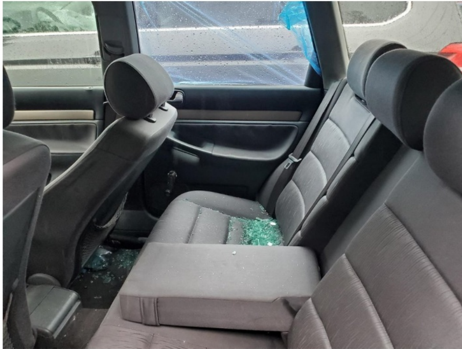
Schadenbereich: Die Seitenscheibe hinten rechts ist eingeschlagen
