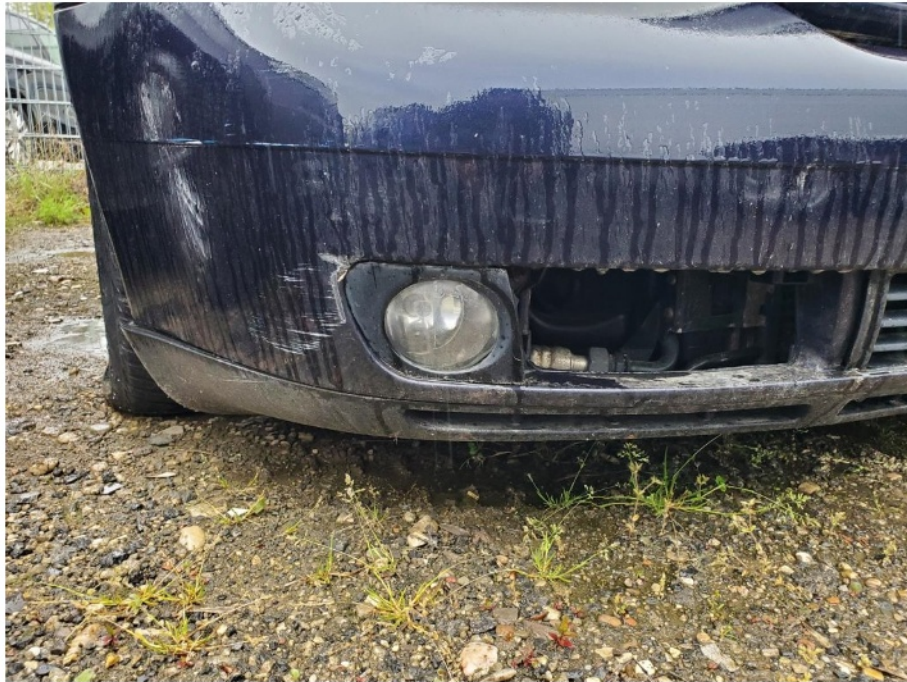
Schadenbereich: Die Stoßfängerverkleidung vorne ist gebrochen
