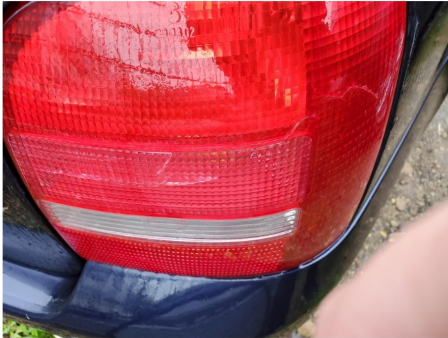
Schadenbereich: Die Rückleuchte rechts ist gebrochen
