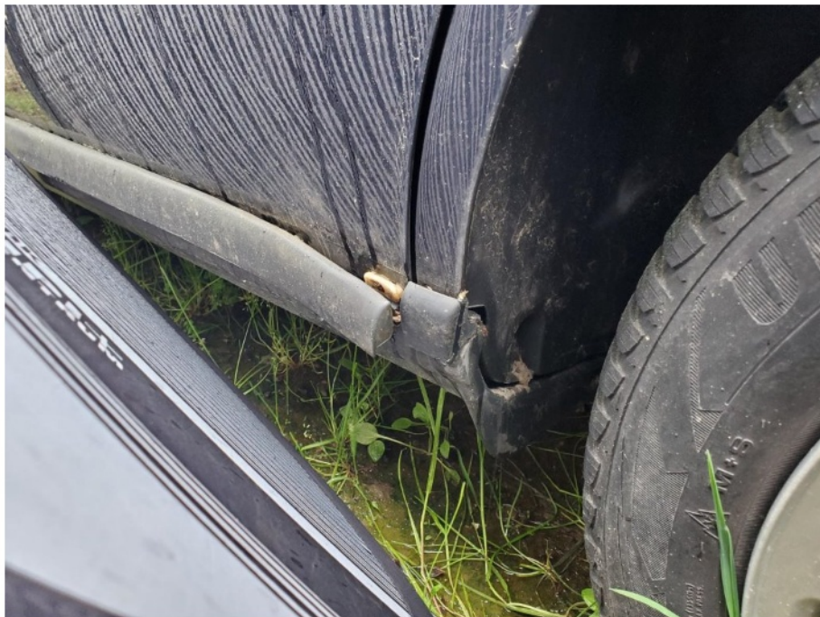
Schadenbereich : Die Tür hinten links ist verformt/ Die Schutzblenden sind verformt
