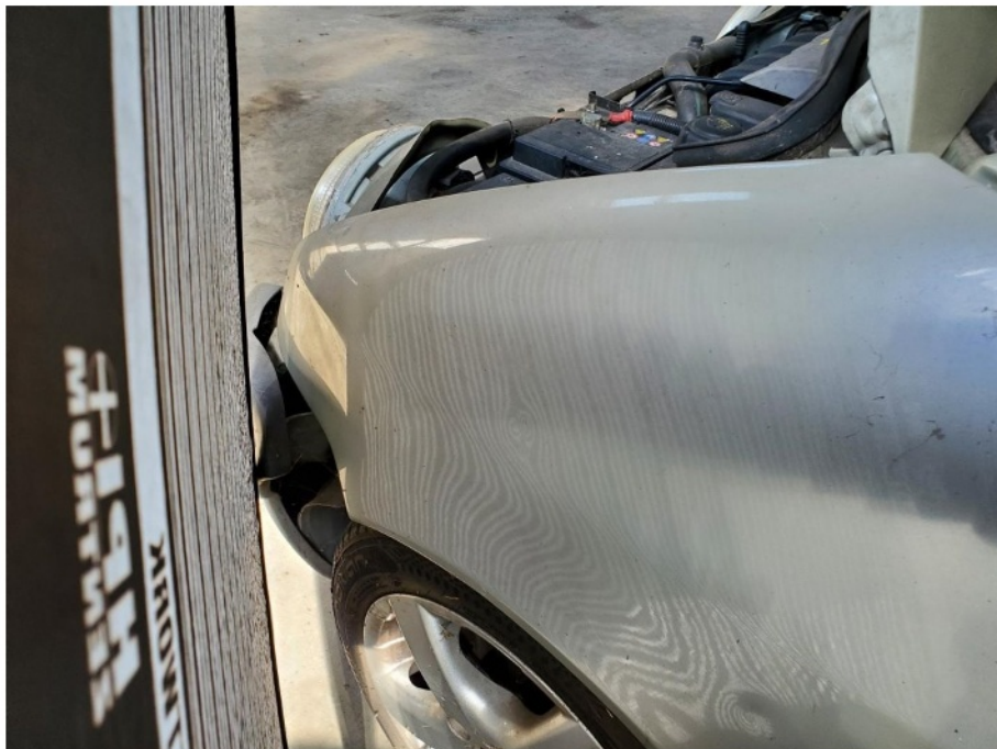
Schadenbereich: Der Kotflügel links ist eingedellt / Lichtbildaufnahme mit Streifensegel
