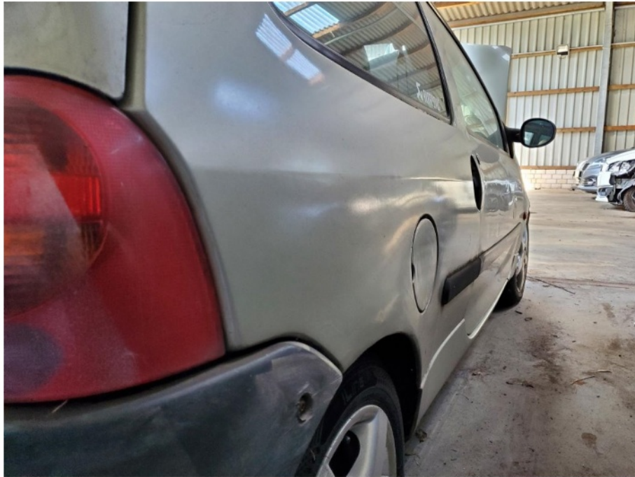
Schadenbereich: Die Seitenwand rechts wurde lackiert
