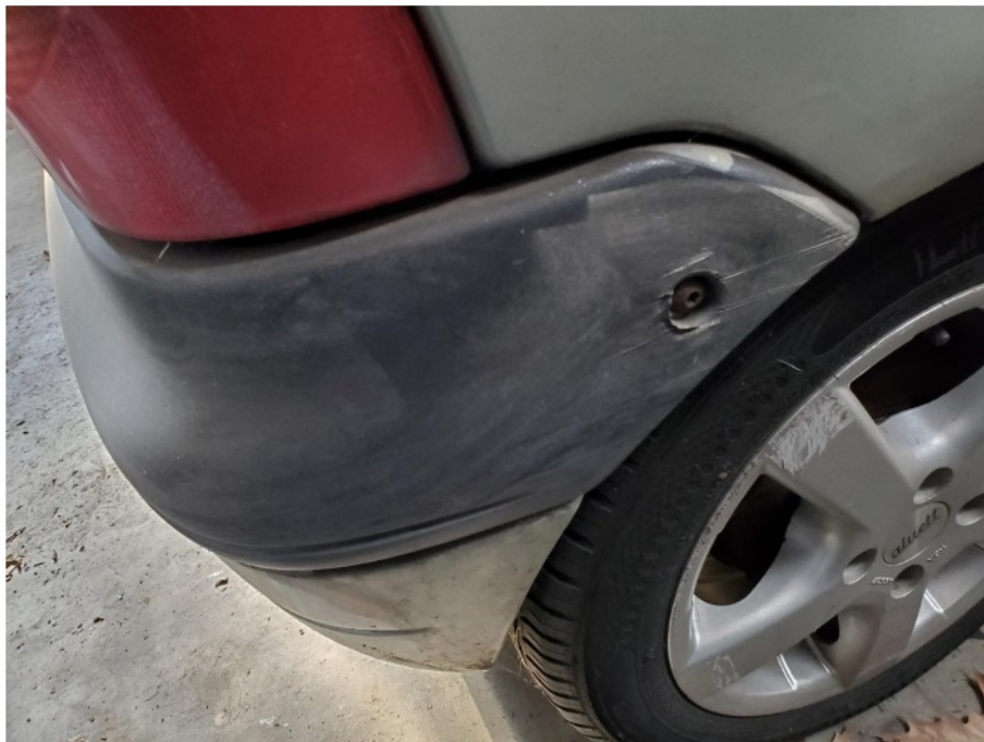
Schadenbereich: Die Stoßfängerverkleidung hinten ist verschrammt
