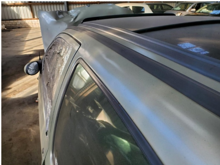
Schadenbereich: Der Dachrahmen links ist eingedellt
