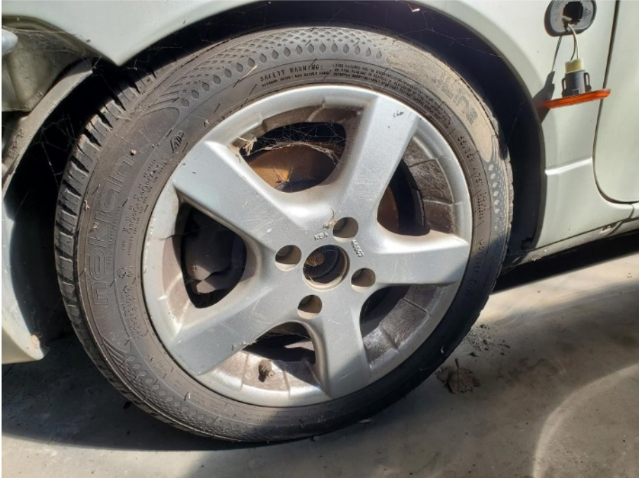
Schadenbereich: Die LM-Felge vorne links ist verschrammt
