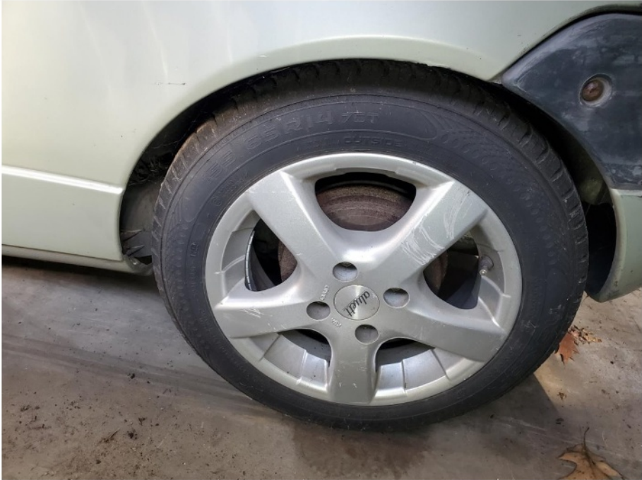
Schadenbereich: Die LM-Felge hinten links ist verschrammt
