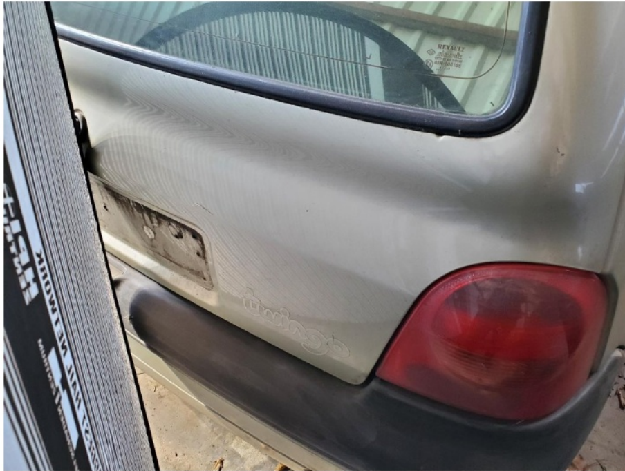
Schadenbereich : Die Heckklappe ist eingedellt / Lichtbildaufnahme mit Streifensegel
