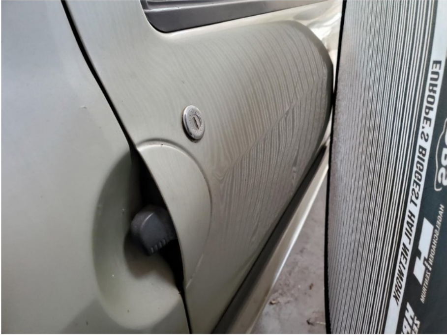
Schadenbereich: Die Tür rechts ist eingedellt / Lichtbildaufnahme mit Streifensegel
