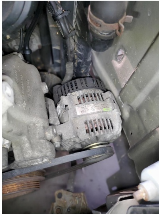
Schadenbereich: Die Lima ist beaufschlagt
