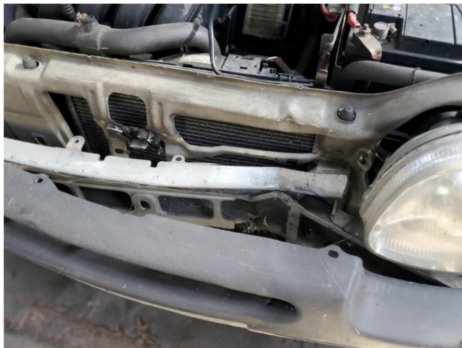
Schadenbereich: Die Stoßfängerverkleidung vorne ist gebrochen/ Die Frontmaske ist deformiert/ Der Hauptscheinwerfer links ist gebrochen
