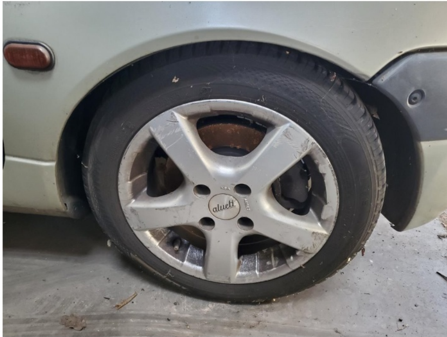
Schadenbereich: Die LM-Felge vorne rechts ist verschrammt
