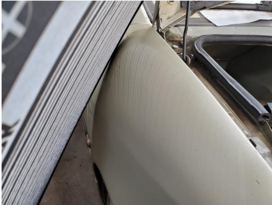
Schadenbereich: Der Kotflügel rechts ist eingedellt / Lichtbildaufnahme mit Streifensegel
