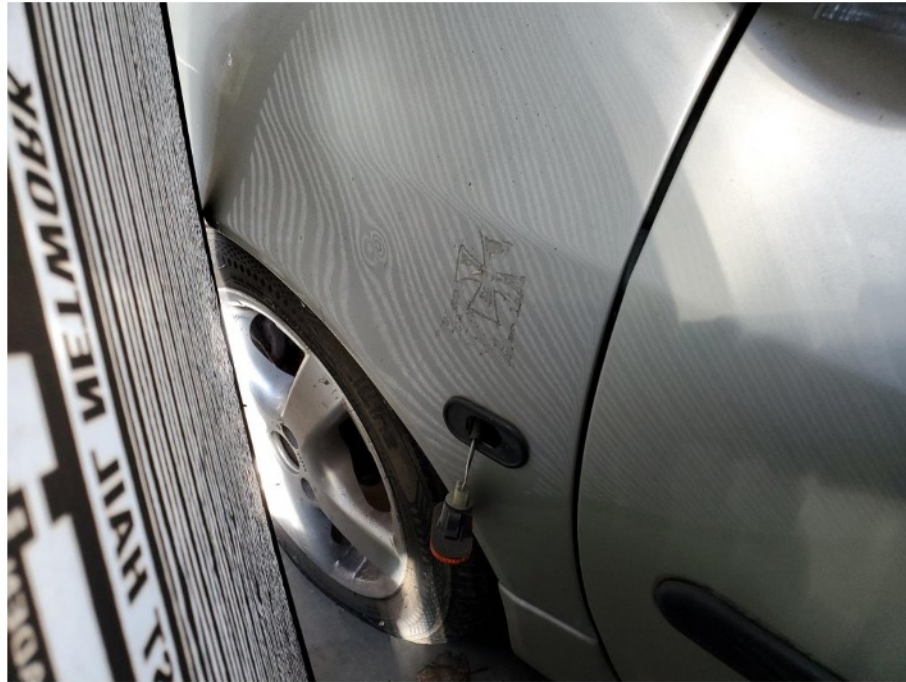
Schadenbereich: Der Kotflügel links ist eingedellt / Lichtbildaufnahme mit Streifensegel / Der Blinker links ist gebrochen
