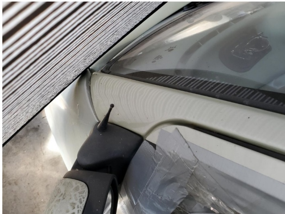
Schadenbereich : Die A-Säule links ist eingedellt / Lichtbildaufnahme mit Streifensegel
