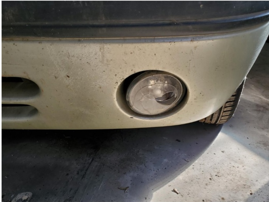
Schadenbereich: Der Nebelscheinwerfer links ist gebrochen
