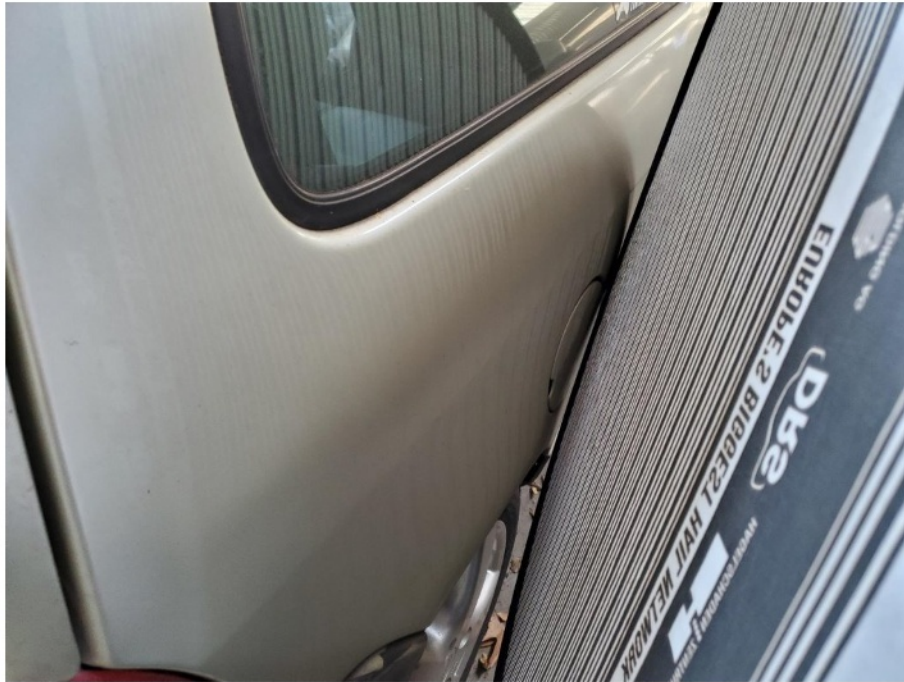
Schadenbereich: Die Seitenwand rechts ist eingedellt / Lichtbildaufnahme mit Streifensegel
