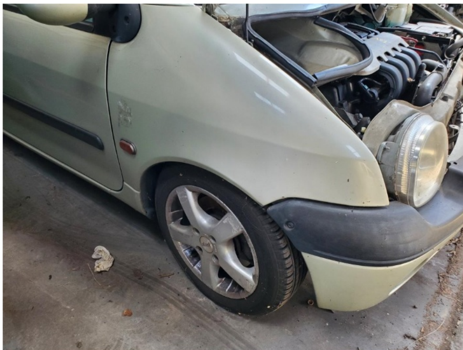
Schadenbereich: Der Kotflügel rechts ist eingedellt
