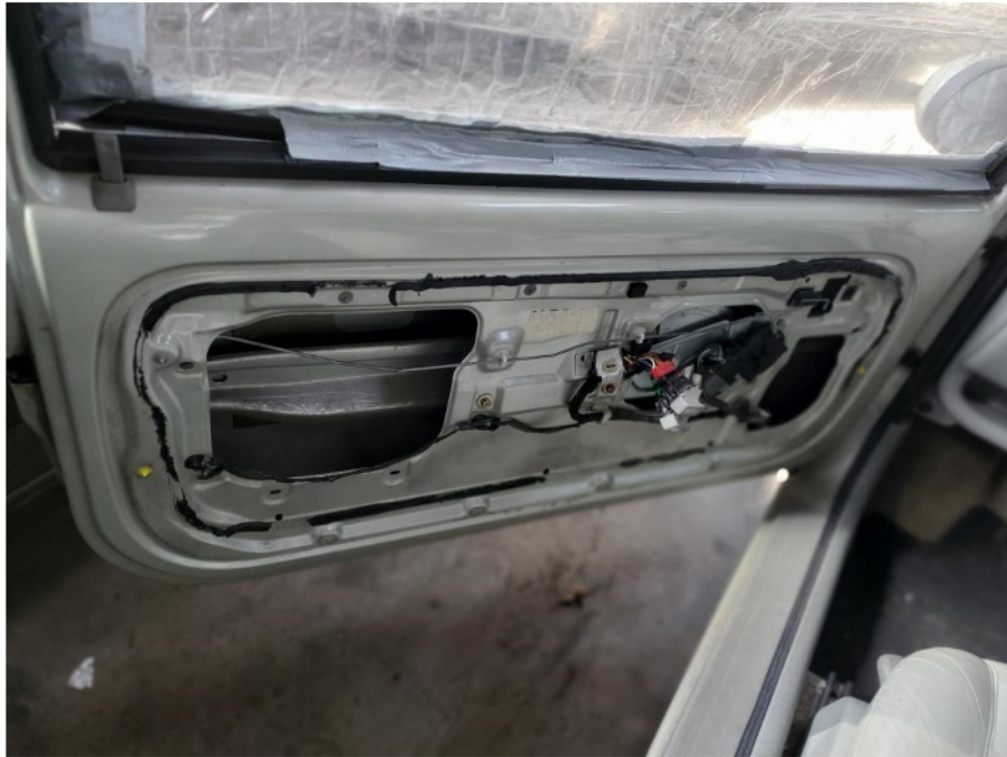
Schadenbereich: Türverkleidung vorne links fehlt / Türscheibe links gebrochen
