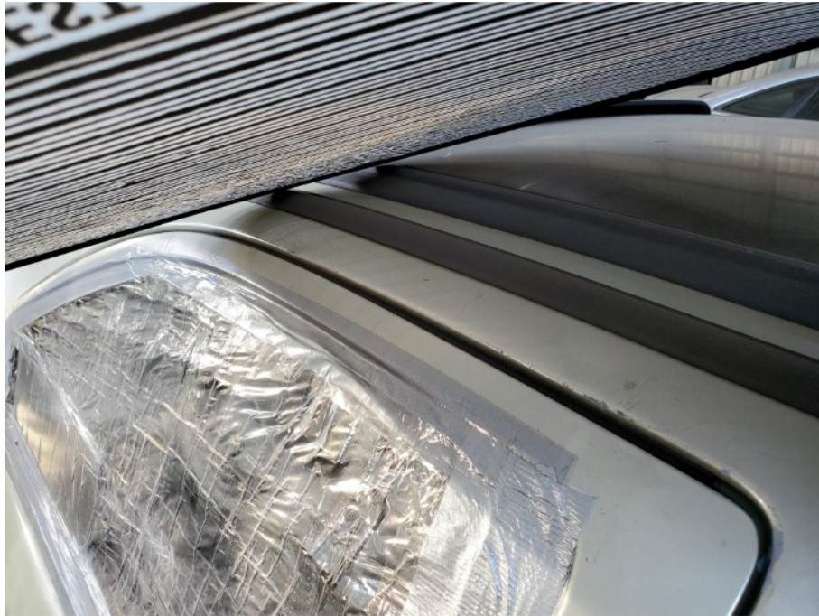
Schadenbereich: Der Dachrahmen links ist eingedellt / Lichtbildaufnahme mit Streifensegel
