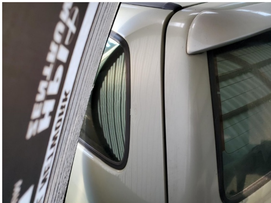
Schadenbereich: Die Seitenwand links ist eingedellt / Lichtbildaufnahme mit Streifensegel
