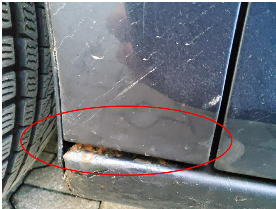
Bild 7 : Kotflügel vorne links, korrodiert, instandsetzen und lackieren mit Lackaufbau
