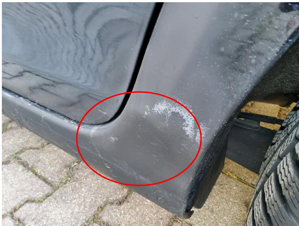
Bild 9 : Seitenteil hinten links Kniestück, korrodiert, instandsetzen und lackieren mit Lackaufbau
