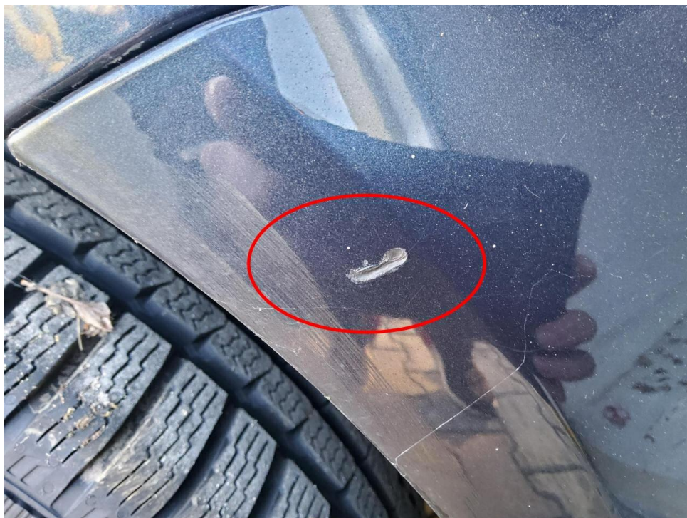
Bild 16 : Stoßfänger vorne Lackierung, zerkratzt, lackieren mit Lackaufbau
