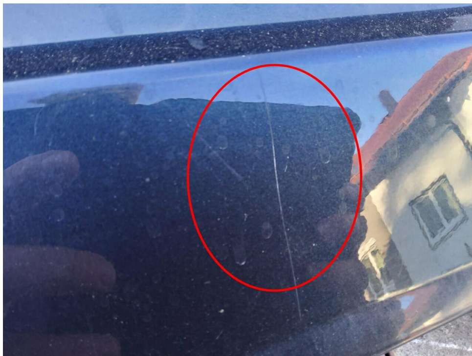
Bild 11 : Heckklappe Lackierung, zerkratzt, lackieren mit Lackaufbau
