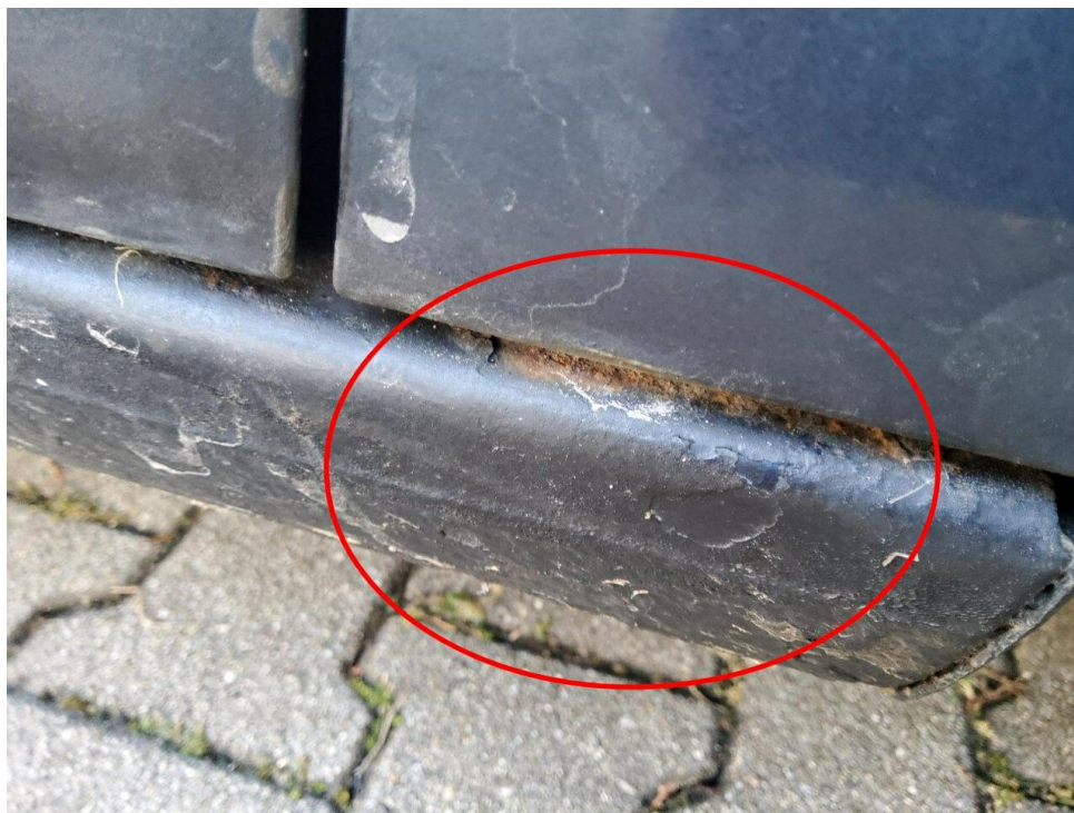
Bild 14 : Seitenschweller rechts, korrodiert, instandsetzen und lackieren mit Lackaufbau
