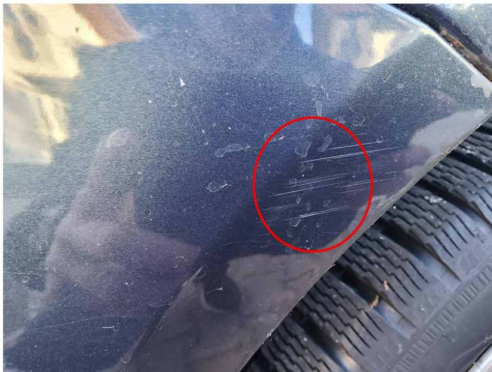
Bild 12 : Stoßfänger hinten Lackierung, zerkratzt, lackieren mit Lackaufbau
