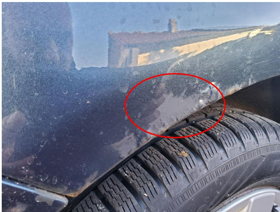
Bild 13 : Seitenteil hinten rechts, korrodiert, instandsetzen und lackieren mit Lackaufbau
