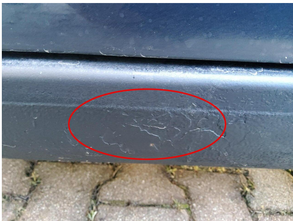
Bild 8 : Seitenschweller links, korrodiert, instandsetzen und lackieren mit Lackaufbau
