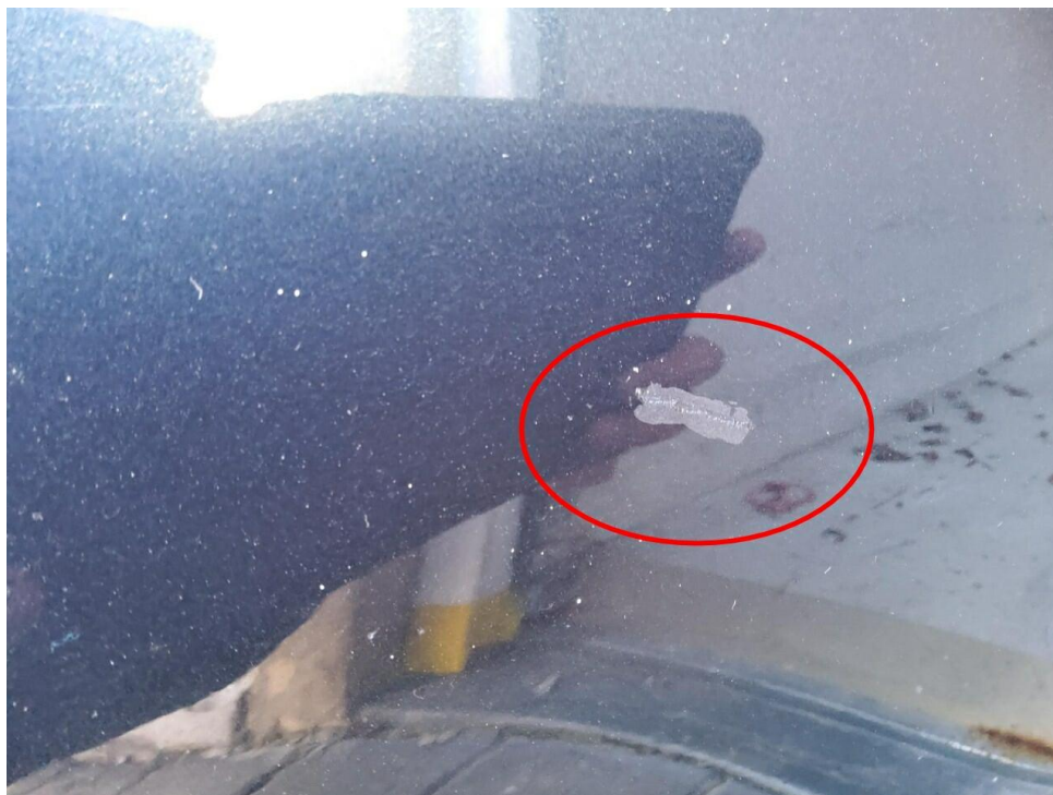
Bild 17 : Stoßfänger vorne Lackierung, zerkratzt, lackieren mit Lackaufbau
