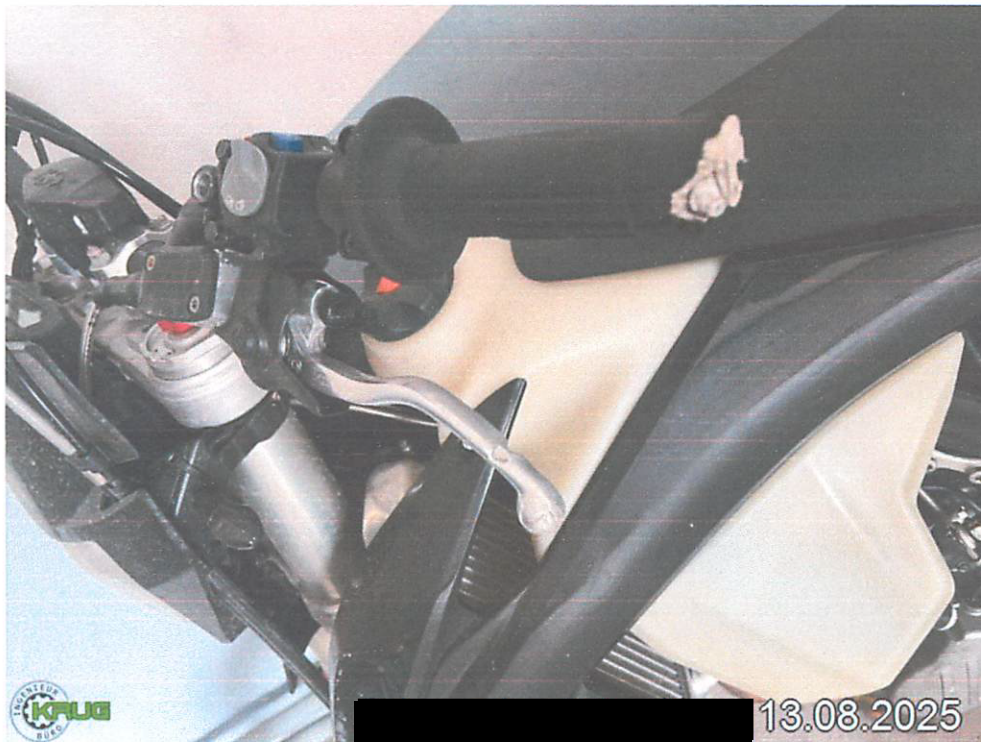
Foto 7: Lenker und Griff : beschädigt
