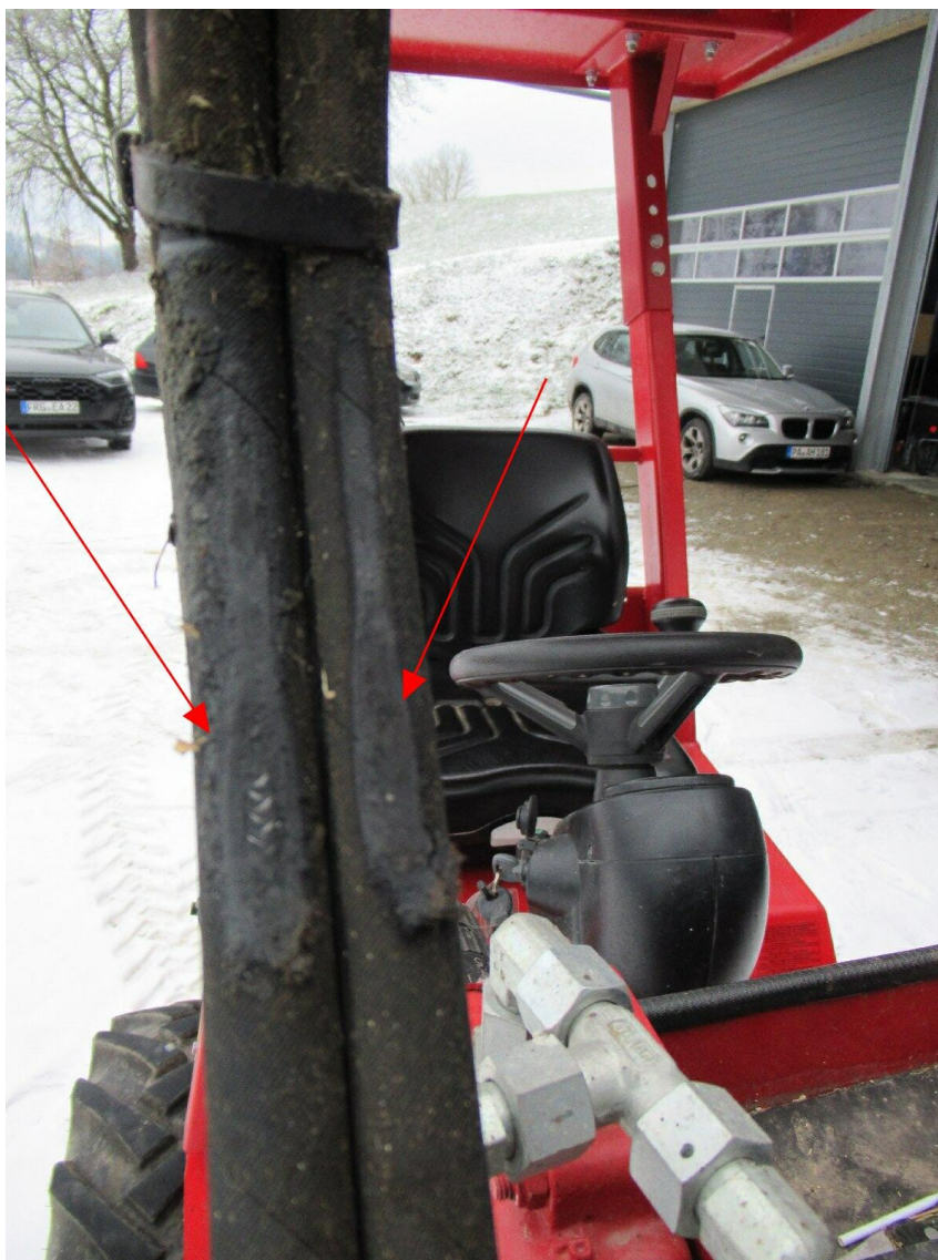
Bild 17 : Hydraulikschläuche am Teleskoparm angeschauert.
