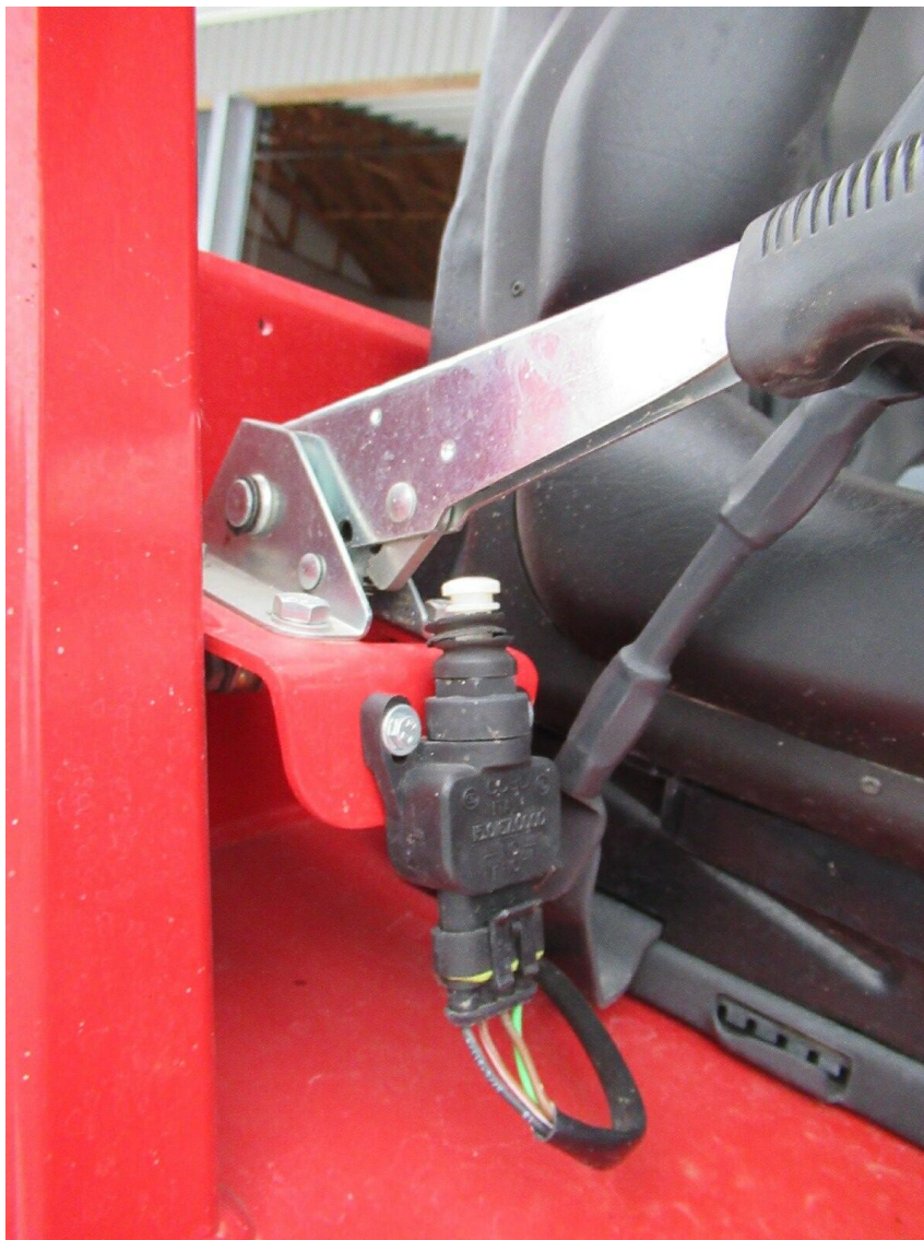
Bild 18 : Staubmanschette Schalter Handbremshebel gerissen
