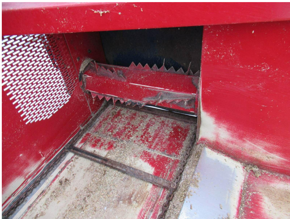
Bild 10 : Ansicht Walze/Kratzboden rechts
