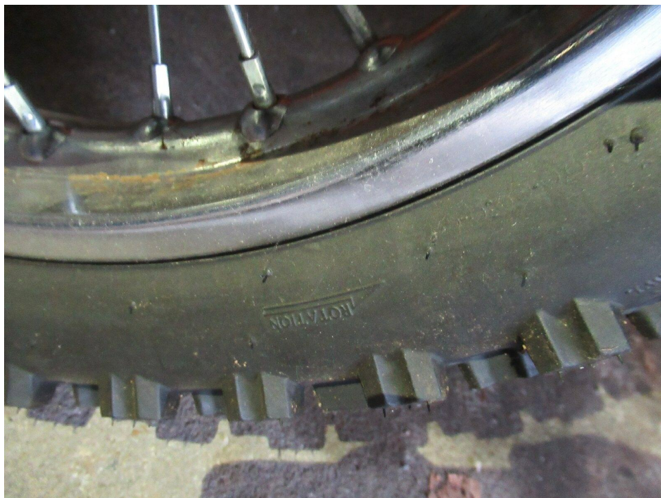
Bild 12 : Reifen hinten Laufrichtung falsch- ummontieren
