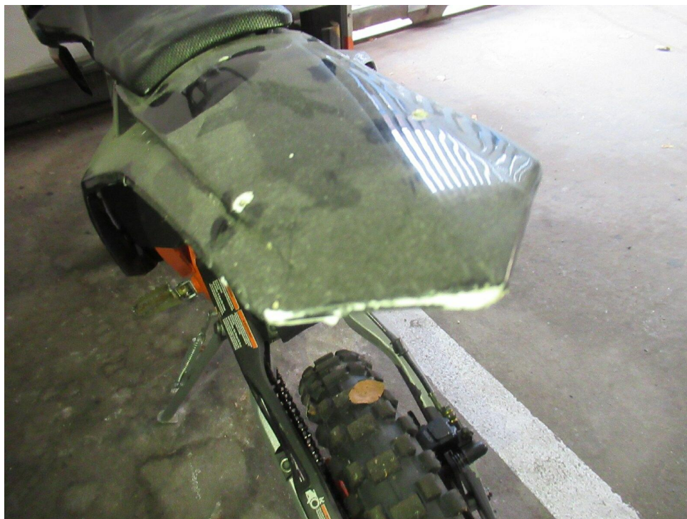
Bild 7 : Verkleidung Heckschutzblech durchbohrt und verschrammt
