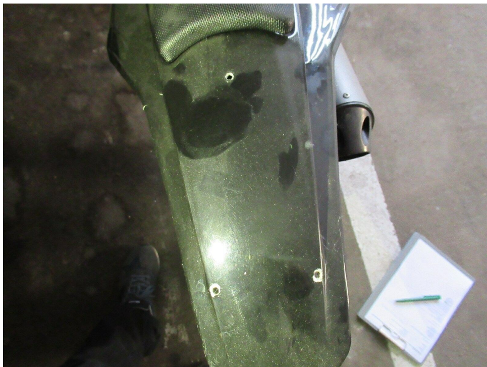
Bild 6 : Verkleidung Heckschutzblech durchbohrt und verschrammt
