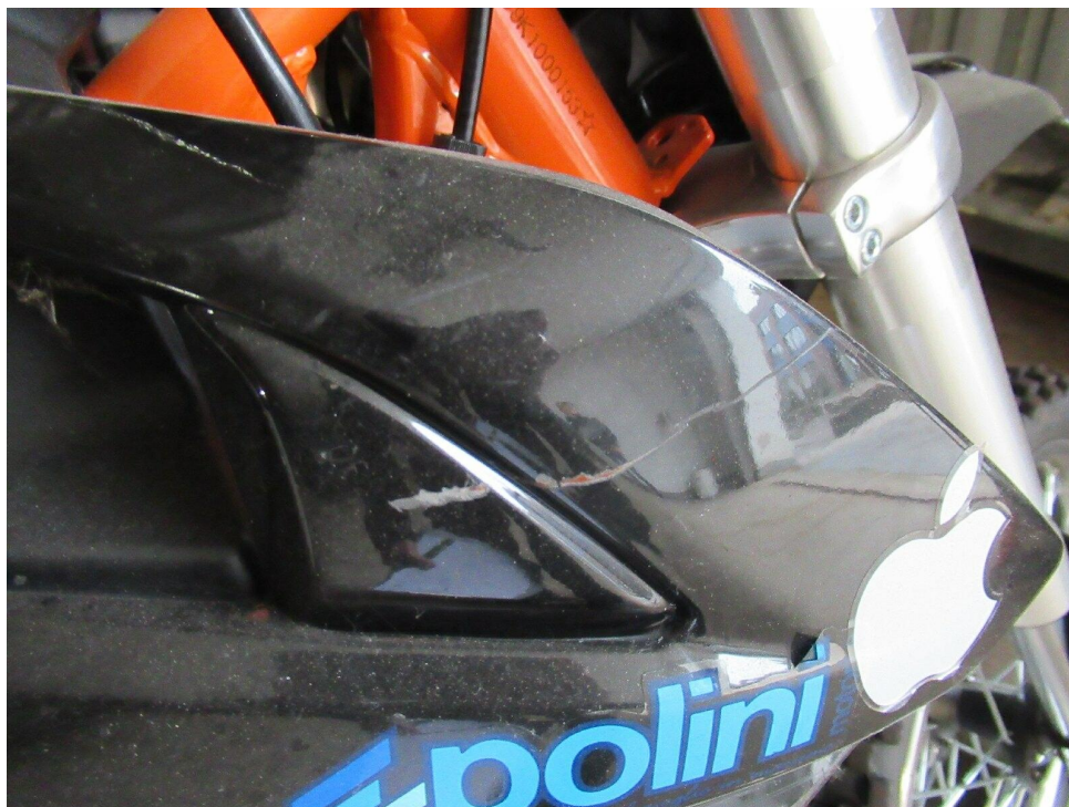
Bild 5 : Seitenverkleidung rechts zerkratzt
