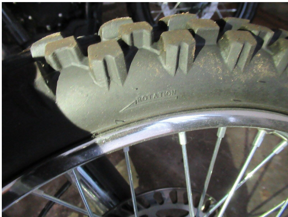
Bild 11 : Reifen vorne Laufrichtung falsch- ummontieren
