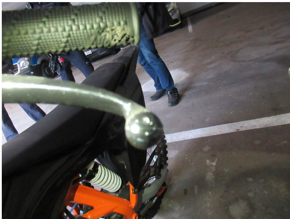
Bild 9 : Kupplungshebel links verschrammt
