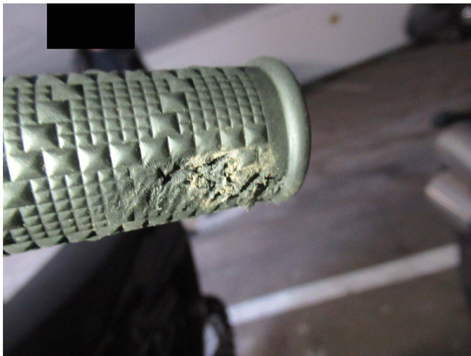
Bild 10 : Griff links verschrammt
