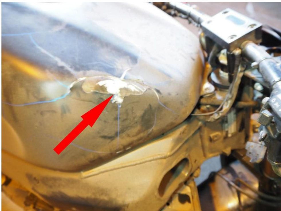
Bild: 8 Tank deutlich angeschlagen
