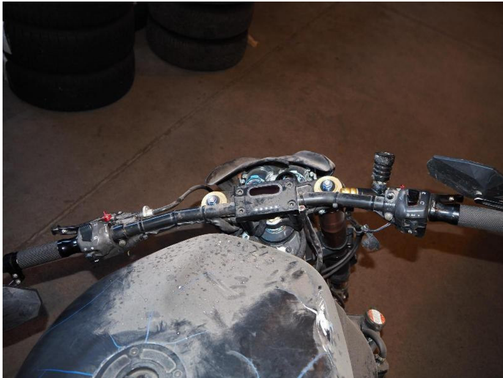
Bild: 7 Lenker mit Handbremseinheit usw. beschädigt
