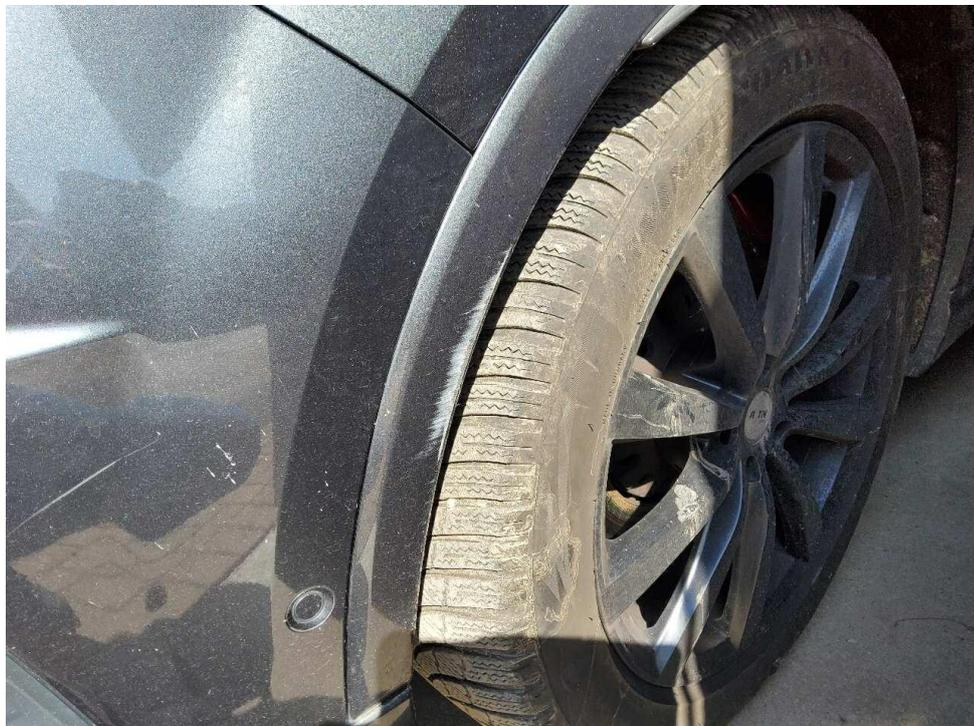
Bild 12 : Radlaufblende vorn links zerkratzt
