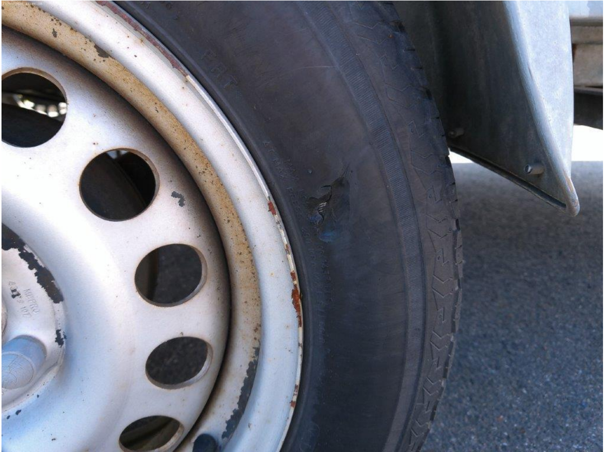
Reifen rechts... defekt!
