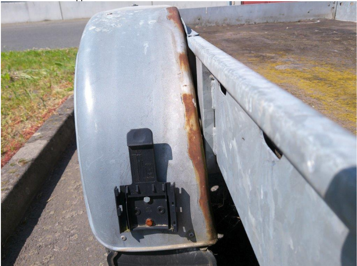
Radabdeckung links... Korrosion!
