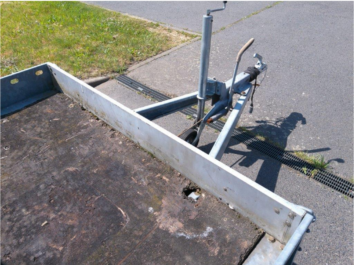
Draufsicht... Bodenplatte (tragendes Teil) defekt!
