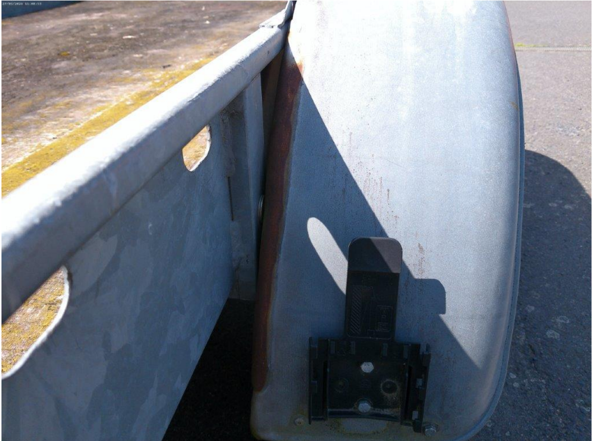
Radabdeckung rechts... Korrosion!
