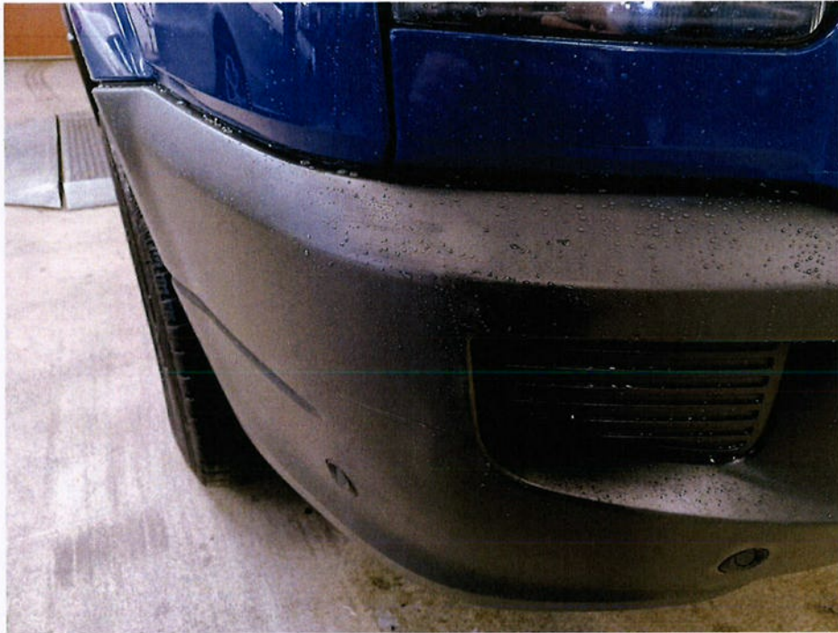
Bild 11 : Stoßfängerverkleidung vorn rechts und links plastisch verformt
