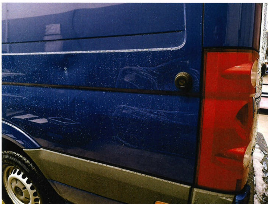
Bild 14 : Seitenwand hinten links großflächig eingedellt
