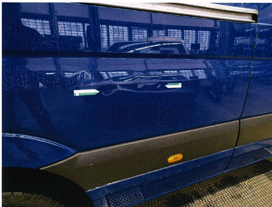
Bild 21 : Seitenwand hinten rechts mehrfach eingedellt
