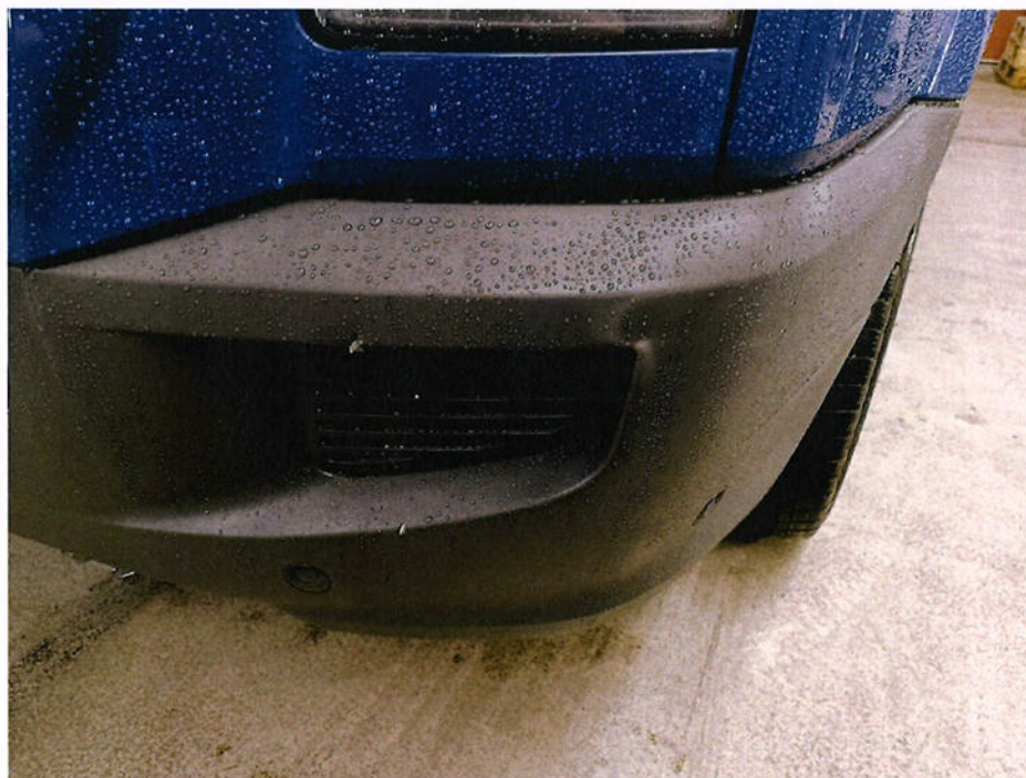
Bild 10 : Stoßfängerverkleidung vorn rechts und links plastisch verformt
