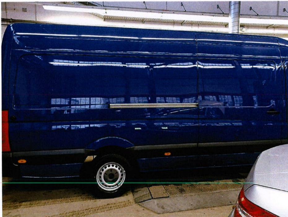
Bild 20 : Seitenwand hinten rechts mehrfach eingedellt
