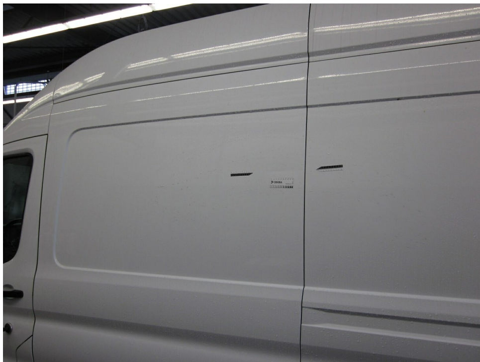
Bild 11 : Seitenwand mitte links eingedellt und verkratzt
