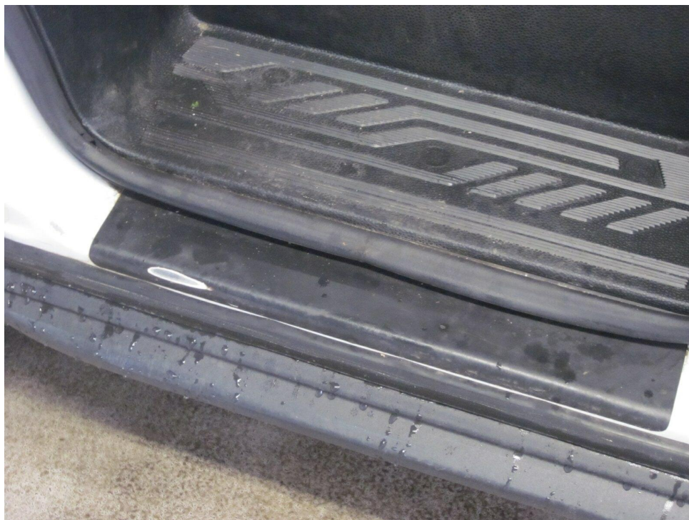
Bild 13 : Einstieg Fahrertür verkratzt
