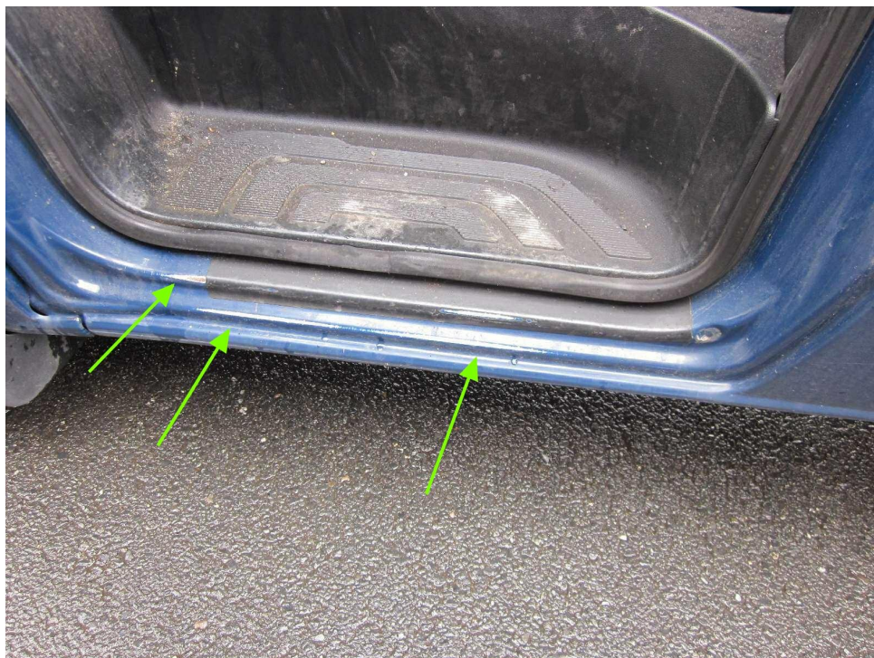
Bild 14 : Einstieg Fahrtür verkratzt
