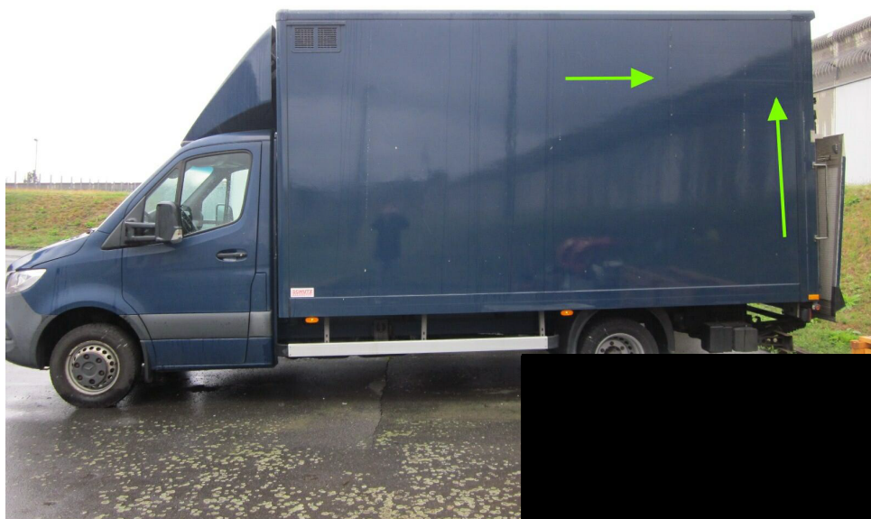
Bild 16 : Seitenansicht links Seitenwand oben links verkratzt
