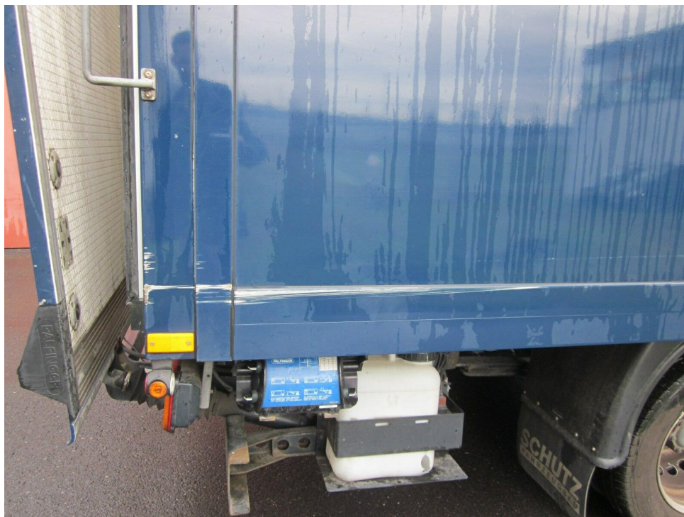
Bild 17 : Seitenwand hinten rechts verschürft
