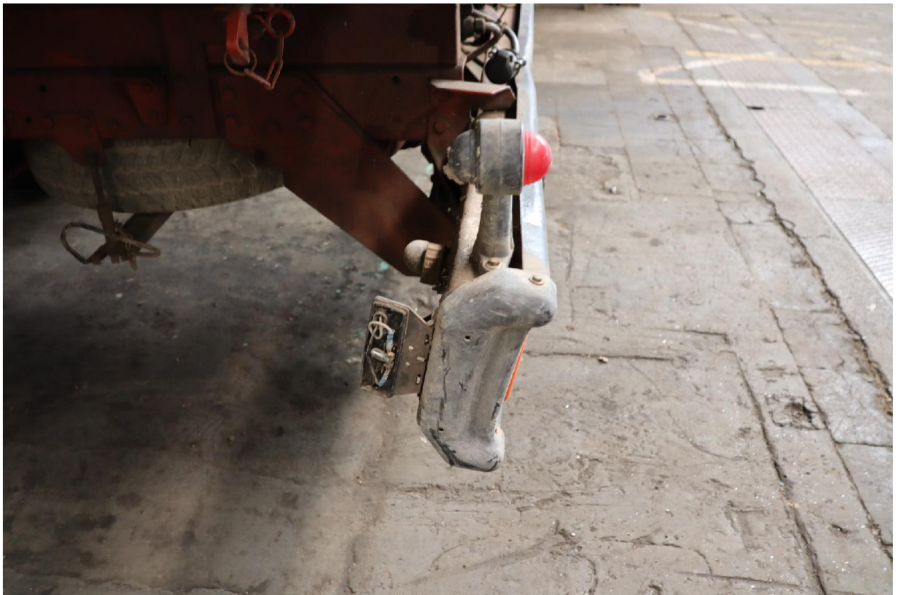
Bild 5: Seitenmarkierungsleuchte hinten links gebrochen
