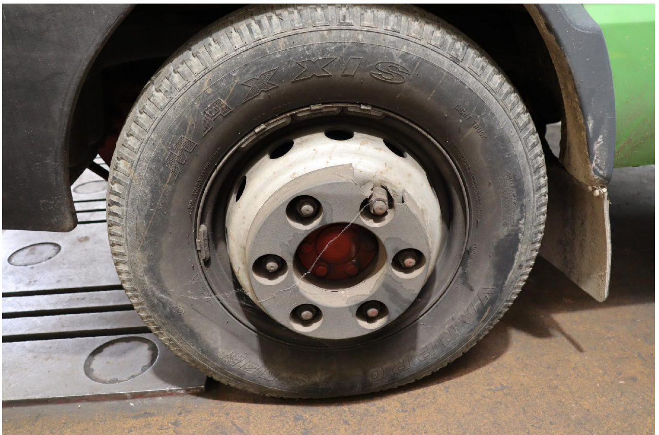
Bild 8: Radbolzenverkleidung vorn links gebrochen
