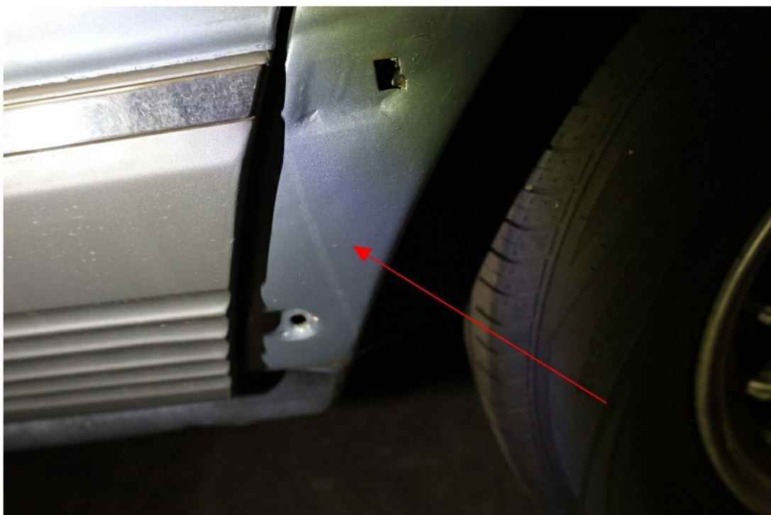
Bild 26 : Leiste Seitenwand links fehlt
