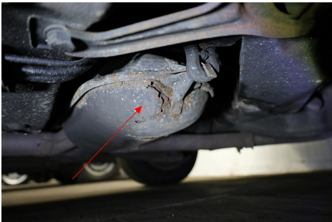
Bild 25 : Korrosion am Mittelschalldämpfer
