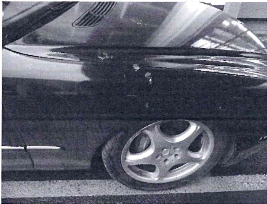
Bild 5 : Kotflügel rechts verkratzt Luftfahrwerk abgesenkt
