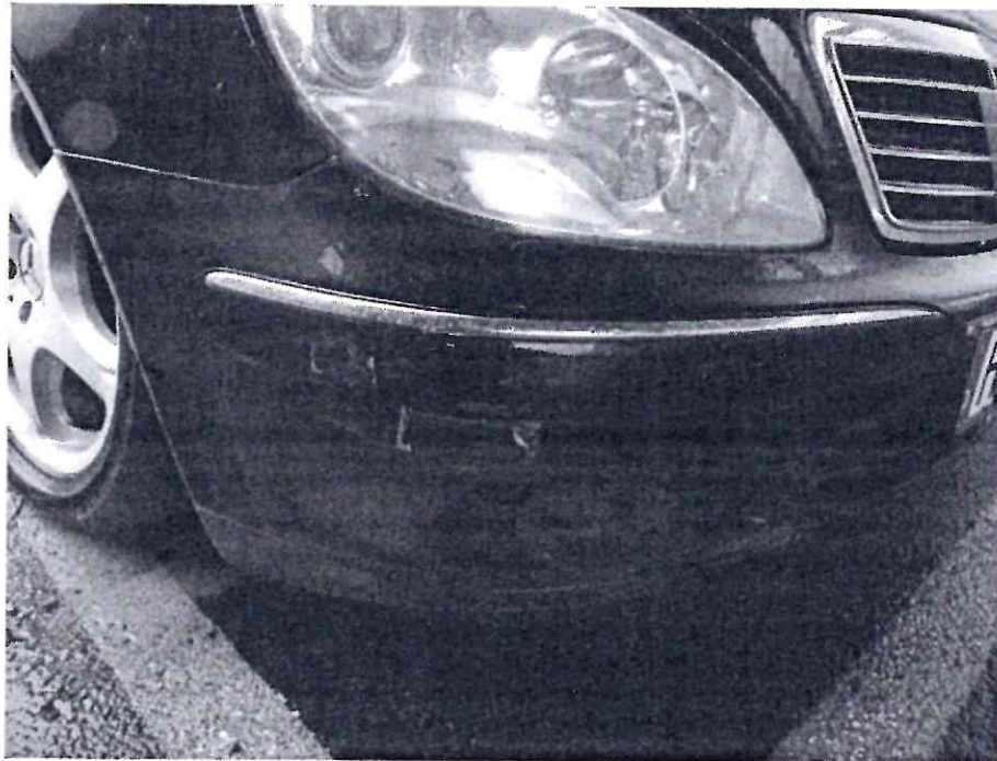
Bild 13 : Stoßfänger vorne eingekerbt und verschrammt
