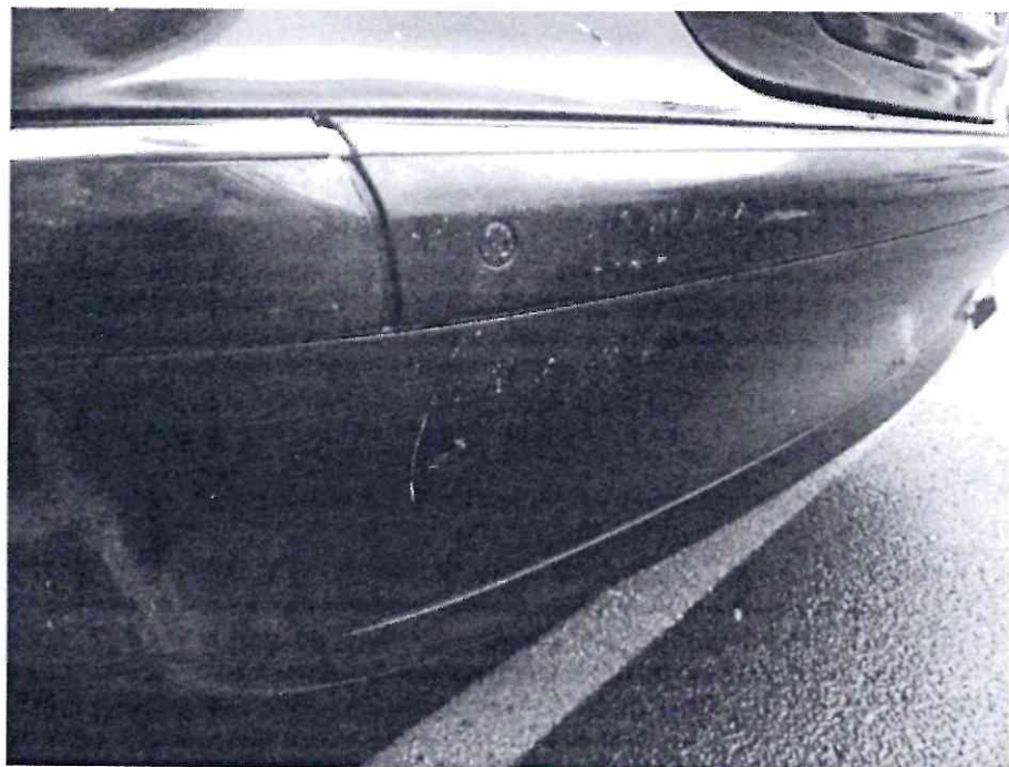
Bild 12 : Schrammspuren am hinteren Stoßfänger
