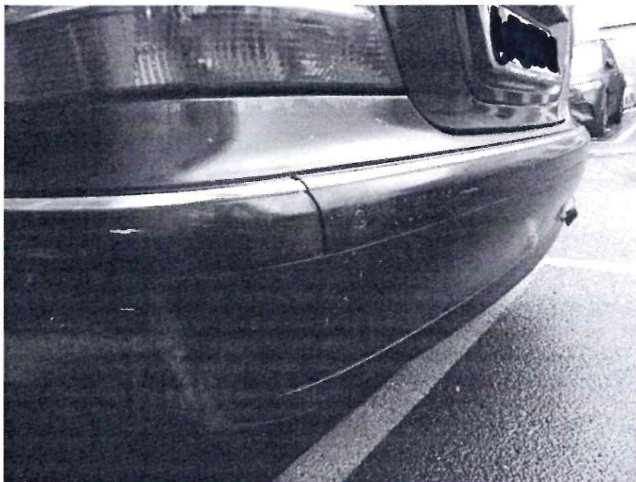
Bild 10 : Weitere Verkratzungen am hinteren Stoßfänger
