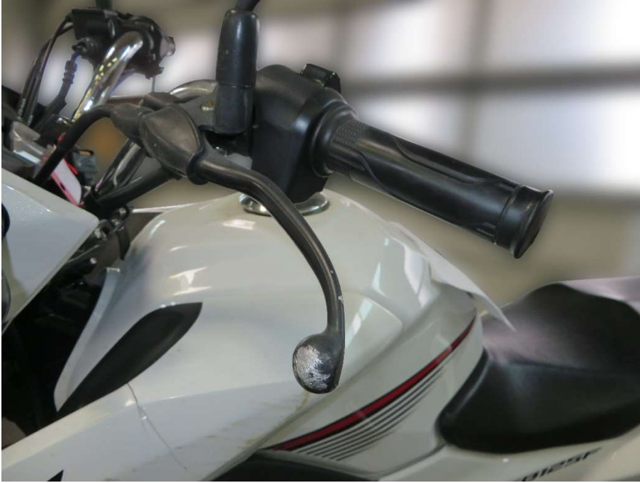
Kupplungshebel verbogen und beschädigt
