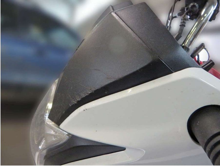
Scheinwerferverkleidung und -maske beschädigt und verkratzt
