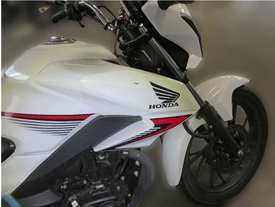
Seitenverkleidung vorne rechts Befestigung mangelhaft und verkratzt
