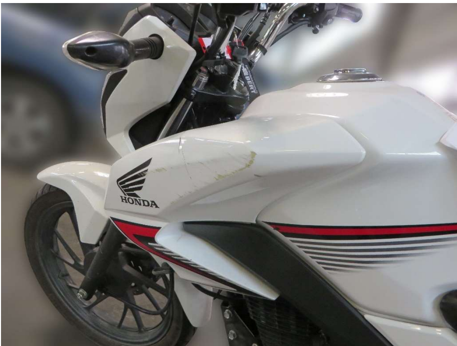
Seitenverkleidung vorne links Befestigung mangelhaft, gebrochen und stark verkratzt
