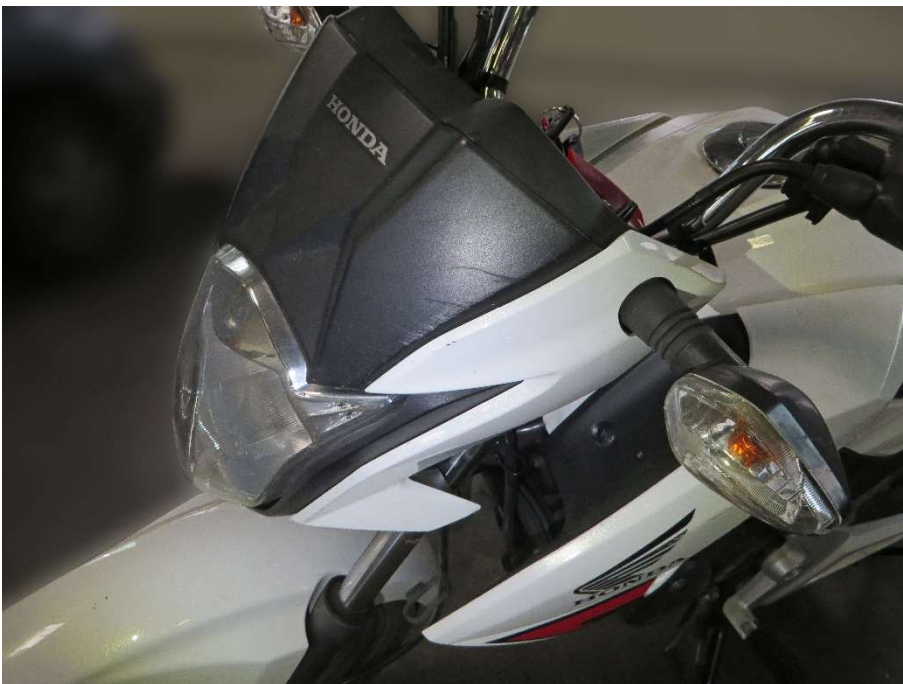
Scheinwerferverkleidung und -maske beschädigt und verkratzt
