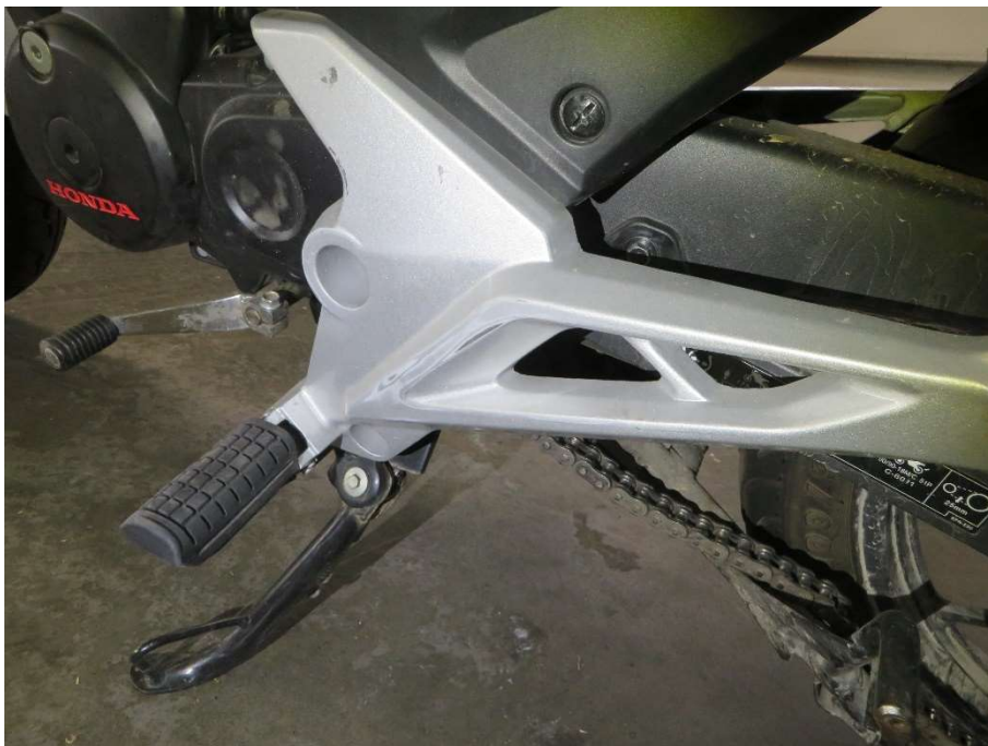
Fußrastenplatte links beschädigt und Befestigung mangelhaft
