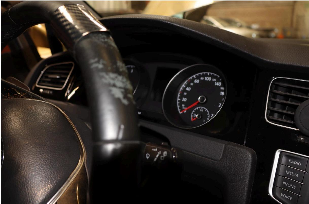
Bild 21: Lenkrad Material abgetragen
