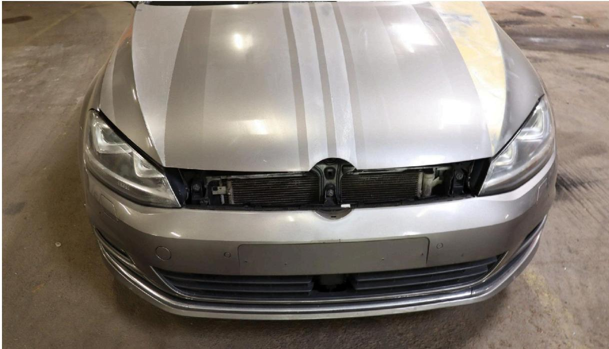
Bild 5: Kühlergrill fehlt; Motorhaube nicht sach- und fachgerecht lackiert
