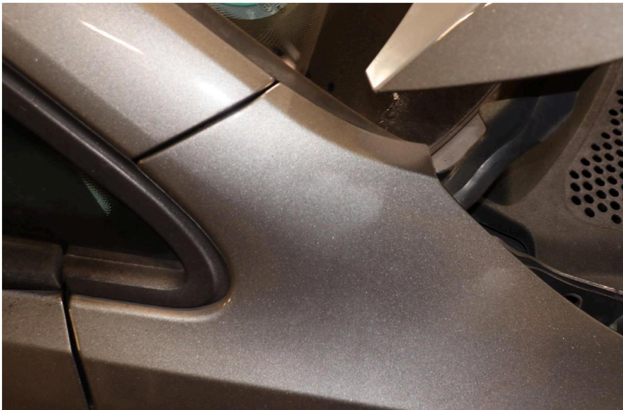
Bild 14: Sprühnebel Kotflügel rechts
