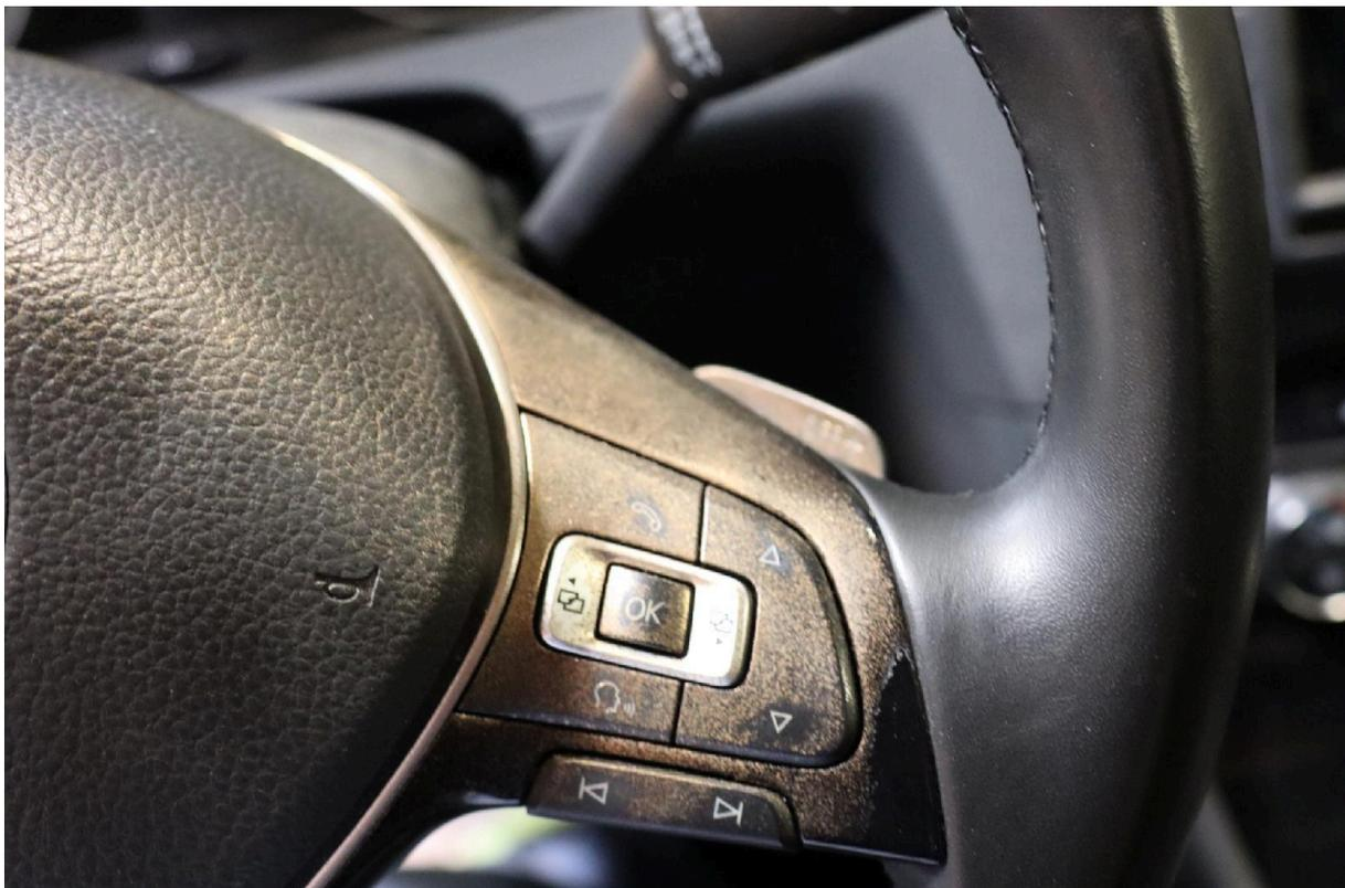
Bild 20: Funktionstasten Lenkrad mit Schaltwippe nicht sach- und fachgerecht lackiert
