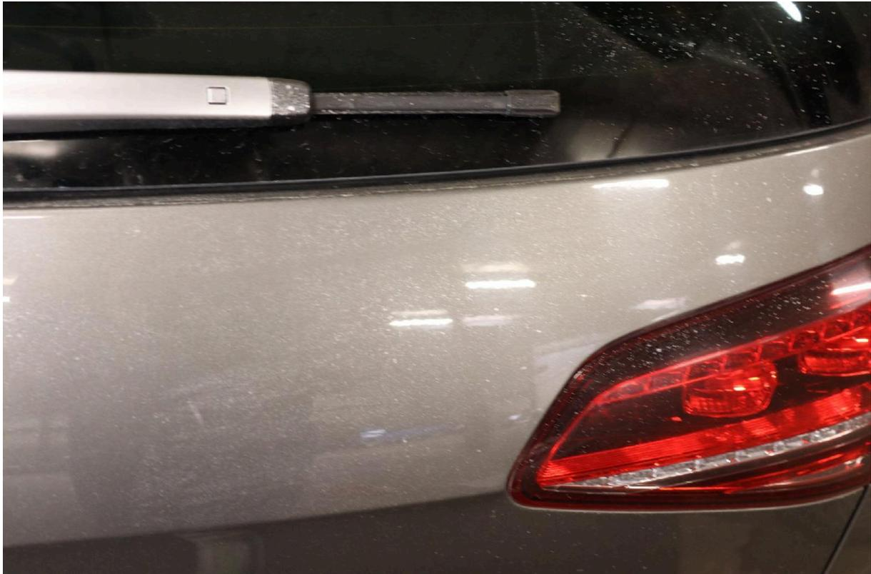
Bild 9: Sprühnebel an Heckklappe, Heckscheibe und Rückleuchten; Wischerarm hinten lackiert
