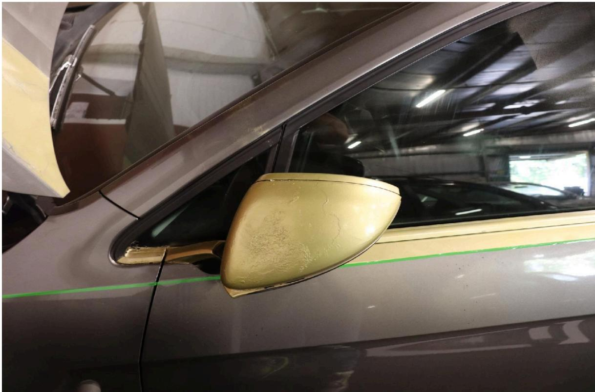
Bild 6: Außenspiegel links und Tür vorn links Zierstreifen nicht sach- und fachgerecht lackiert; Sprühnebel A-Säule
