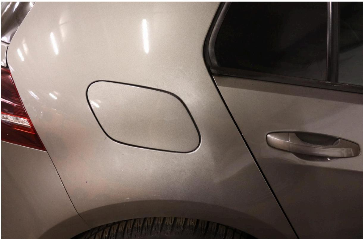
Bild 10: Sprühnebel am Seitenteil rechts
