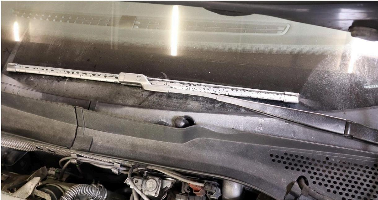
Bild 17: Wischerarm rechts fehlt, links lackiert und Sprühnebel auf der Frontscheibe und der Wasserkastenverkleidung
