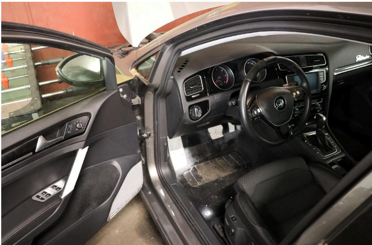
Bild 18: Türverkleidung vorn links, Brems- und Gaspedal sowie Fußstütze nicht sach- und fachgerecht lackiert
