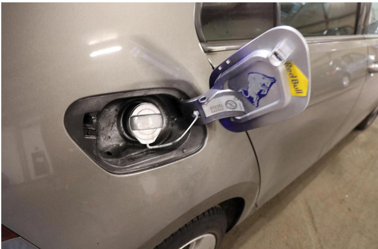
Bild 12: Tankverschluss und Mulde nicht sach- und fachgerecht lackiert
