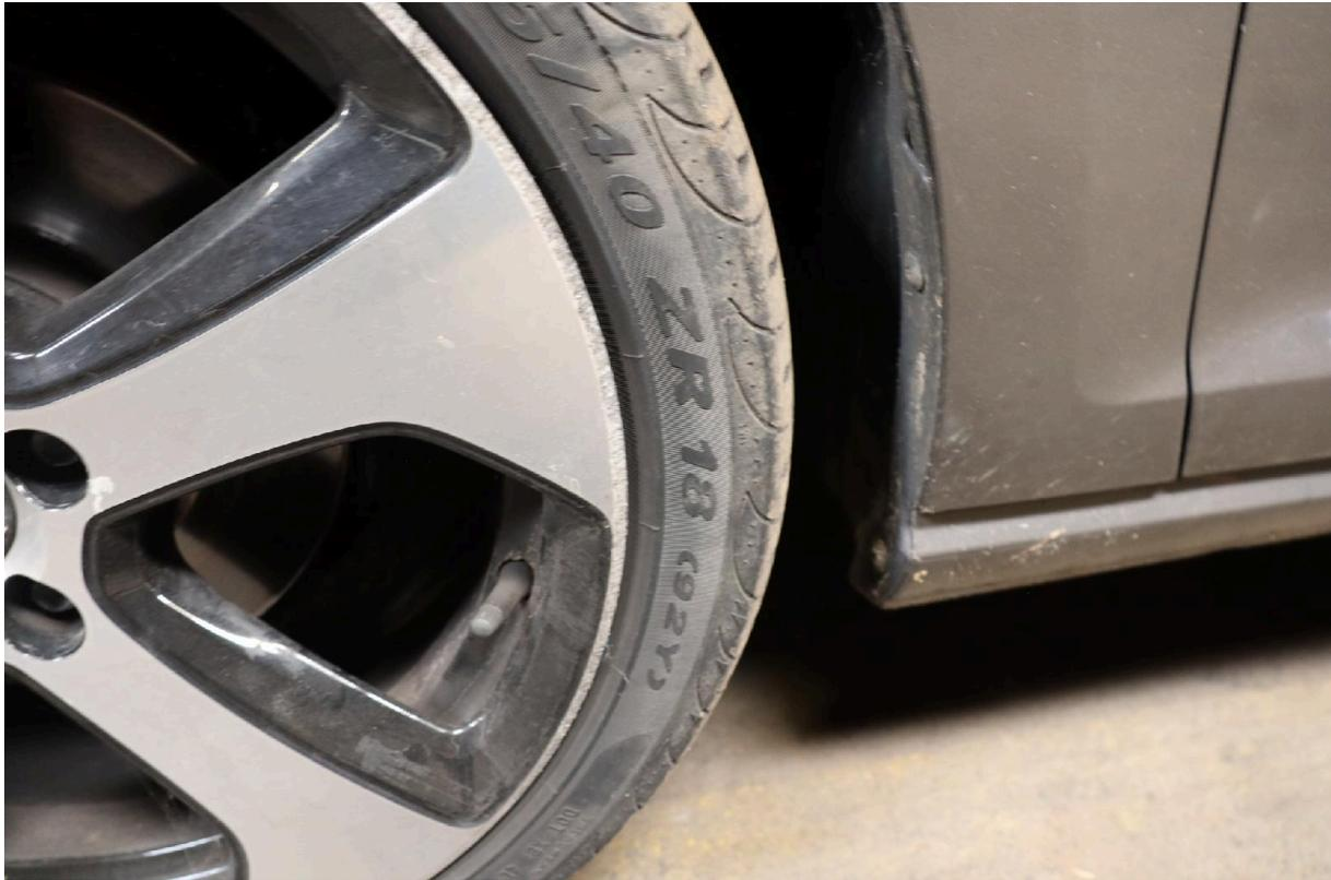
Bild 15: Felge vorn links Materialabtrag
