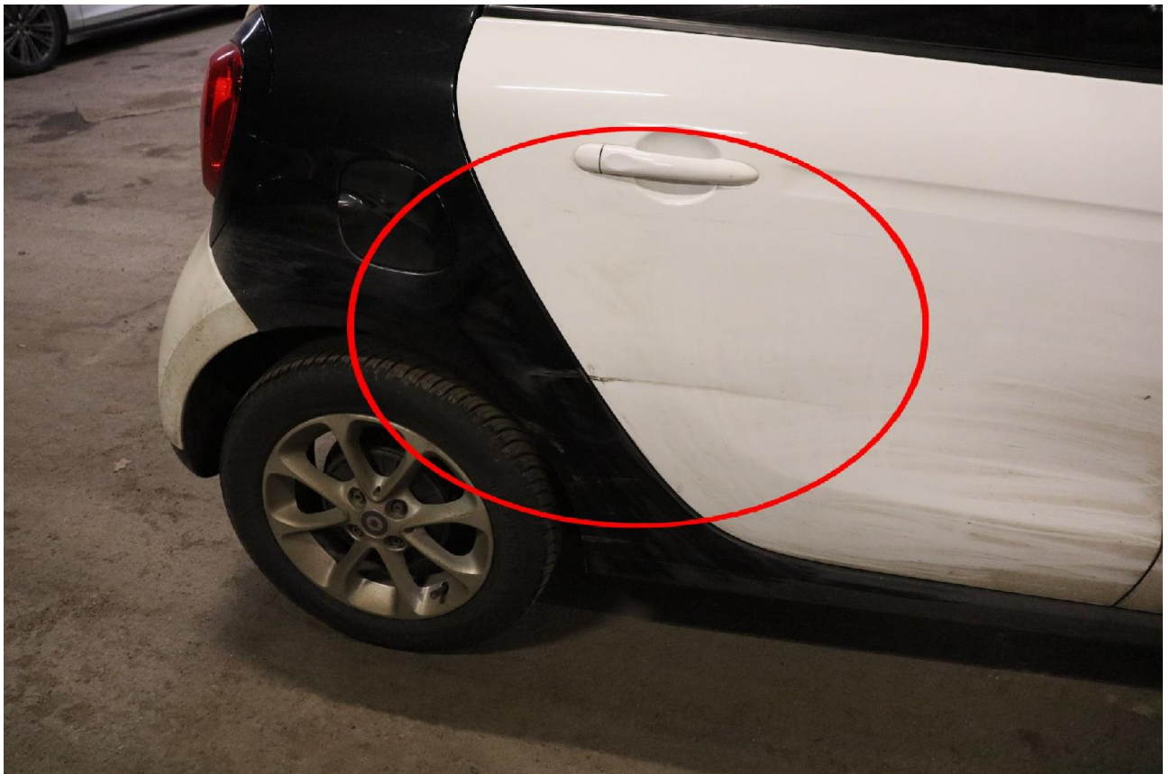
Bild 9: Tür hinten und Seitenteil rechts verformt und verschrammt
