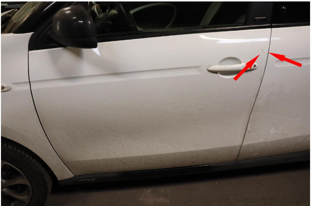
Bild 6: Tür vorn links verschrammt
