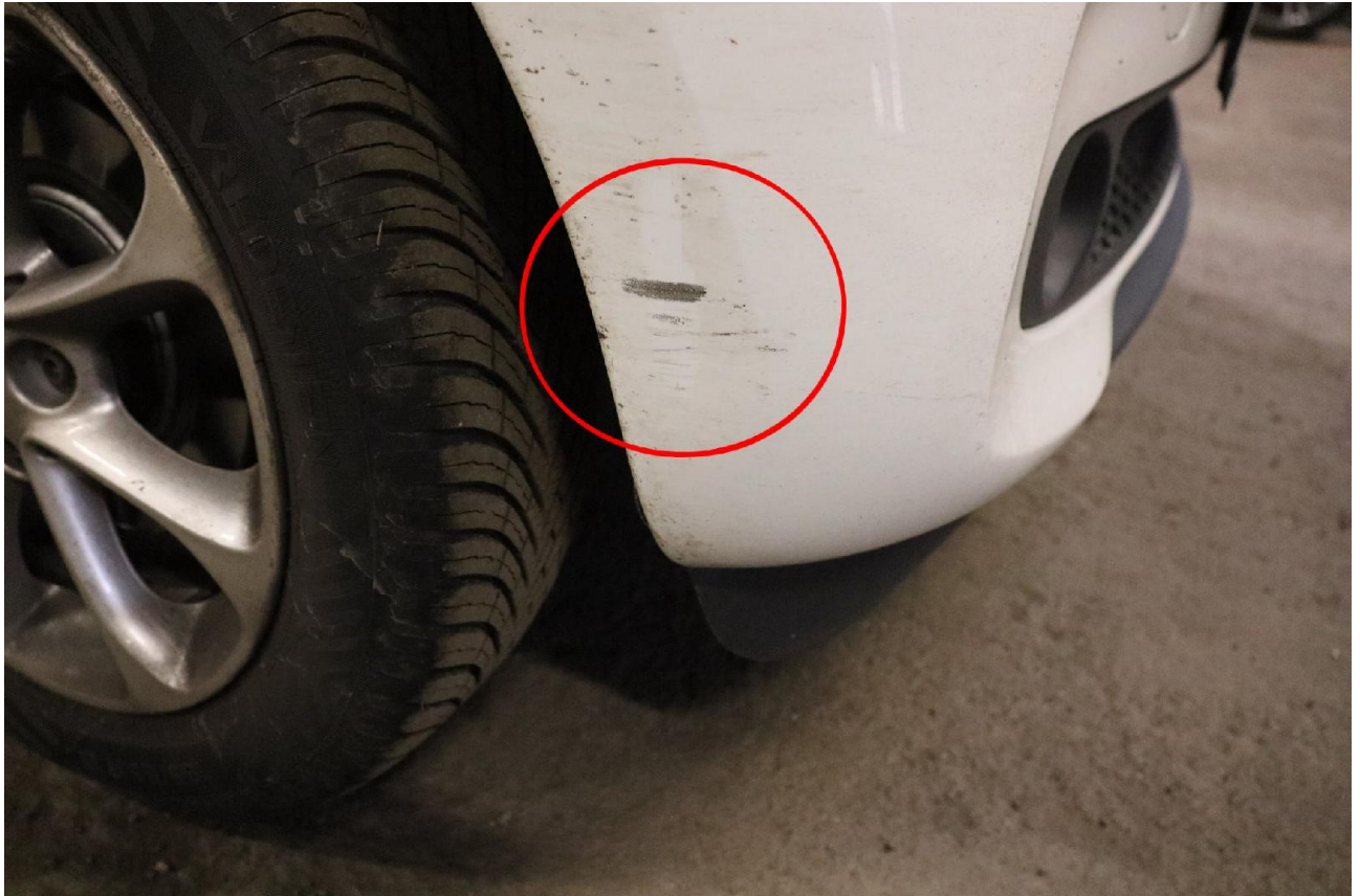
Bild 5: Stoßfängerverkleidung vorn verschrammt
