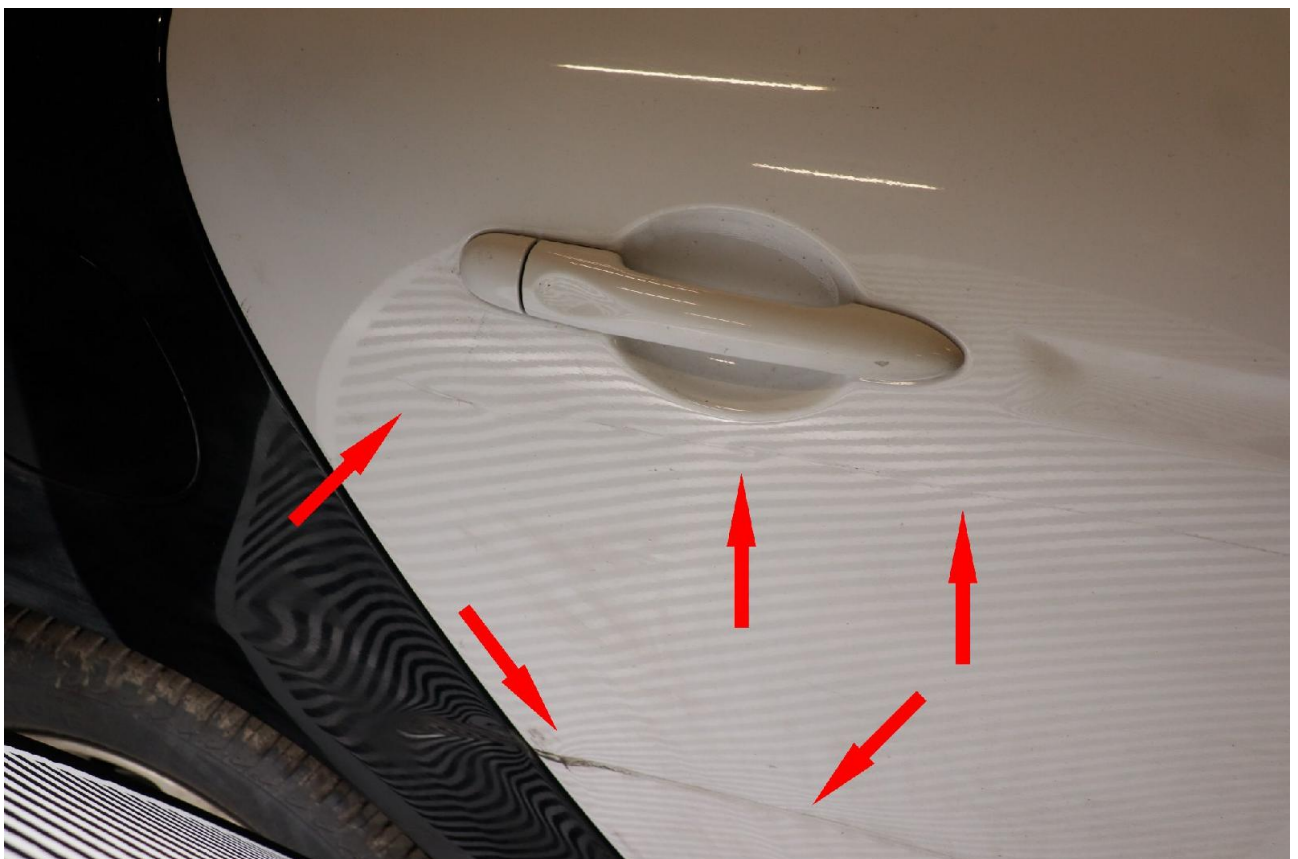
Bild 12: Tür hinten rechts verformt und verschrammt
