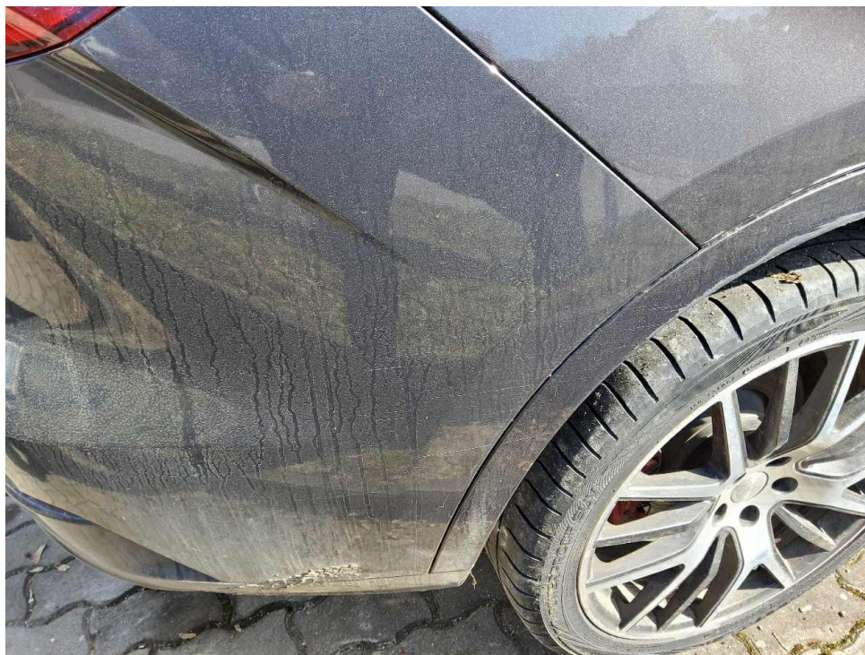
Bild 14 : Seitenteil rechts so wie Radlaufblende rechts und Stoßfängerverkleidung hinten rechts verschrammt
