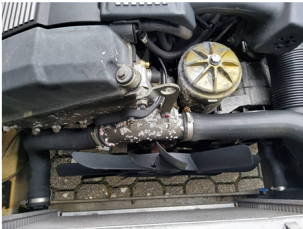
Bild 9 : Kühlmittelverlust im Motorraum ersichtlich
