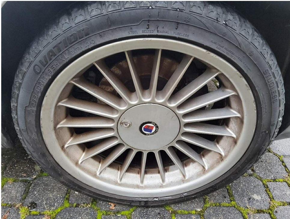
Bild 15 : Leichtmetallfelge vorn rechts verschrammt
