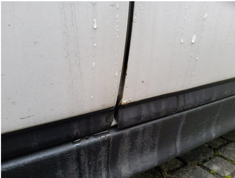
Bild 16 : Korrosionsunterwanderung an den Türen vorhanden
