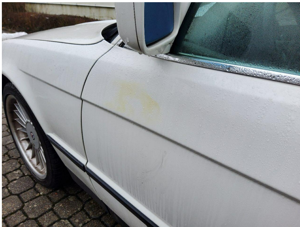
Bild 17 : Tür vorn links Verfärbung in der Lackstruktur vorhanden
