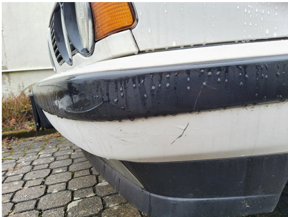
Bild 13 : Stoßfänger vorn sowie Stoßfängerleiste vorn verschrammt
