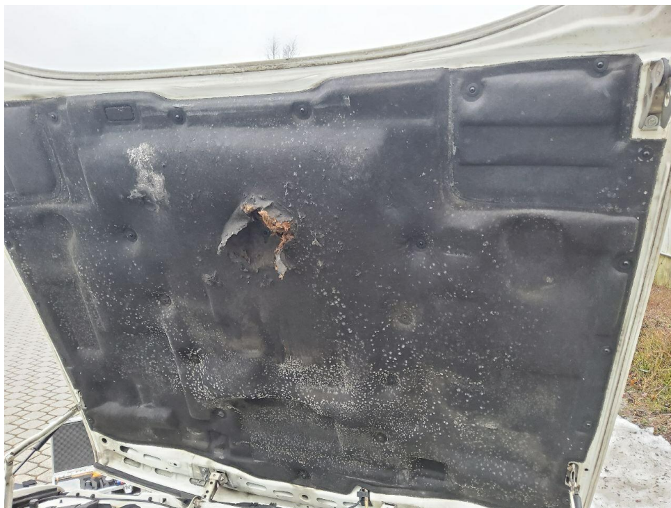
Bild 10 : Dämmmatte Motorhaube angenagt
