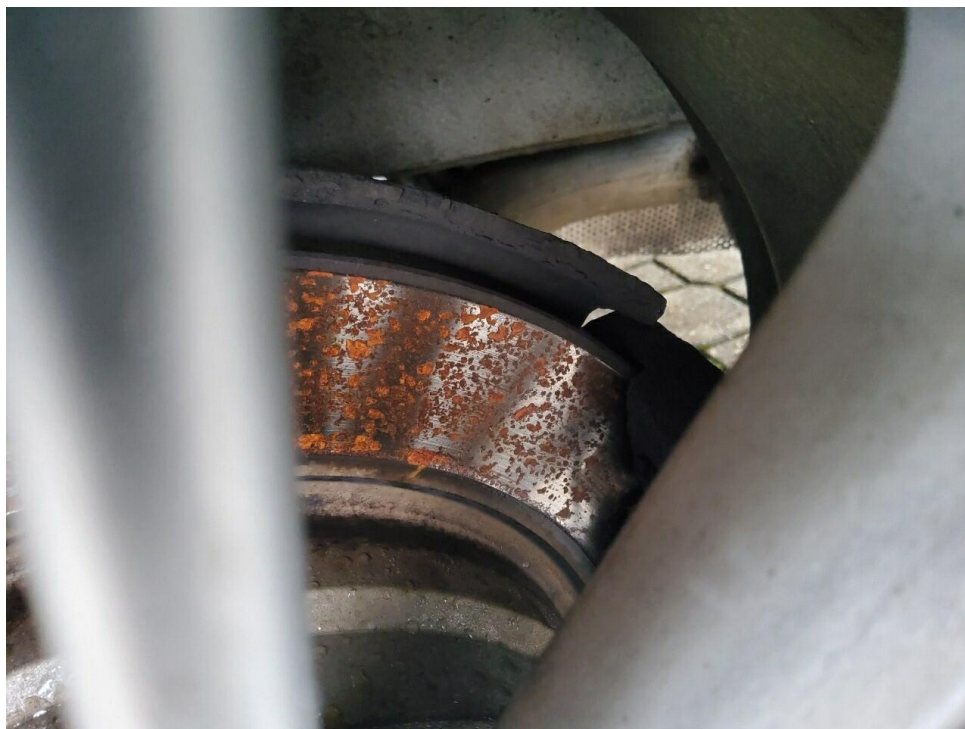
Bild 11 : Standschäden an den Bremsscheiben vorhanden
