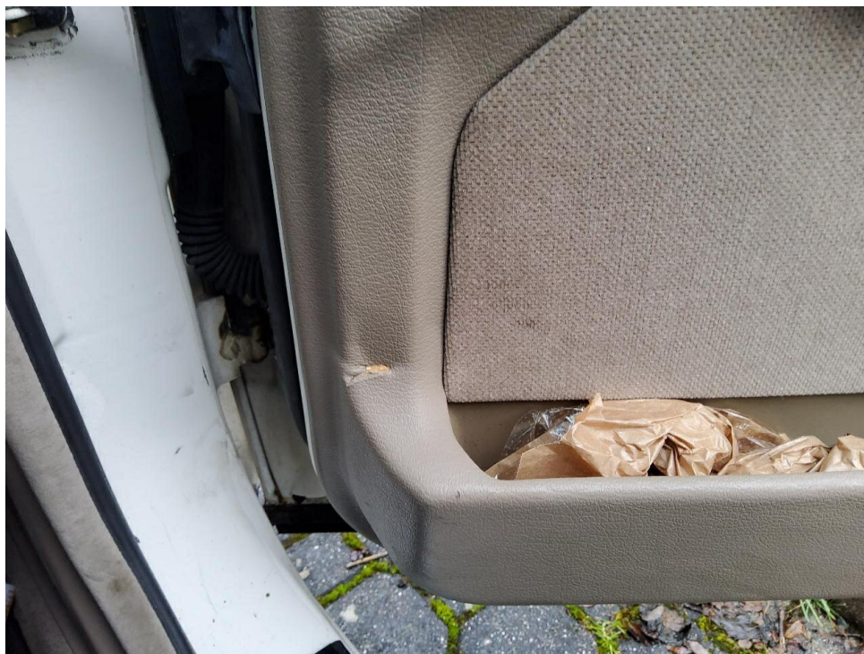
Bild 8 : Türverkleidung vorn rechts eingeschnitten
