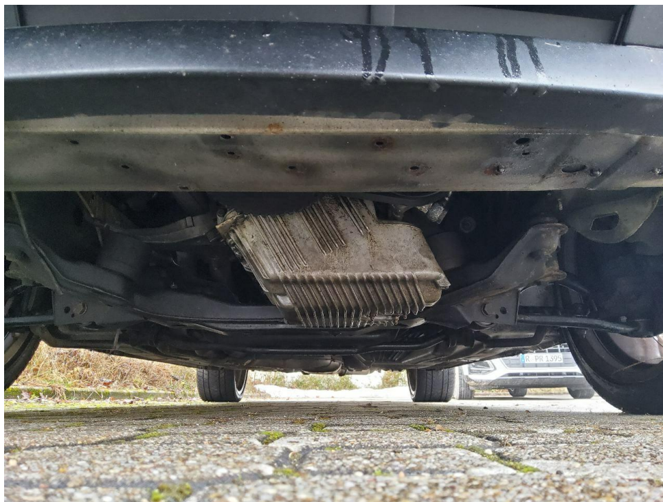
Bild 20 : Ölverlust im Bereich des Motors vorhanden
