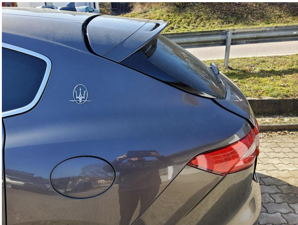
Bild 13 : Heckklappe schließt nicht sauber
