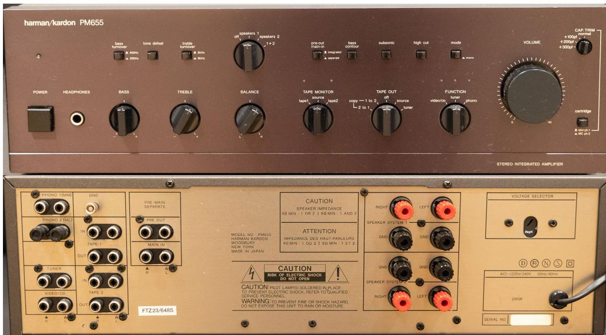
Abbildung 4: Verstärker harman/Kardon PM655, Vorderseite (oben) und Rückseite (unten)
