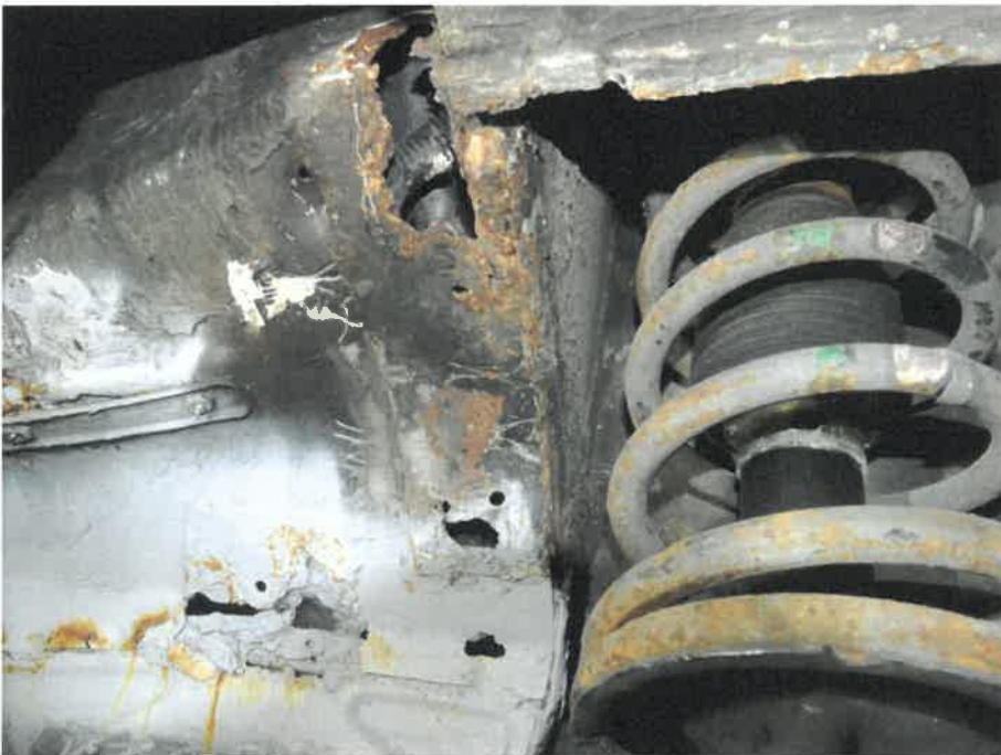
Querträger und Knotenblech vorne links durchgerostet
