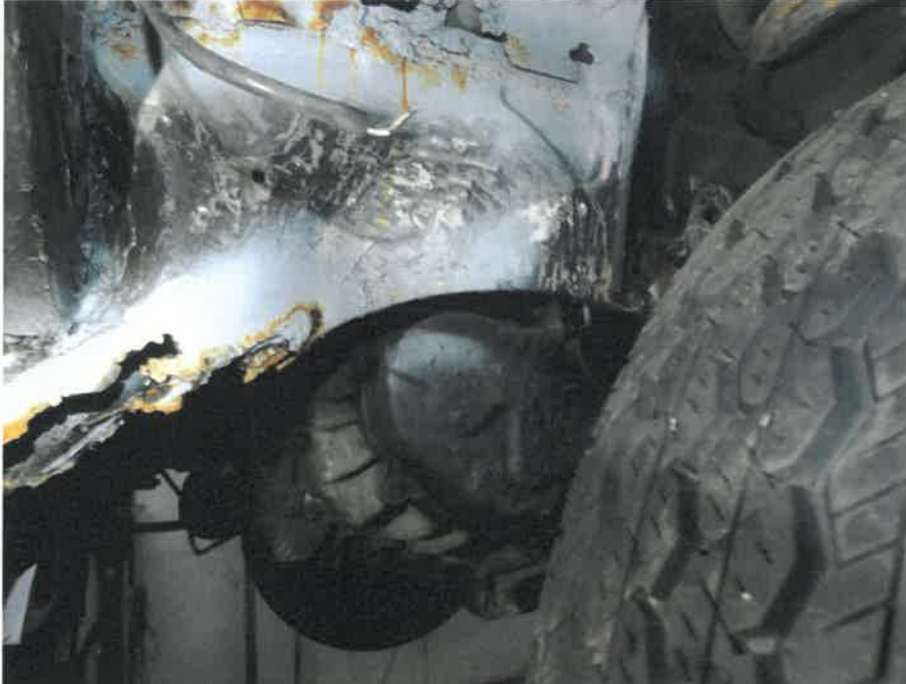
Längsträger links offen durchgerostet
