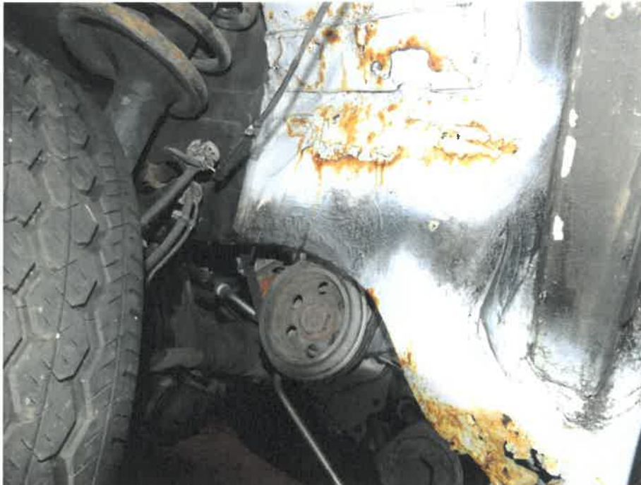
Radlauf vorne rechts stark korrodiert
