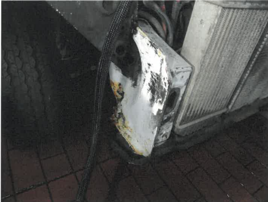
Längsträger vorne rechts korrodiert und verformt und offen durchgerostet
