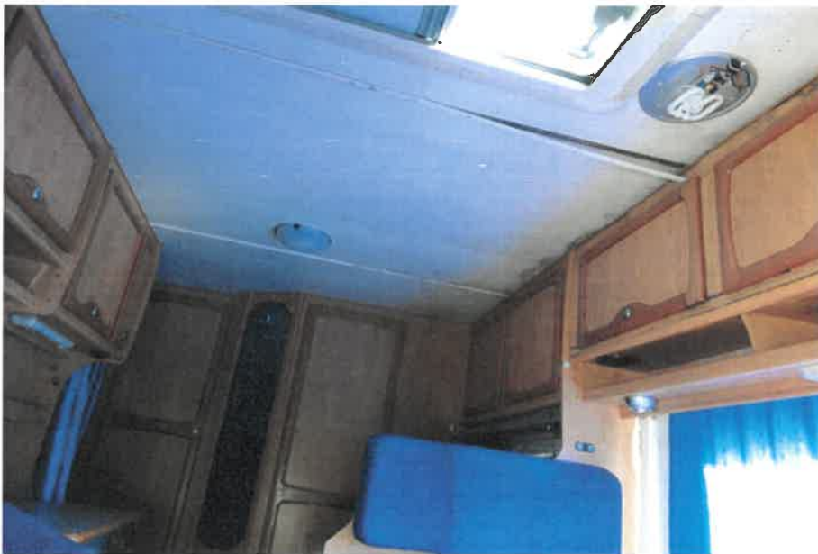
Dachverkleidung mit Wasserflecken
