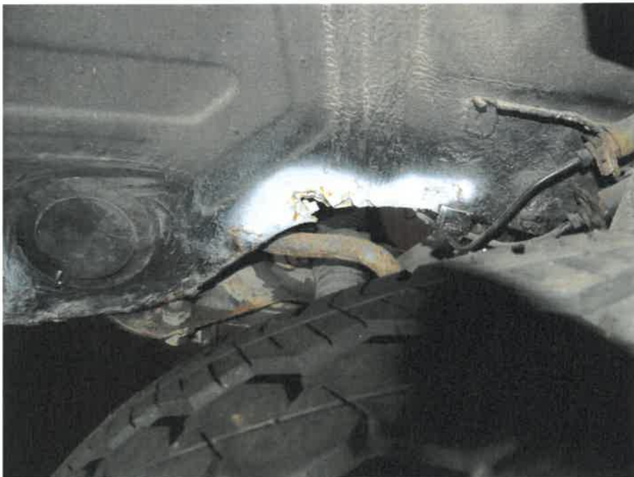
Längsträger rechts über Vorderachse korrodiert und Material abkorrodiert
