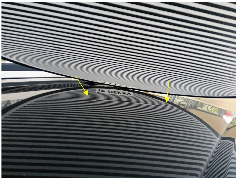
Bild 17 : Dach mehrfach eingedellt
