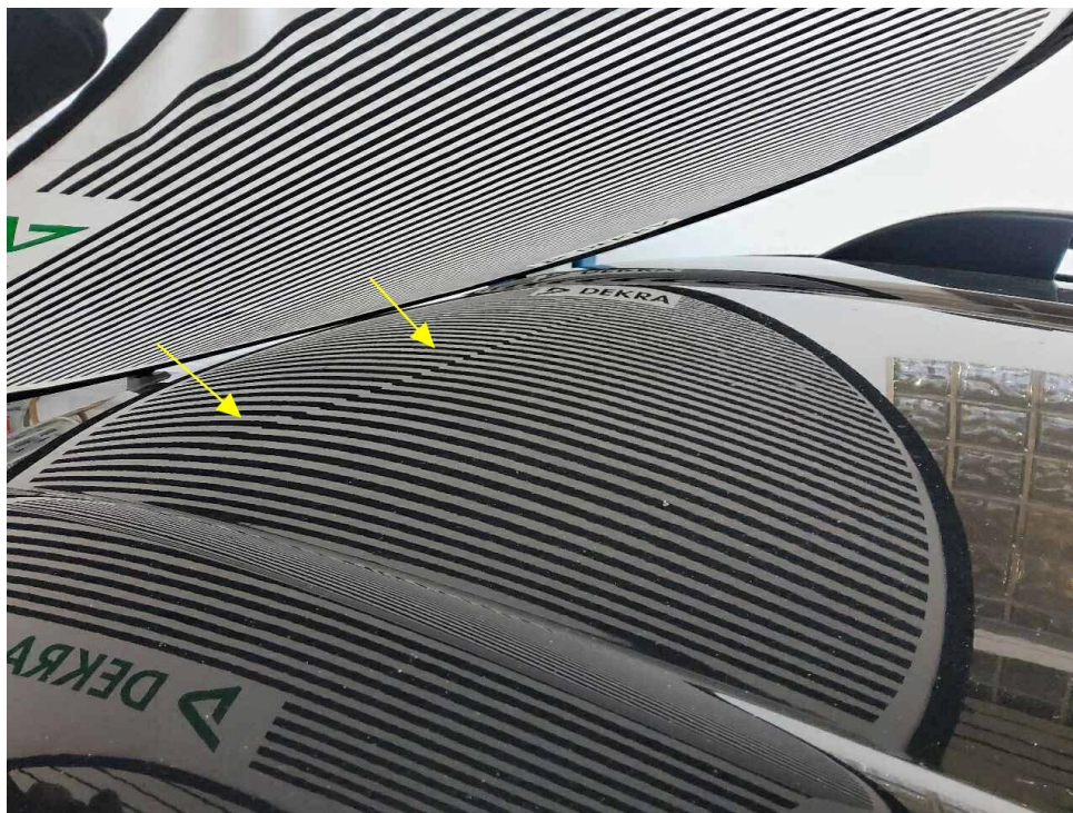
Bild 14 : Dach mehrfach eingedellt
