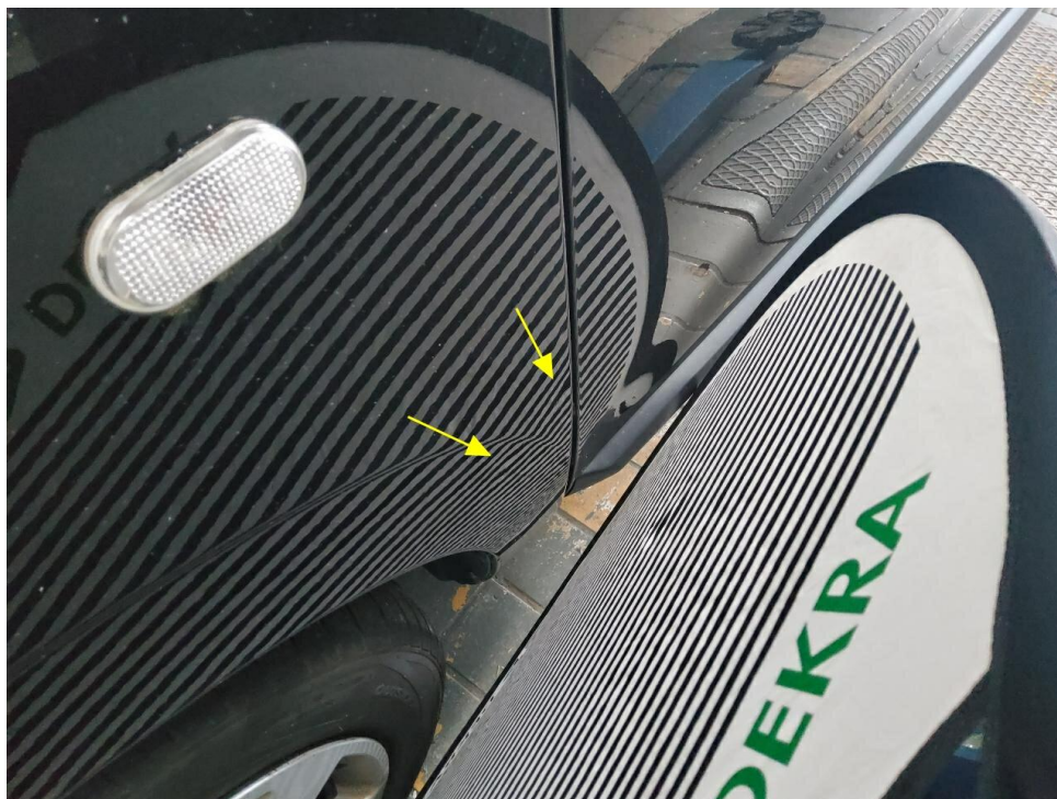
Bild 13 : Kotflügel vorn links eingedrückt
