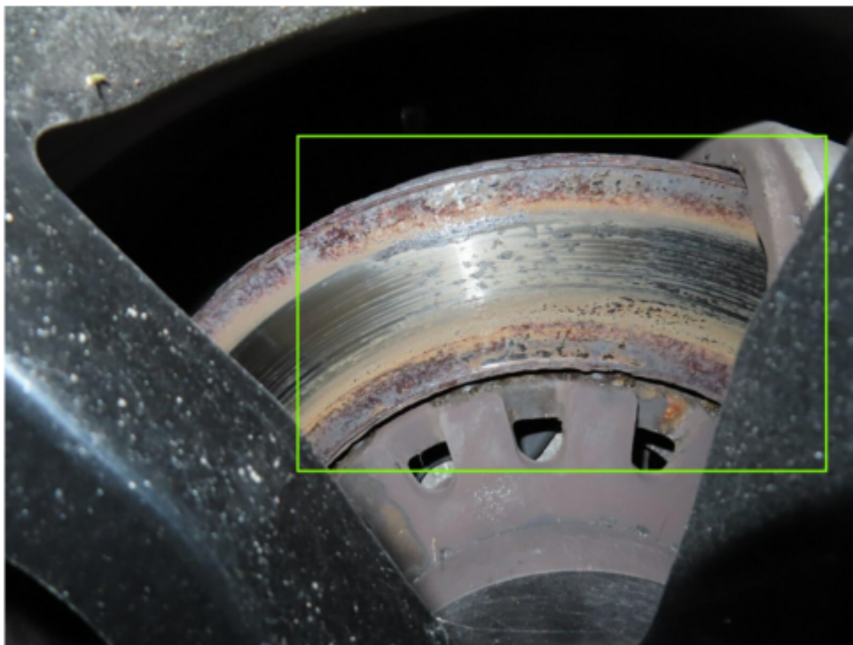
Bild 7 : Bremse der Vorderachse verschließen und stark verrostet
