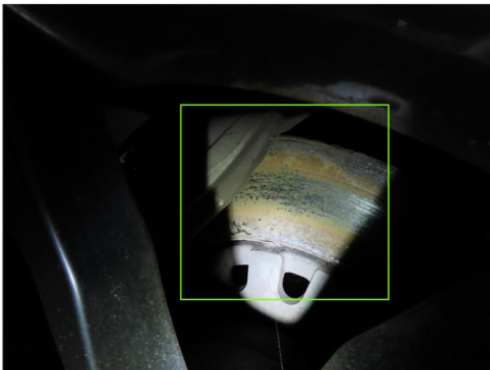
Bild 8 : Bremse der Vorderachse verschließen und stark verrostet
