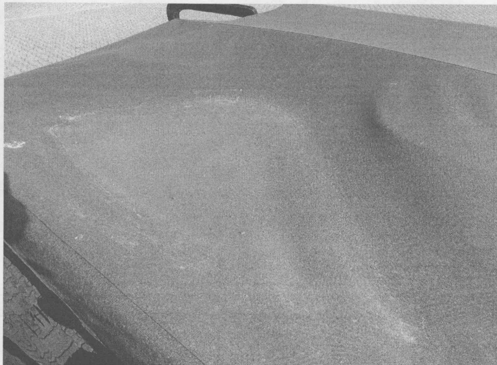
Bild 13 : Fahrzeugdach Flecken / Schimmelbildung
