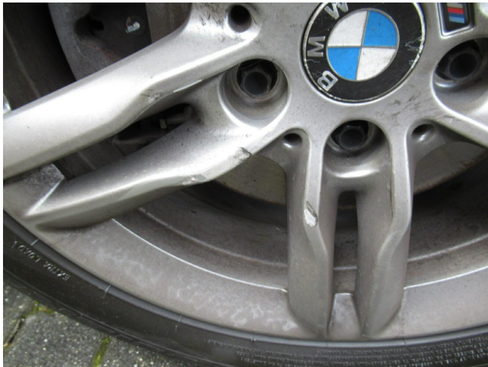
Bild 20 : Felge vorne links Lackierung, zerkratzt, lackieren mit Lackaufbau
