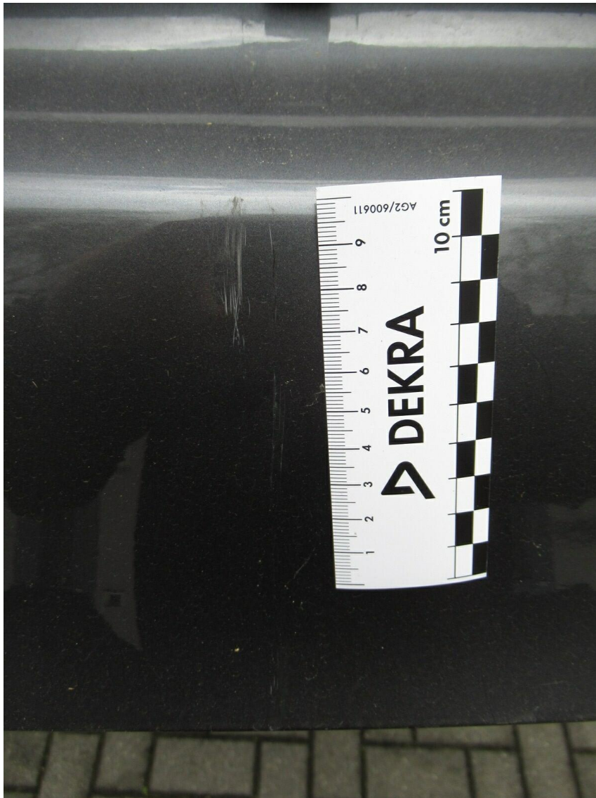
Bild 15 : Heckklappe Lackierung, zerkratzt, lackieren mit Lackaufbau
