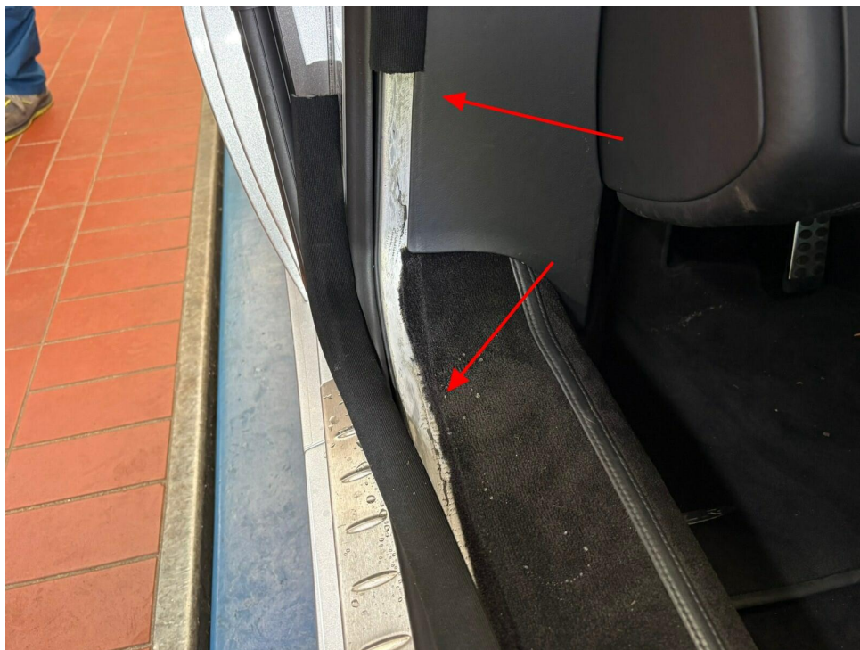
Bild 27 : Türdichtung Einstieg links lose
