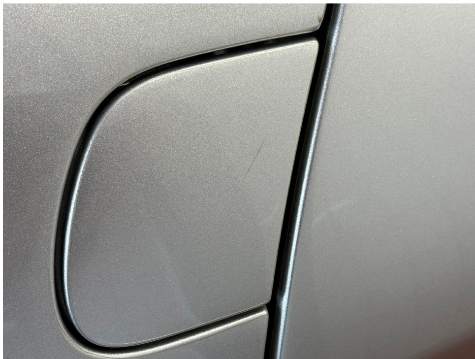
Bild 25 : Türgriff rechts verschrammt
