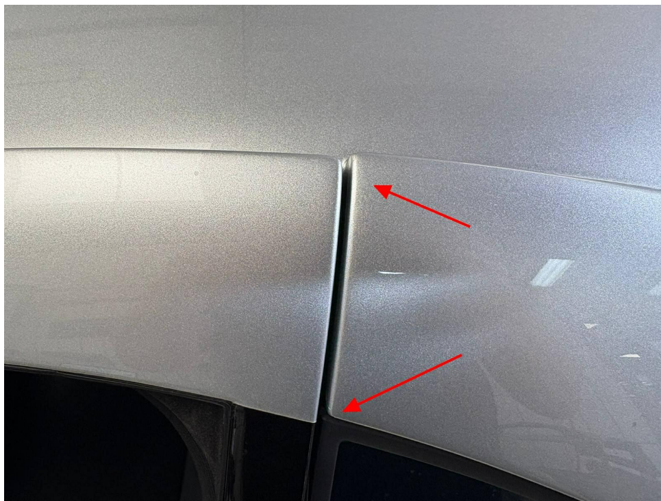
Bild 28 : Tür links nicht korrekt eingepasst
