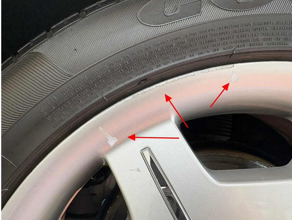
Bild 48 : Felge hinten links verschrammt
