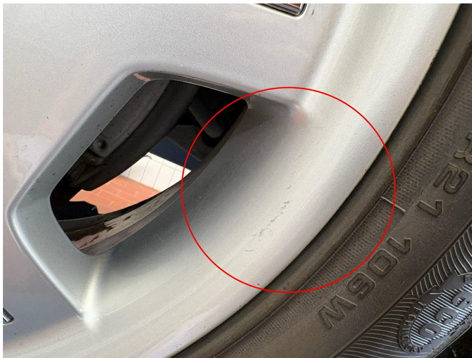
Bild 47 : Felge hinten links verschrammt
