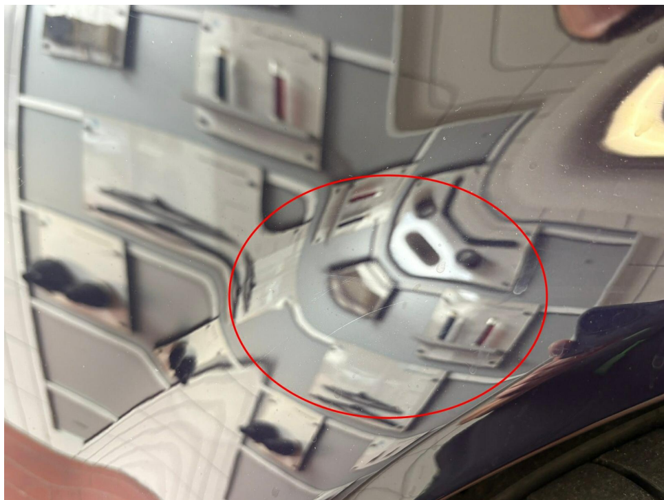
Bild 41 : Seitenteil hinten links verschrammt
