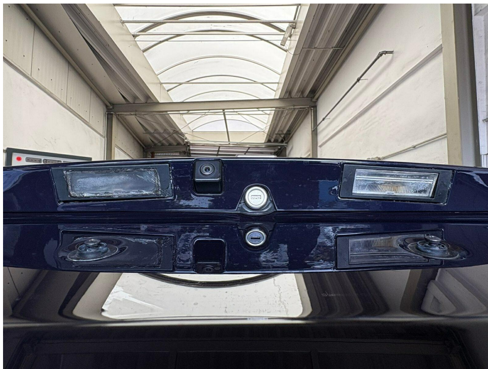
Bild 26 : Kennzeichenbeleuchtung links Leuchte defekt
