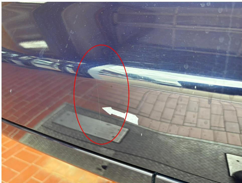
Bild 35 : Seitenteil hinten links verschrammt
