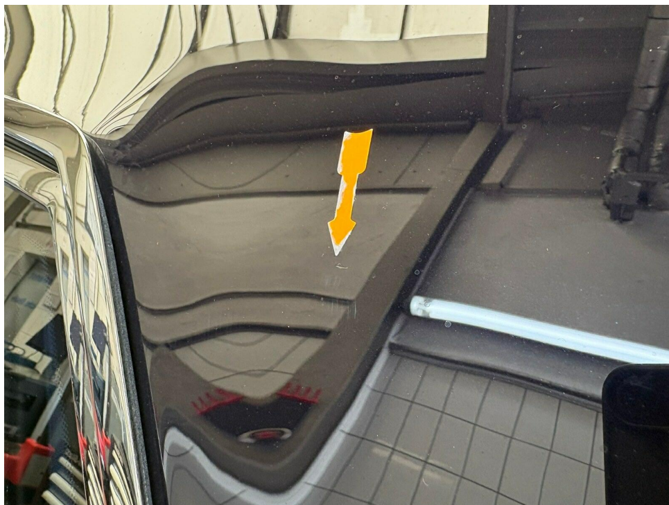
Bild 34 : Seitenteil hinten links verschrammt
