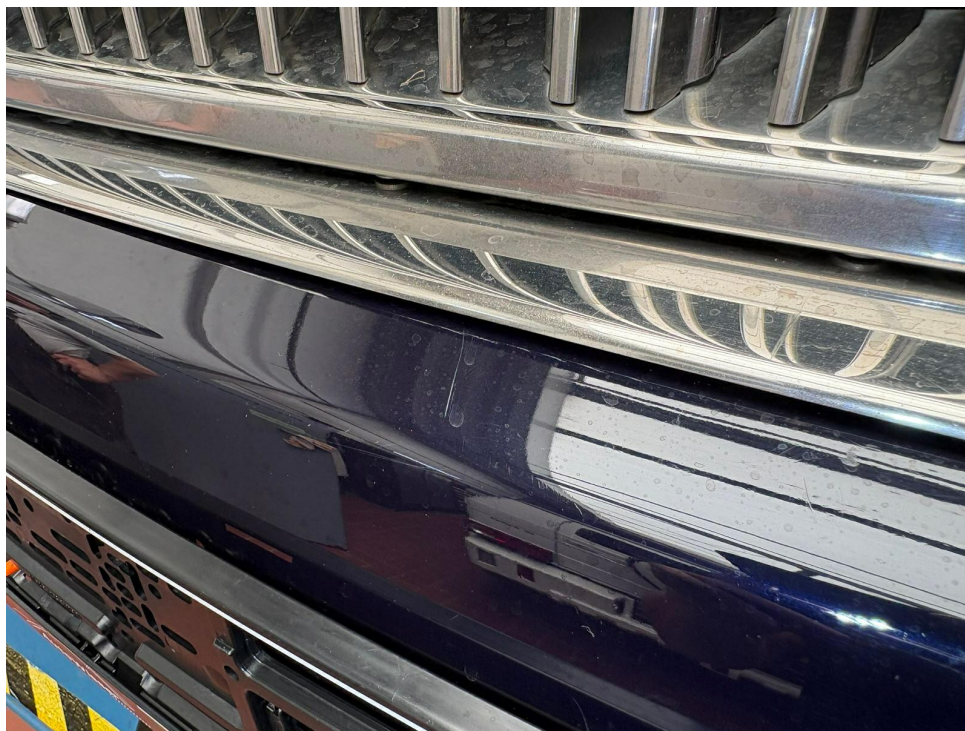
Bild 45 : Stoßfänger vorne verschrammt
