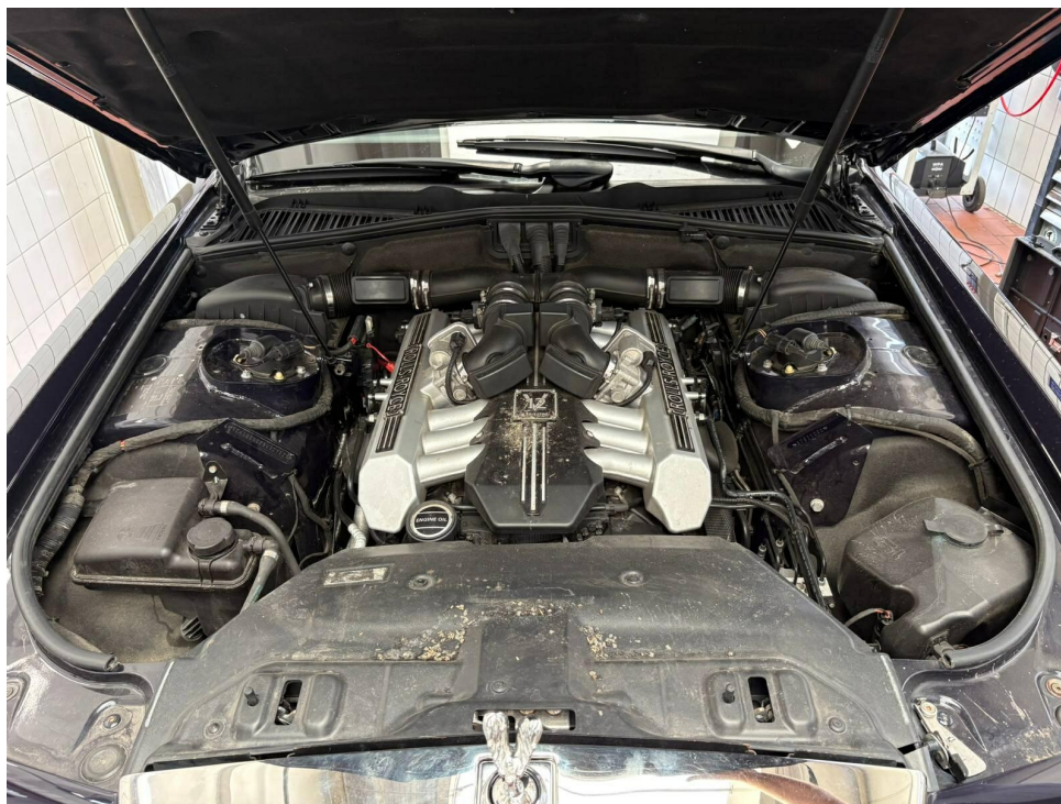
Bild 27 : Motorraum mit Tierkot verunreinigt
