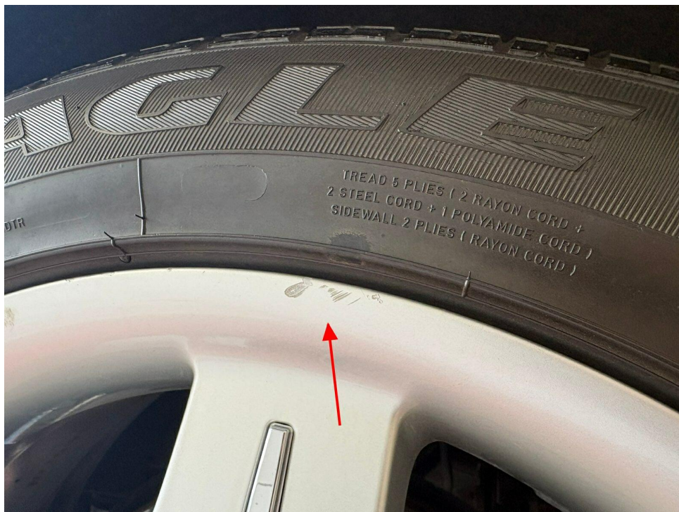
Bild 50 : Felge hinten rechts verschrammt
