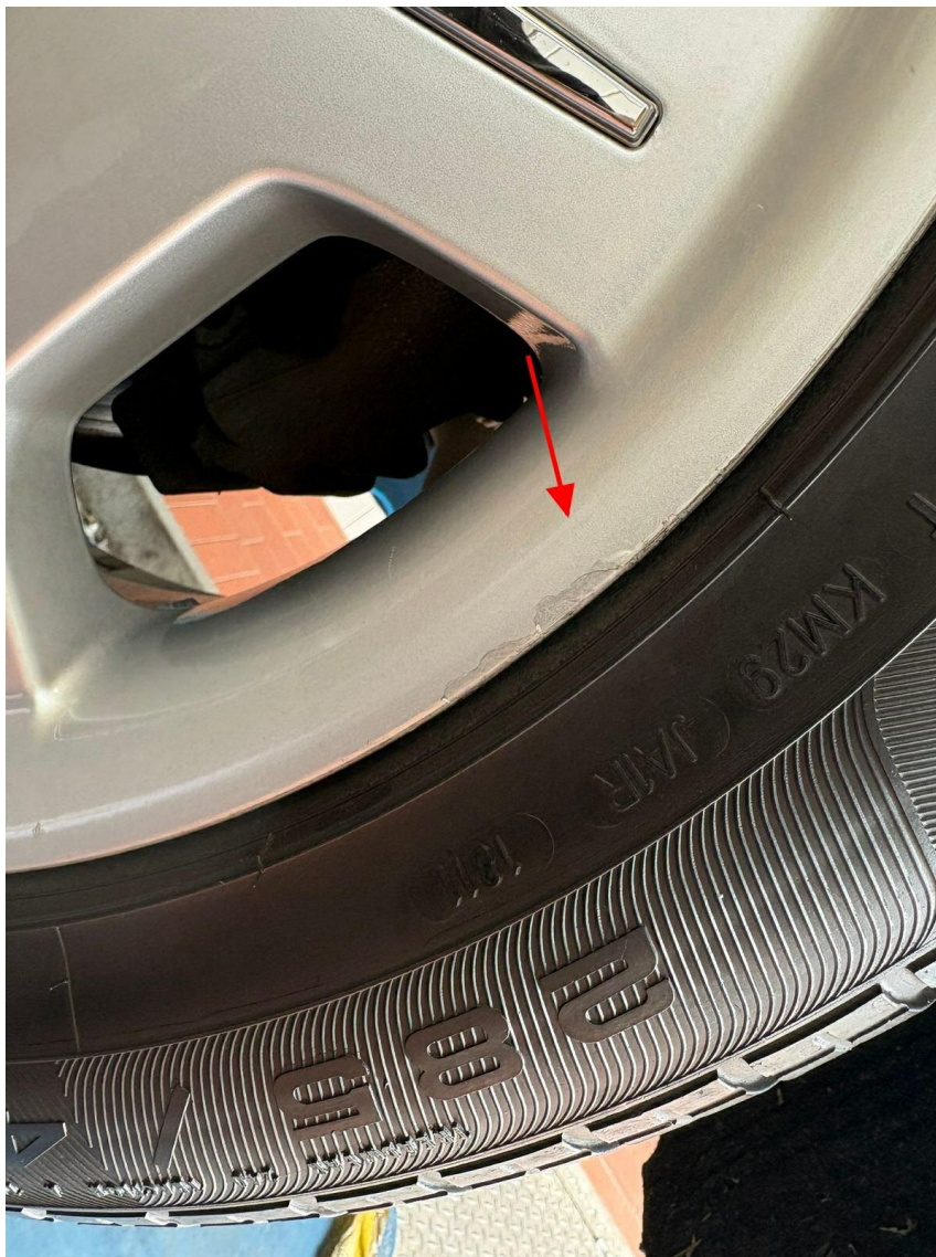
Bild 49 : Felge hinten links verschrammt
