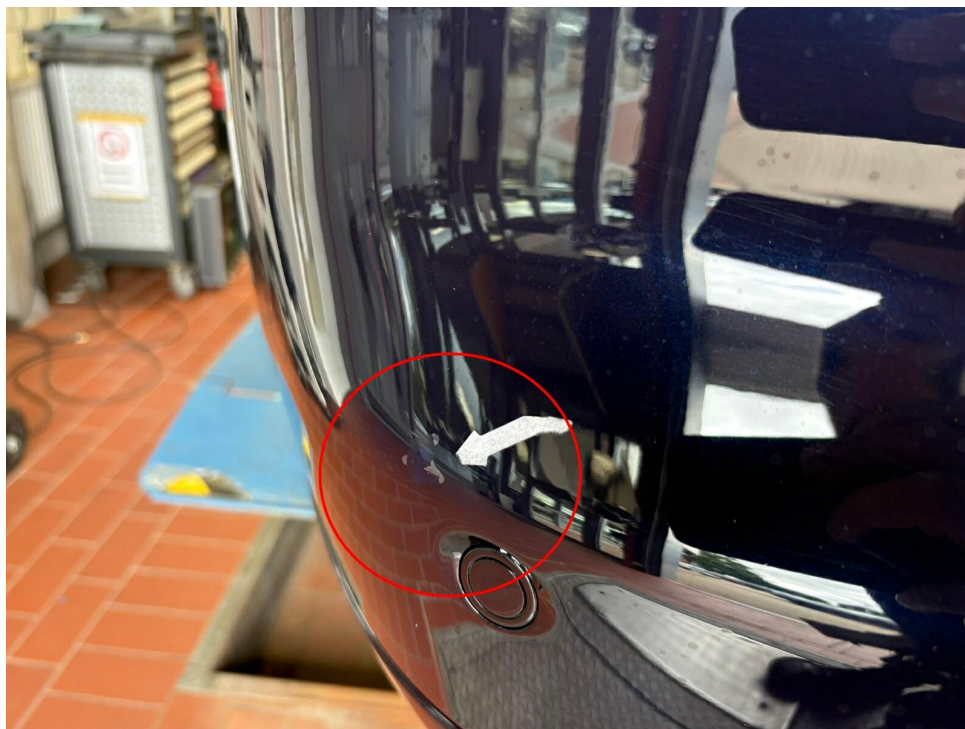
Bild 36 : Stoßfänger hinten mehrfach verschrammt
