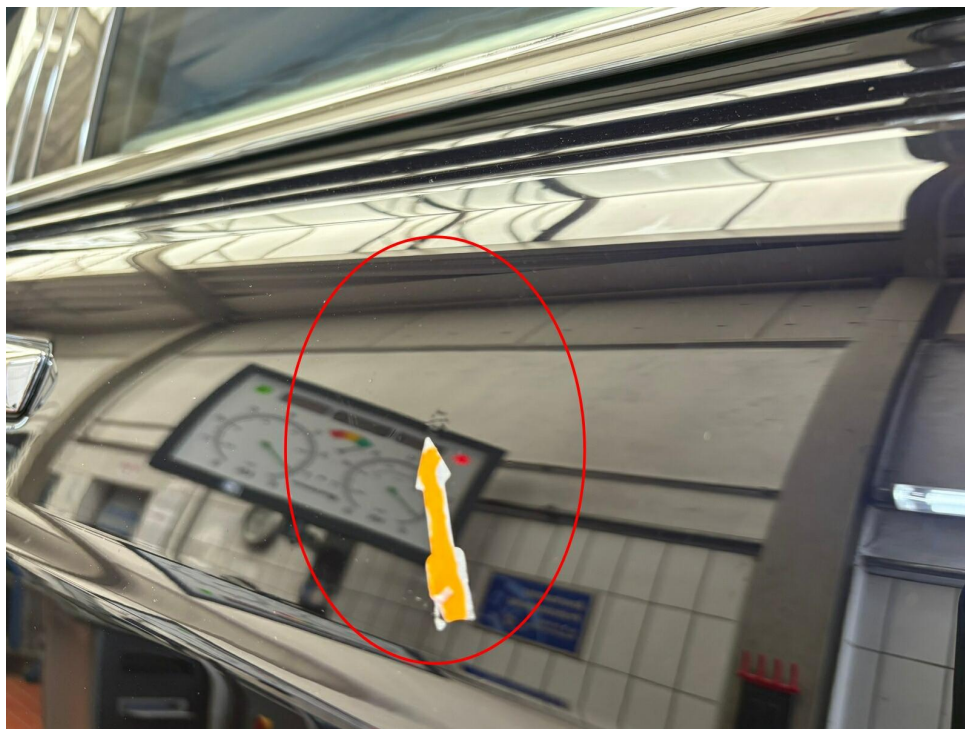
Bild 40 : Tür hinten links verschrammt
