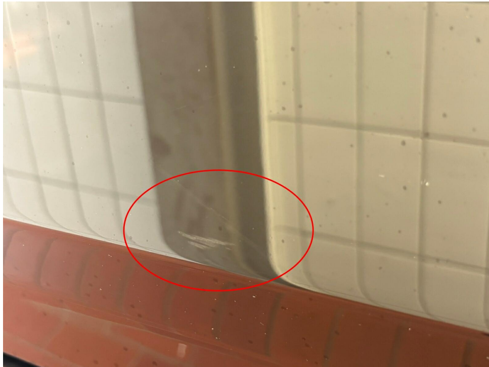
Bild 42 : Seitenteil hinten rechts verschrammt
