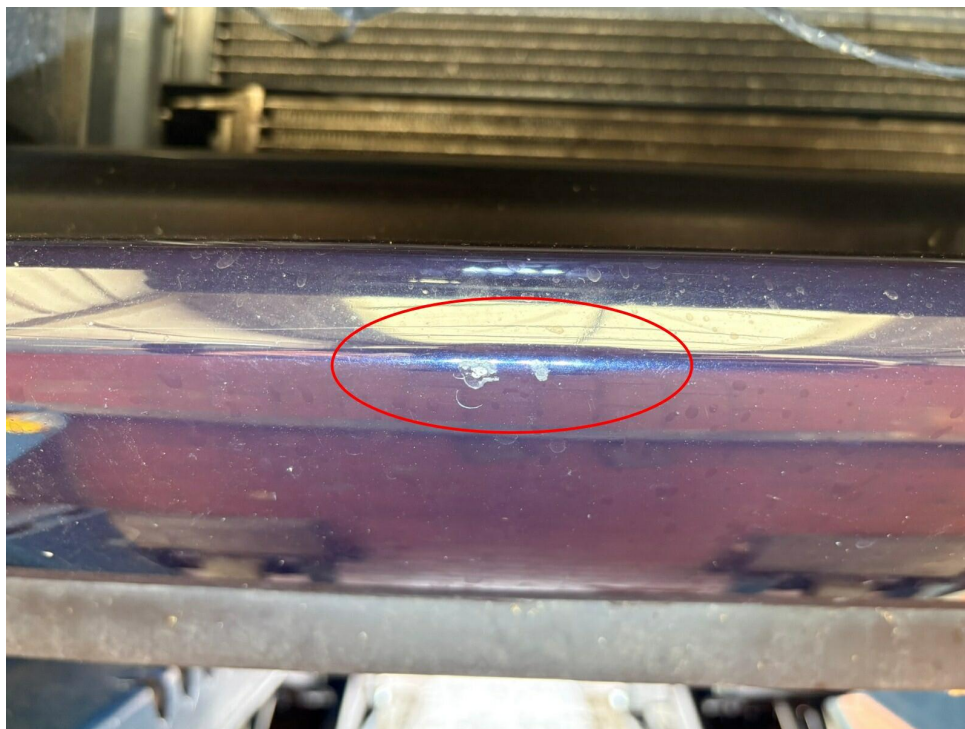
Bild 46 : Stoßfänger vorne verschrammt
