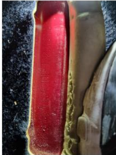
Bild 11 - zeigt eingeschlagene FIN des beschriebenen Fahrzeuges.
