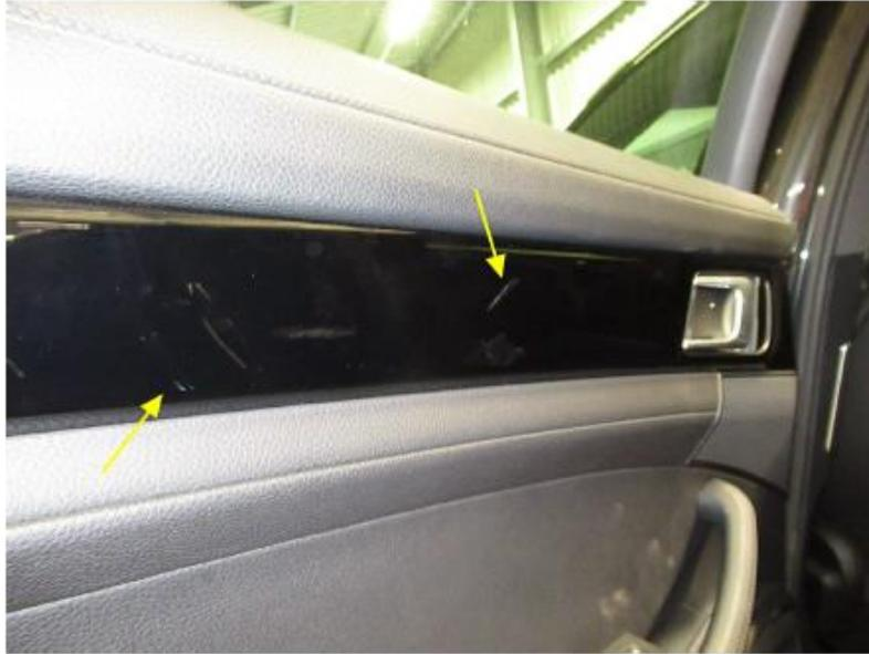
Bild 19: Hintertür links Blende innen zerkratzt
