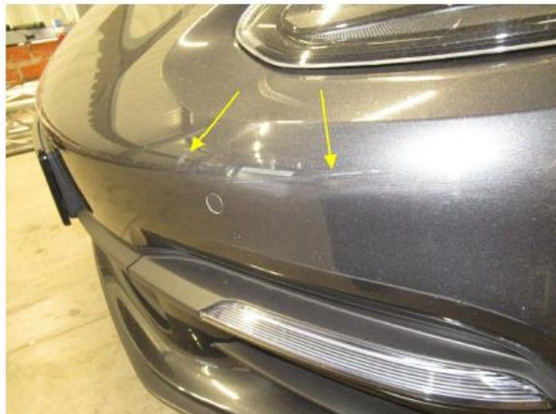
Bild 16 : Stoßstange vorn links zerkratzt
