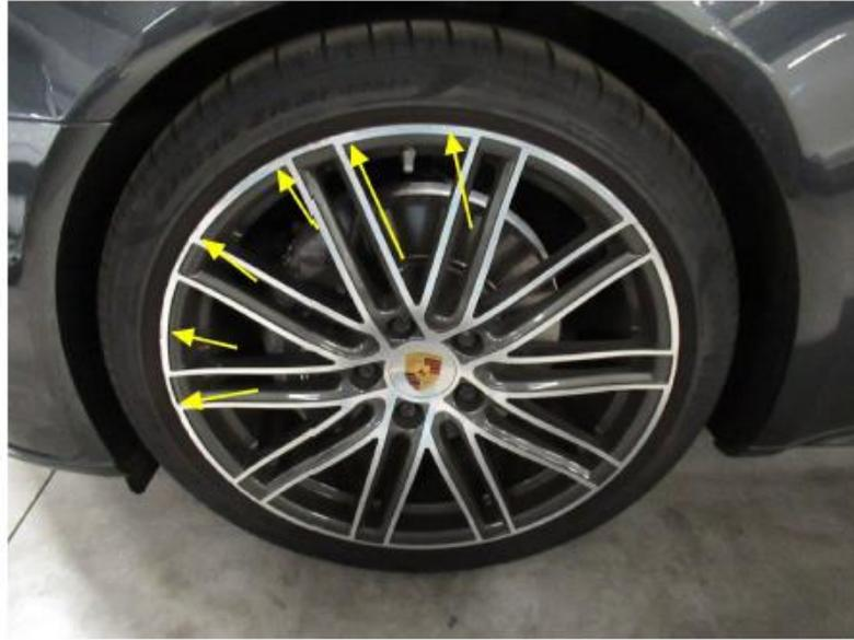
Bild 7 : Felge vorn links zerkratzt
