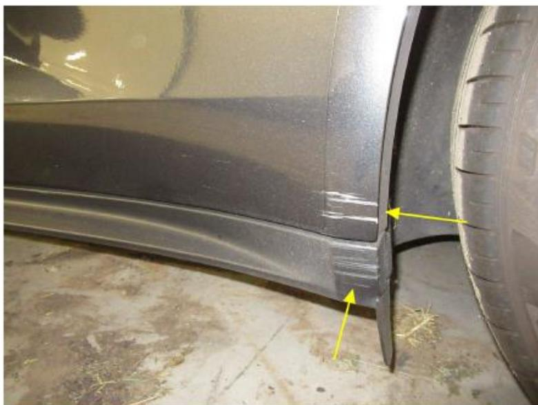
Bild 18 : Schweller und Tür hinten links unten zerkratzt
