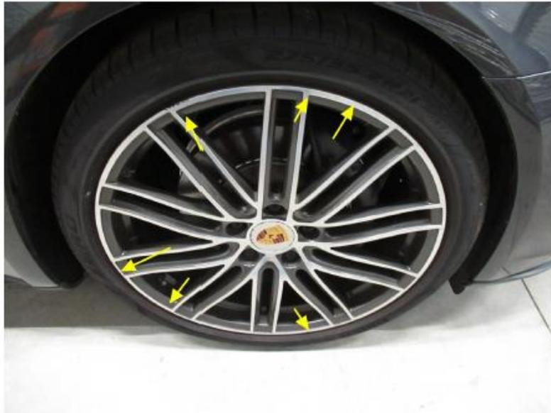
Bild 13 : Felge vorn rechts zerkratzt
