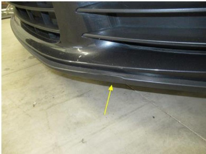
Bild 17 : Spoiler vom links deformiert
