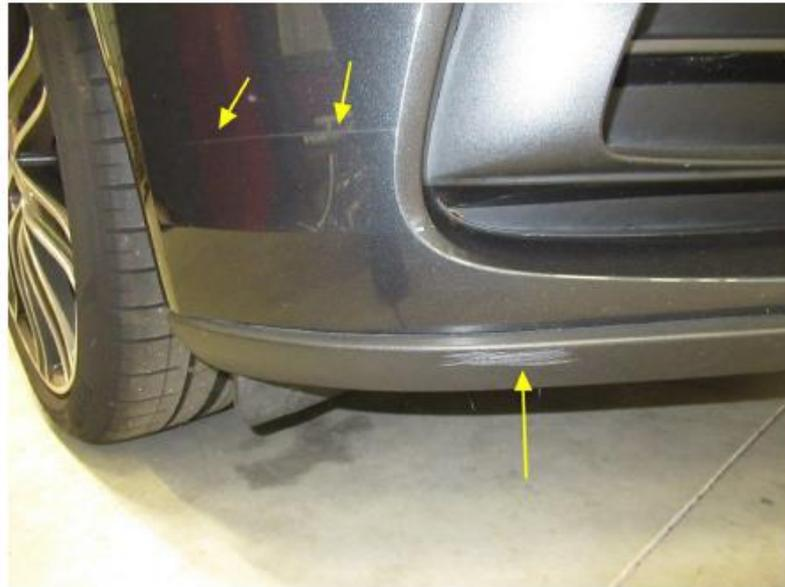
Bild 15 : Spoiler und Stoßstange vorn rechts zerkratzt
