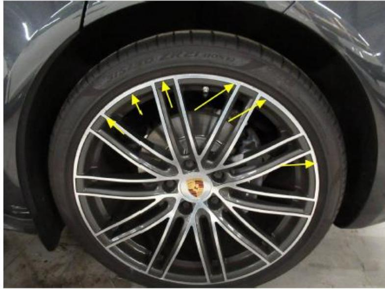
Bild 9 : Felge hinten links zerkratzt
