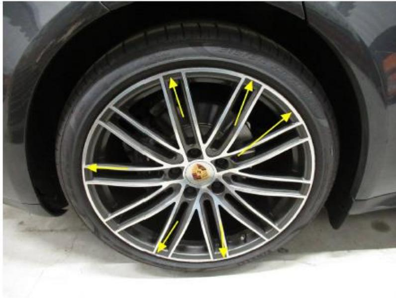
Bild 11 : Felge hinten rechts zerkratzt
