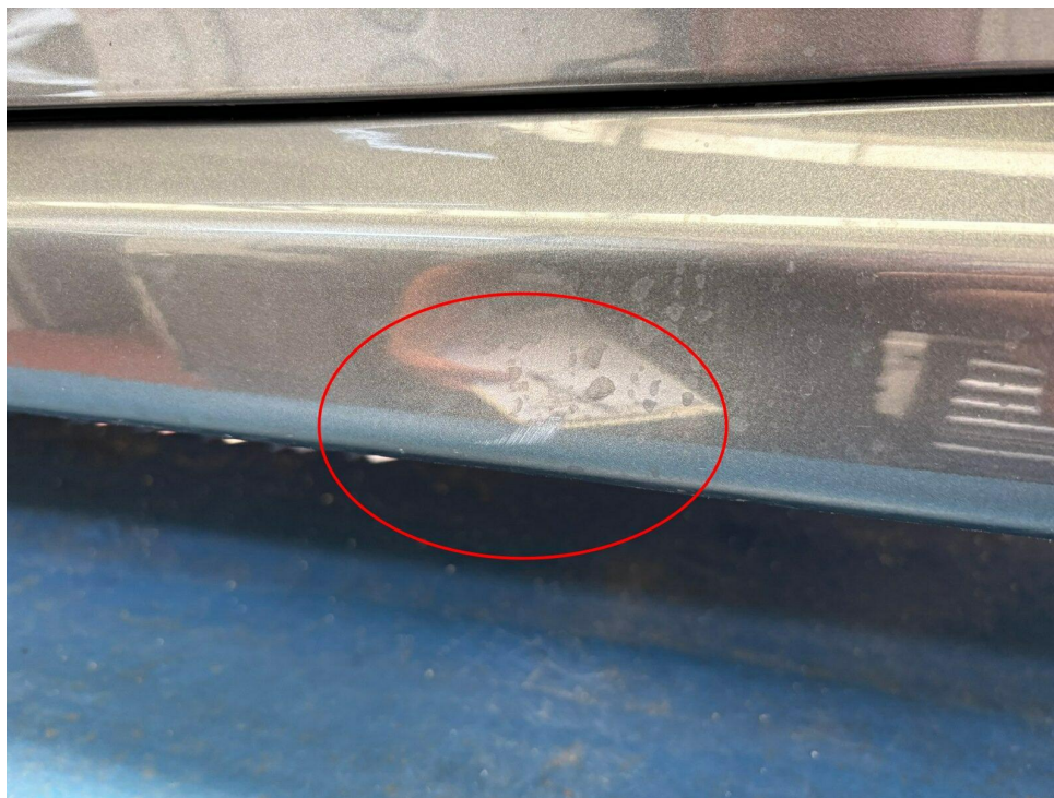
Bild 36 : Schweller links verschrammt
