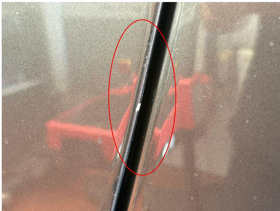
Bild 31 : Tür links mehrfach verschrammt
