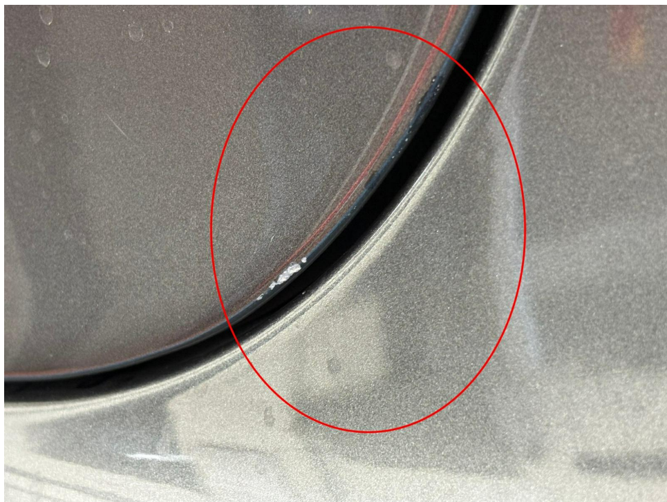
Bild 30 : Tür links mehrfach verschrammt
