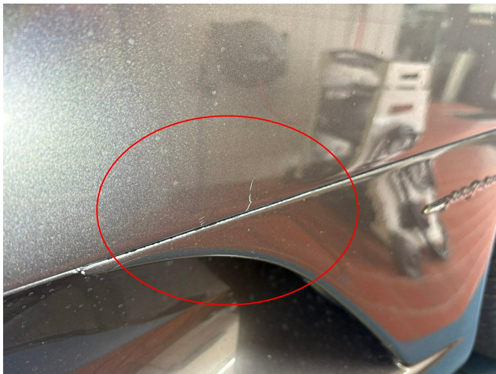
Bild 29 : Seitenteil links verschrammt
