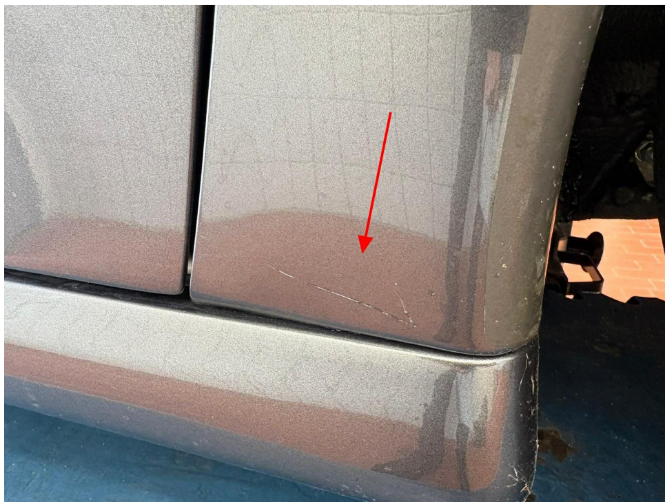
Bild 35 : Kotflügel rechts verschrammt
