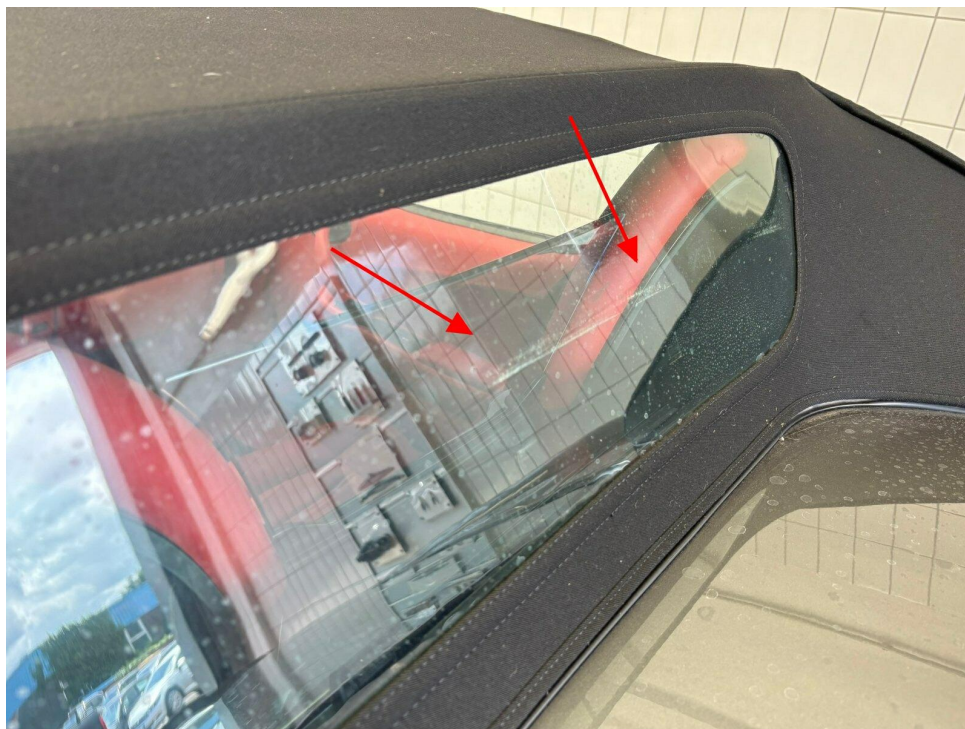
Bild 25 : Kunststoffscheibe hinten verschrammt
